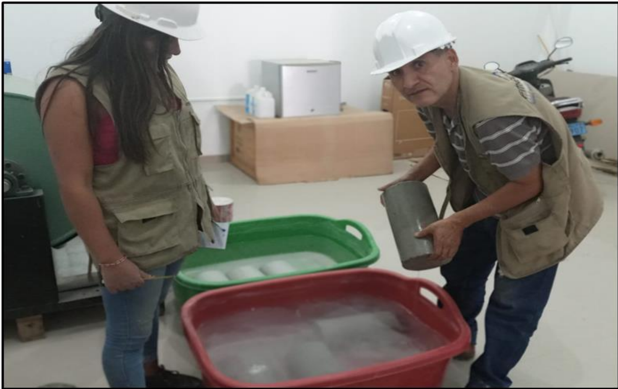
Figura 18. curado de especímenes de concreto
