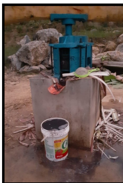
Figura 17 Extracción de resina de Requis de Plátano
