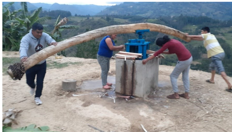
Figura 32 Colocación de Raquis para la extracción de la resina
