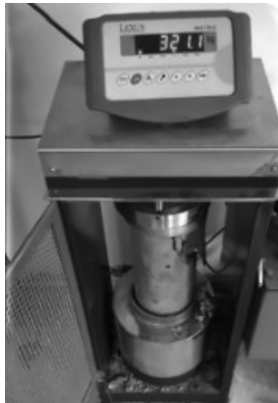
Figura 8 Ensayo de resistencia a la Compresión
