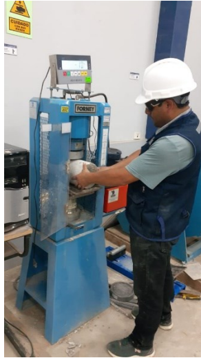
Foto 11. Ensayo de resistencia a la tracción
