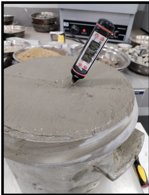
Figura 49 Ensayo de temperatura del concreto
