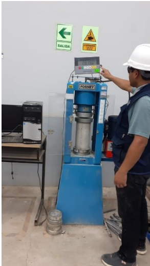
Foto 10. Ensayo de resistencia a la compresión
