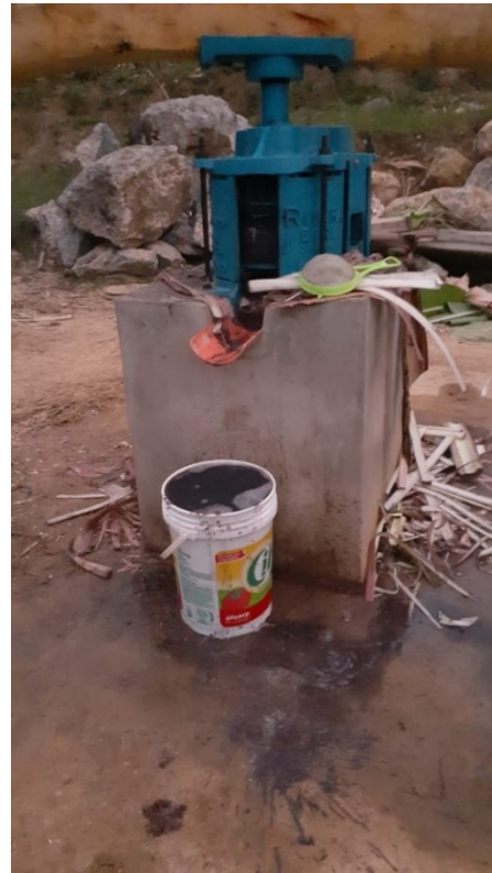
Figura 33 Maquina Extrayendo la Resina de Raquis de plátano
