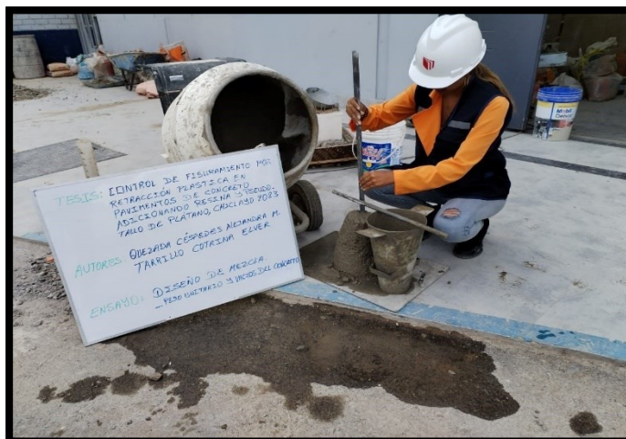
Figura 47 Ensayo de slump en laboratorio
