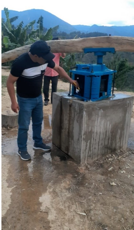
Figura 33 Maquina Extrayendo la Resina de Raquis de plátano
