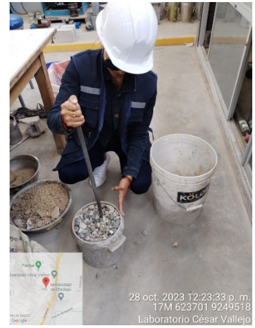
Foto 05. Peso unitario y vacíos del agregado grueso
