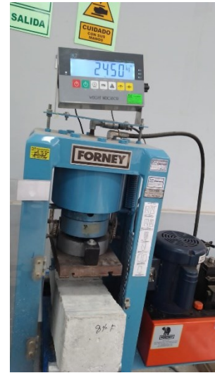
Foto 12. Ensayo de resistencia a la flexión
