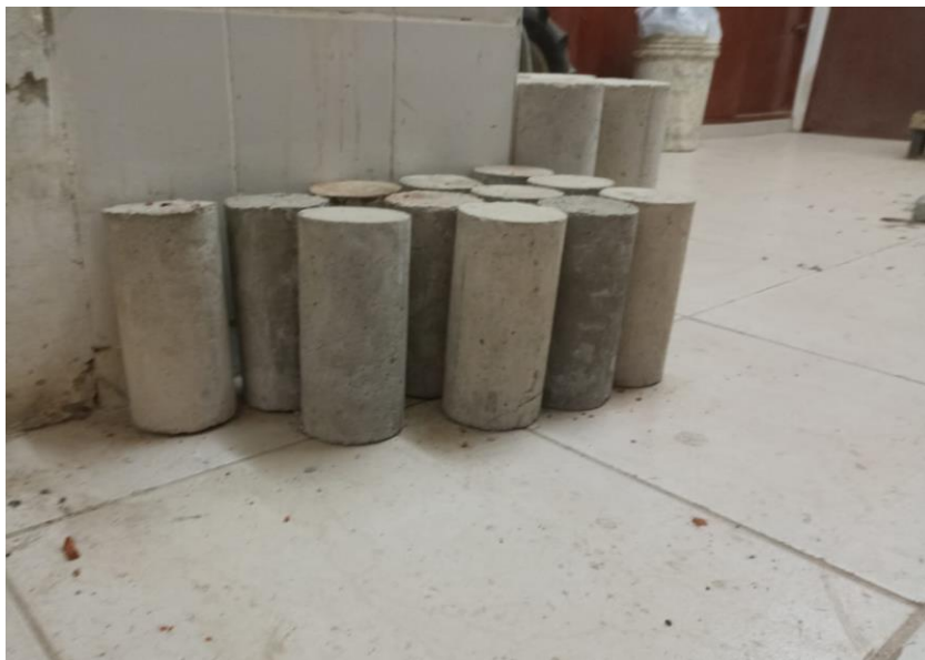
Figura 30: muestras de 10% 15% 20% 25% y del patron para el ensayo de resistencia a compresión
