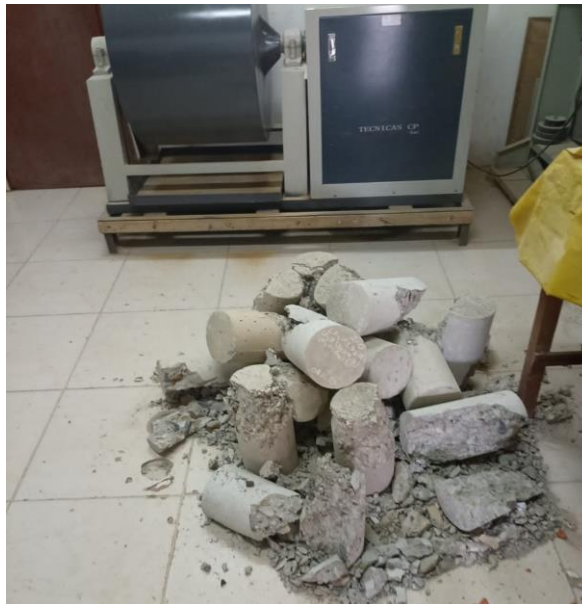
Figura 28-. Muestras del final de su proceso de ensayo a compresión
