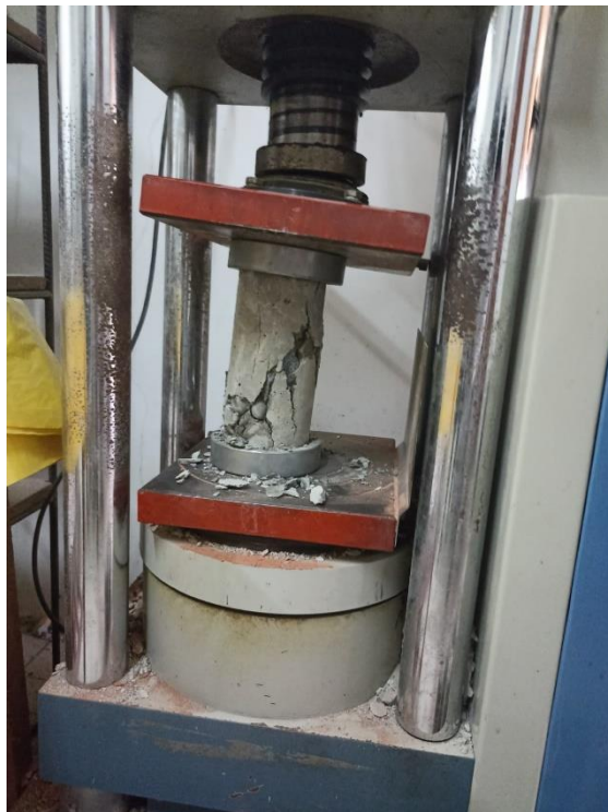
Figura 26: enayo de resistencia a compresion de dicha muestra
