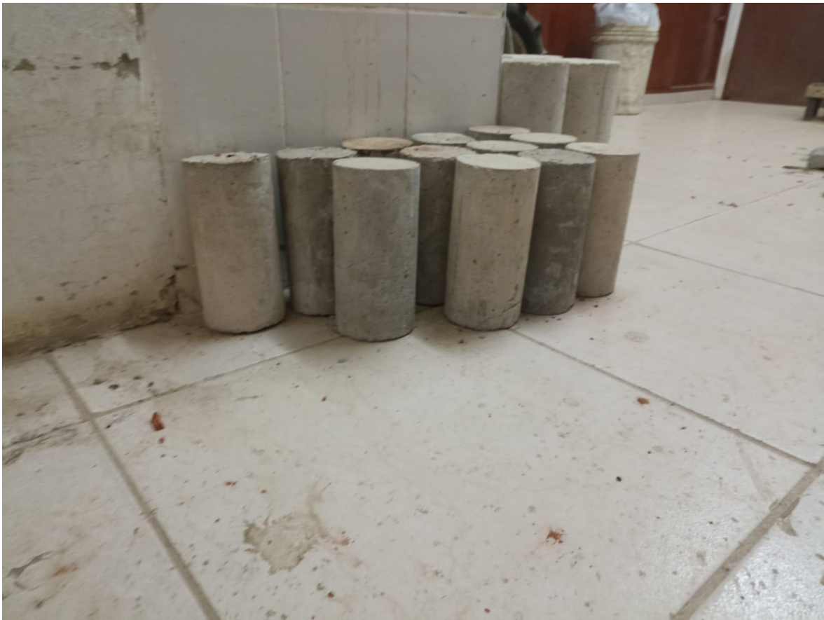
Figura 4. Diseño de mezcla para f'c=350 \text{ kg/cm}^2 con 10% de caucho reciclado
