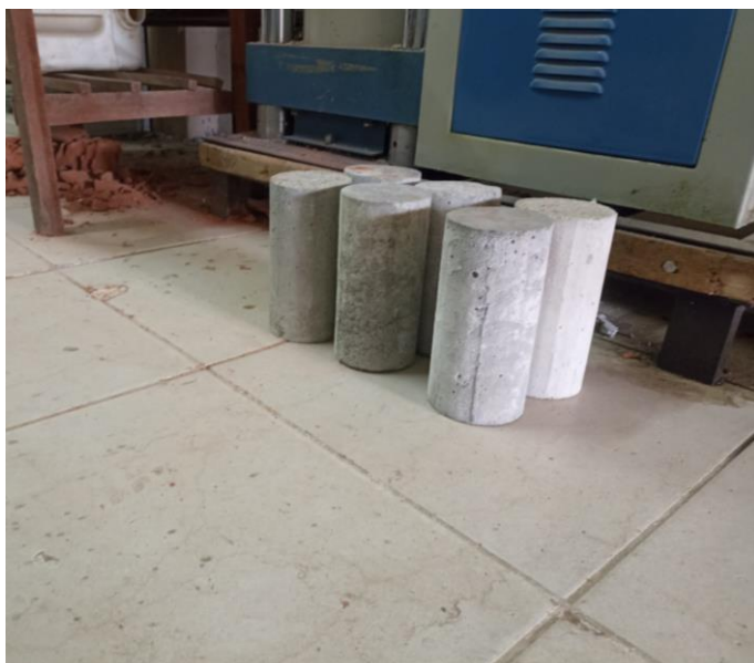
Figura 6. Diseño de mezcla para f'c=350 kg/cm 2 con 20% de caucho reciclado
