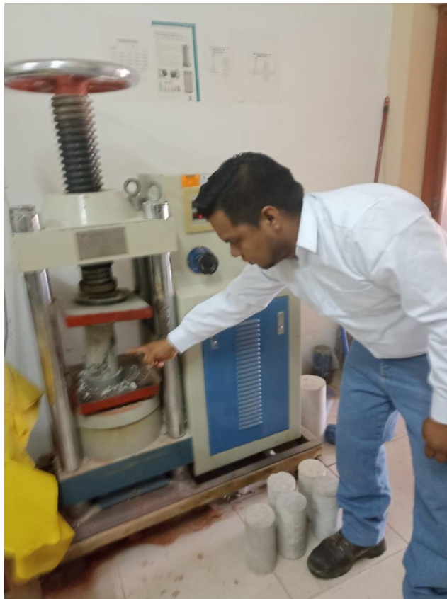
Figura 32- alumno en el proceso de ruptura en la resistencia a compresión
