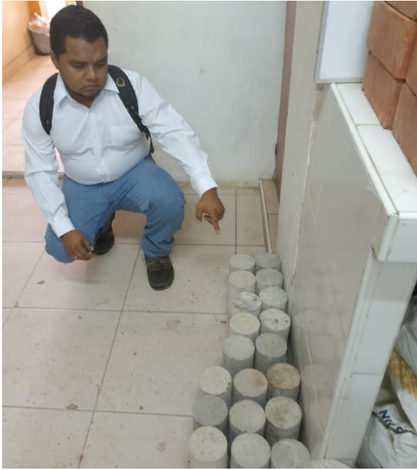
Figura 7. Diseño de mezcla para f'c=350 kg/cm 2 con 25% de caucho reciclado
