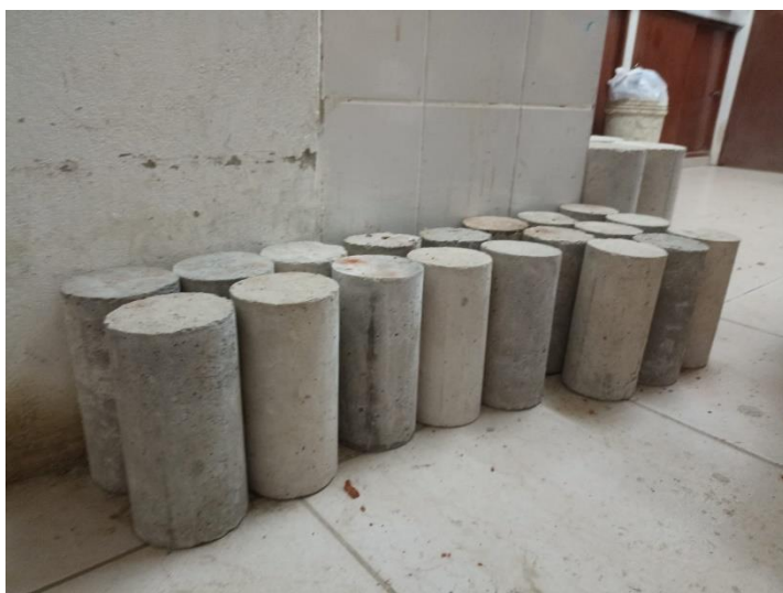
Figura 5. Diseño de mezcla para f'c=350 \text{ kg/cm}^2 con 15% de caucho reciclado
