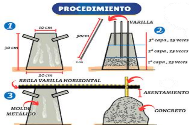
Figura 2: Prueba de asentamiento mediante cono de Abrams.
