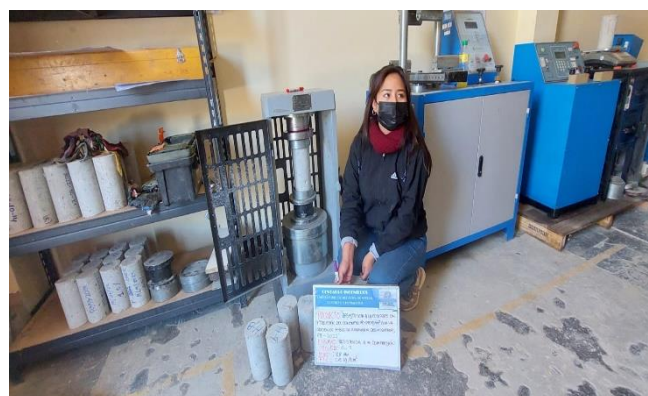
Figura 14: Rotura de probeta a la resistencia a la compresión a los 28 días.
