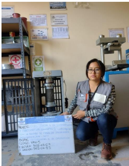
Figura 39: Ensayo de Resistencia a Compresión a los 14 días.
