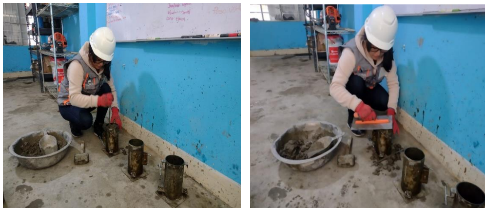
Figura 34: Peso y adición de fibra de zanahoria deshidratada.
