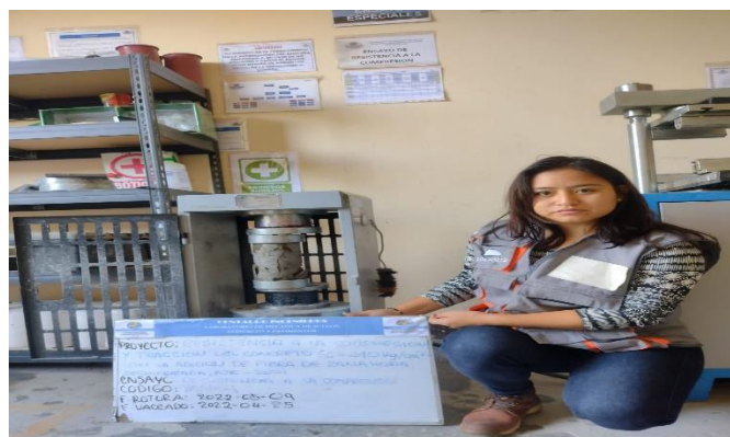
Figura 13: Rotura de la probeta resistencia a la compresión a los 14 días
