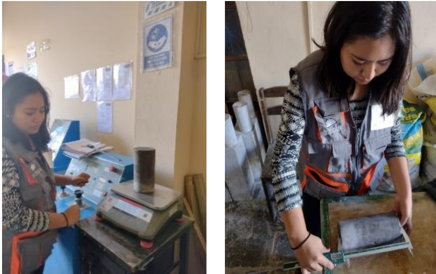
Figura 40: Peso y toma de dimensiones de la probeta.
