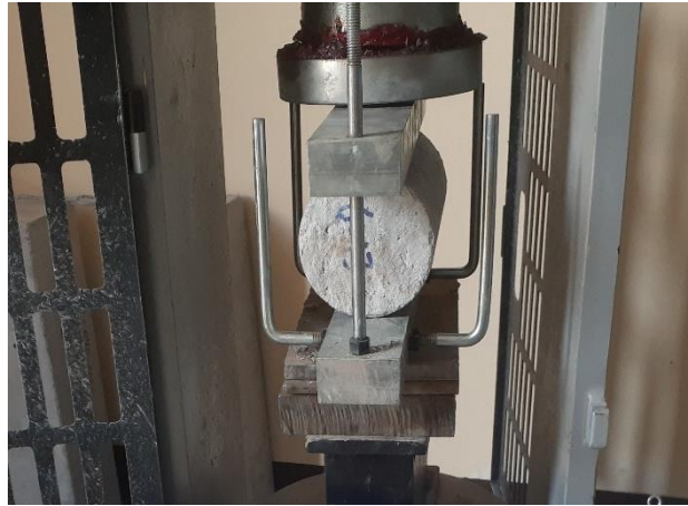
Figura 4: Ensayo a la tracción indirecta del concreto.
