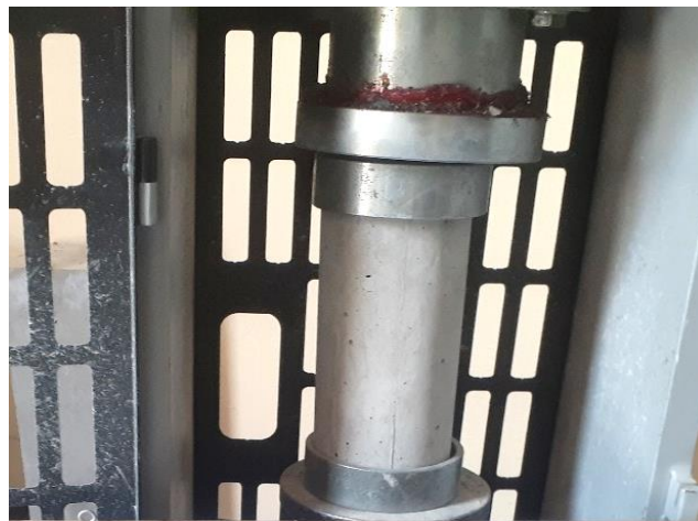
Figura 3: Ensayo de compresión del concreto.
