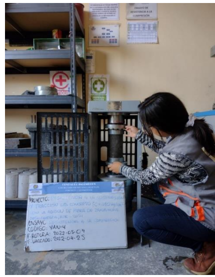
Figura 39: Ensayo de Resistencia a Compresión a los 14 días.
