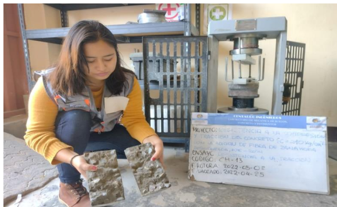
Figura 10: Retiro de probeta de poza de agua a los 7 días.
