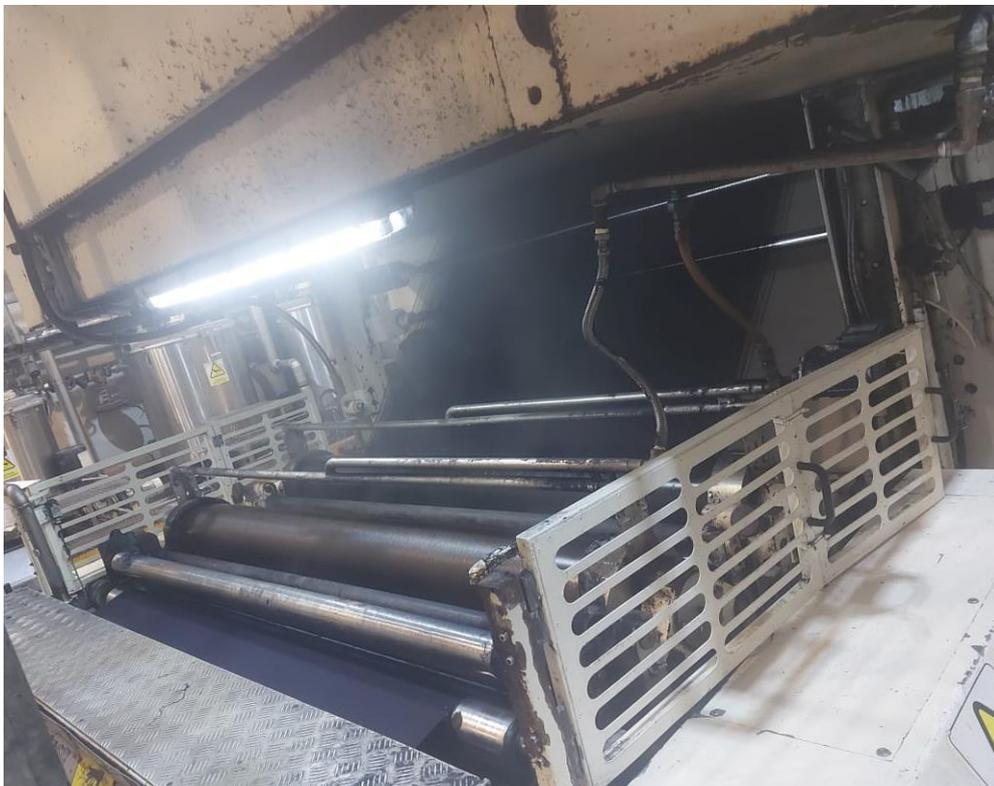
A continuación se muestra la figura N° 16. En los cual se muestra la torre de secado de los hilos debidamente teñido y engomado mediante los rodillos calentados a vapor con una temperatura de 80 grados.
