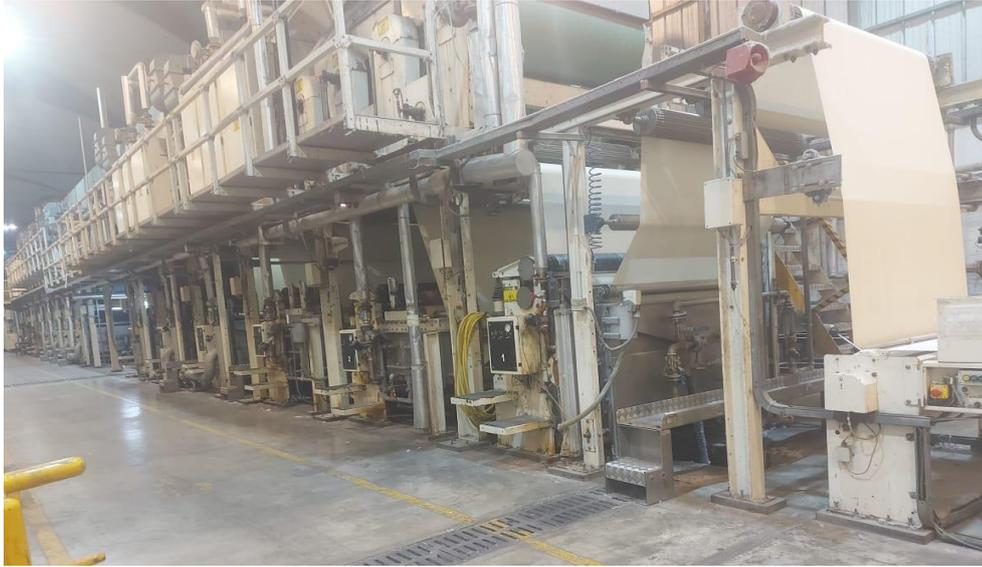
A continuación se muestra en la figura N°15, la zona de engomado de los hilos en madejas de la misma manera se realiza constante en el mantenimiento autónomos de limpieza de los rodillos de goma, para que no se queden pegados los hilos tejidos.
