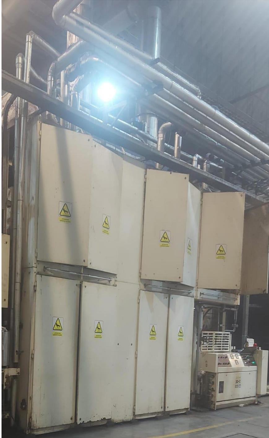
A continuación se muestra la figura N°17. Se muestra la parte de la zona del cabezal de la maquina en donde se realiza el bobinado de los hilos teñidos, engomados y debida mente peinado en un acho adecuado según la orden de producción, en estos plegadores se bobina 3600 metros de hilos teñidos en madejas. Asu vez como se ven en la figura N°18 se muestran ya los plegadores almacenados en la espera de ser trasladado al area de teneduría para ser tejidos ya en telas crudas.
