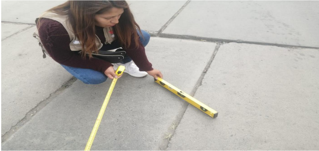
Figura 26: Falla de desnivel de carril o berma.
