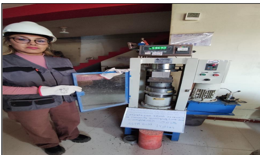
Figura 21: Resistencia a la compresión a 14 días.
