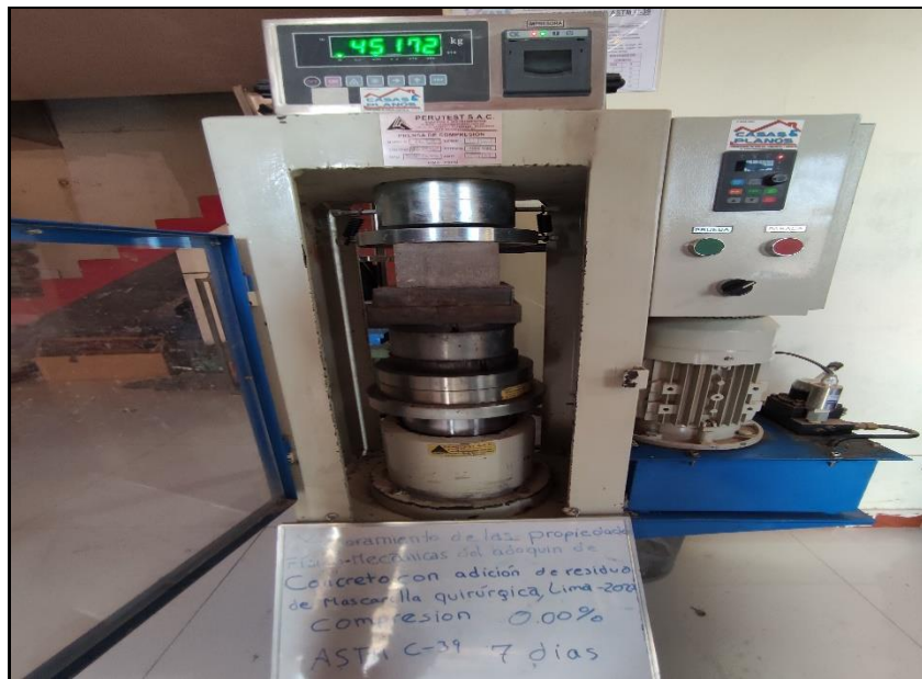
Figura 19: Resistencia a la compresión 7 días
