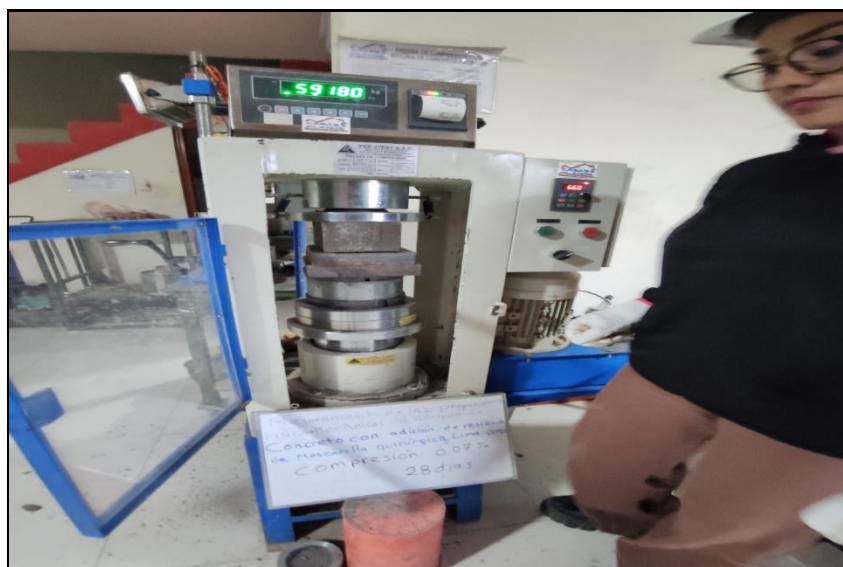
Figura 23: Resistencia a la compresión 28 días
