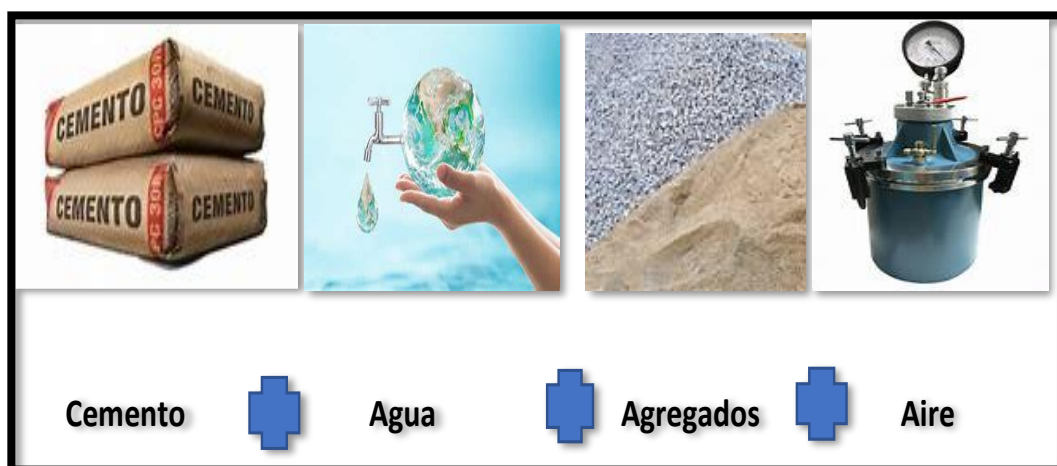
Figura 4: Componentes del adoquín de concreto
