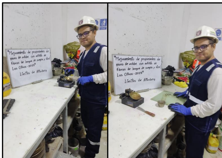
Figura 31. Límites de Atterberg-ensayo
