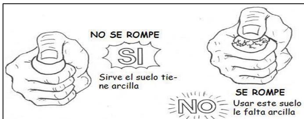
Figura 11. Ensayo de la bolita
