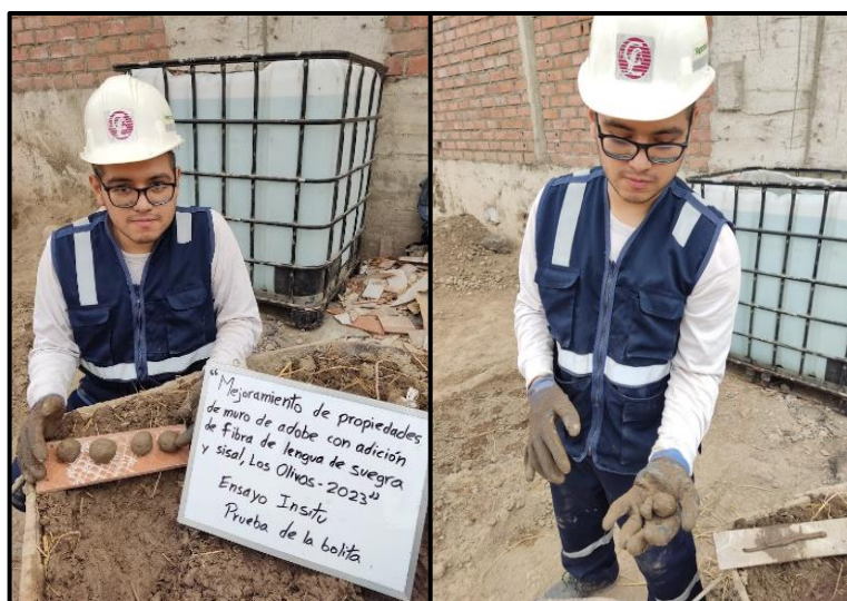
Figura 25. Prueba insitu de la bolita
