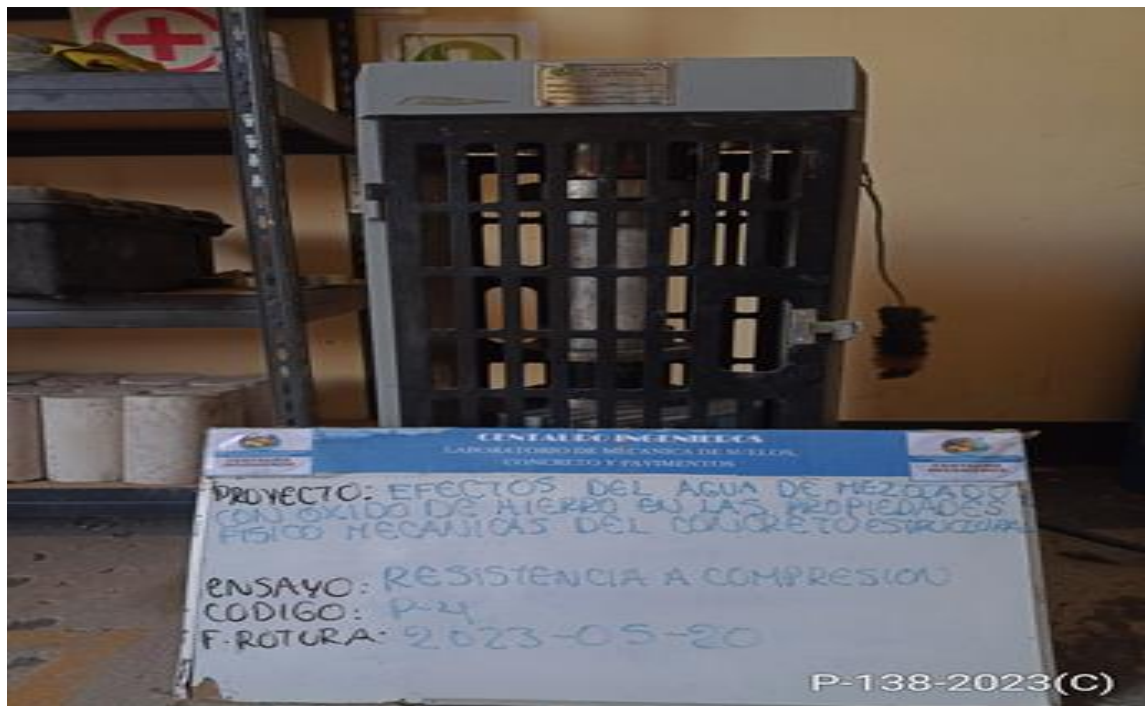
Descripción: Se observa la el ensayo de la resistencia a la compresión.
