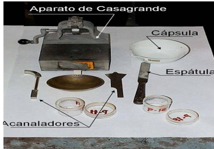
Figura 16 Equipo de laboratorio para Ensayo Liquido
