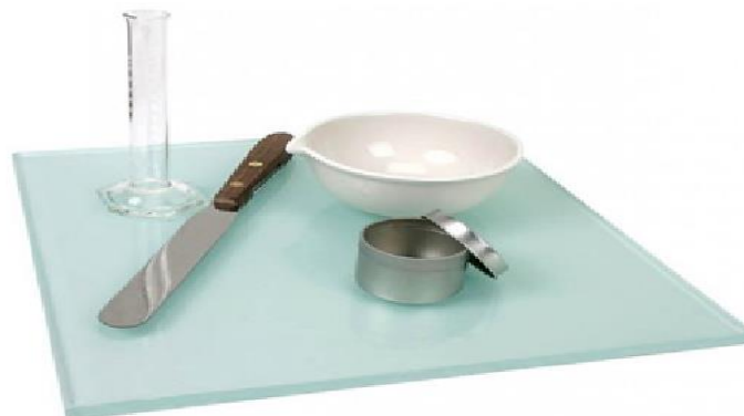
Figura 17 Equipo de Laboratorio para Limite Plástico
