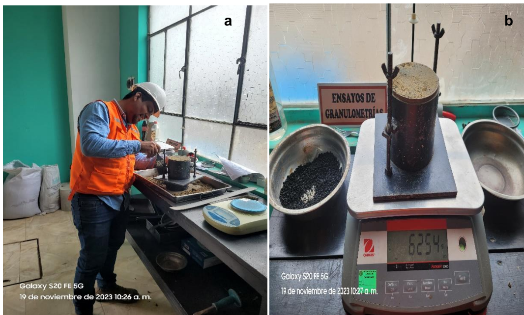
Nota: Fig. a. Nivelación de la muestra, Fig. b. Determinación del peso de la muestra + molde.
