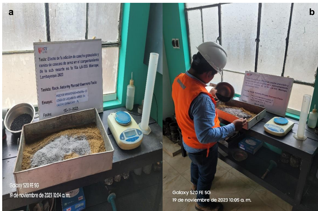
Nota: Fig. a. Pesado de las muestras de suelo natural, Caucho granulado y Ceniza de cascara de arroz, Fig. b. Combinación de las muestras de suelo + caucho + ceniza de cascara de arroz
