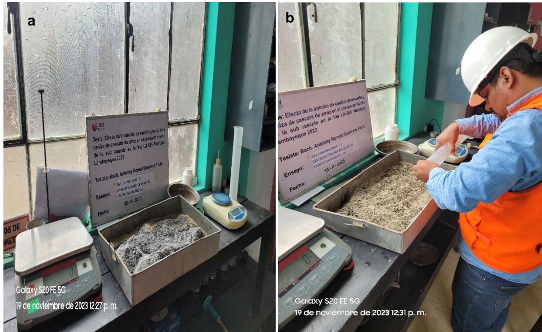
Nota: Fig. a. Combinación de las adiciones con el suelo natural Fig. b. Colocación del contenido de agua obtenido del ensayo Proctor Modificado.
