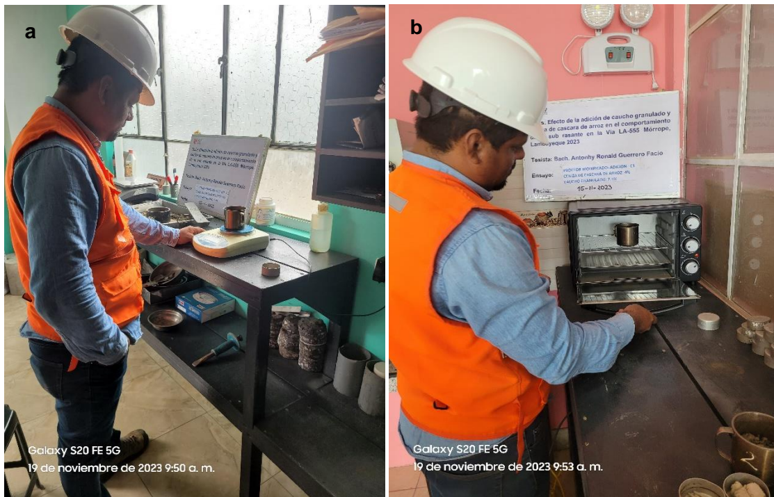
Nota: Fig. a. Extracción de material del Proctor para determinar humedad- peso de muestra, Fig. b. Muestra extraída colocada al horno
