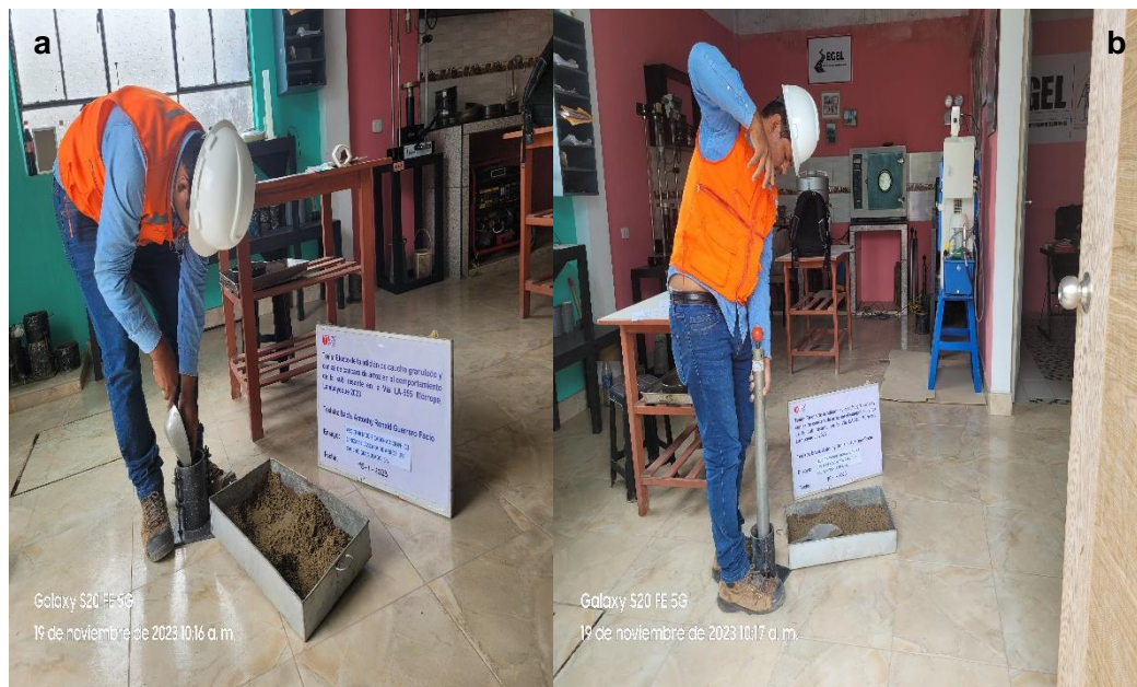
Nota: Fig. a. Colocación de las muestras en lo moldes de CBR método A, Fig. b. Aplicación de la Cargas en 3 capas.
