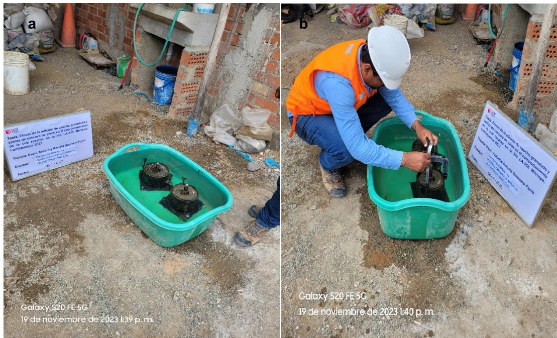
Nota: Fig. a. Colocación de las probetas de CBR a saturación Fig. Colocación de medidor de expansión.
