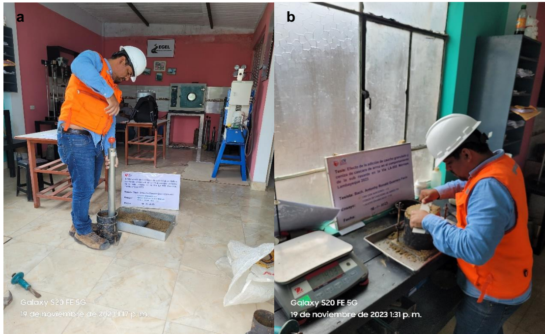
Nota: Fig. a. Compactación de la mezcla Fig. b. Nivelación de superficie y peso de molde + muestra.
