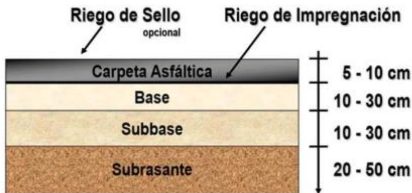
Figura 8 Estructura del Pavimento Flexible
