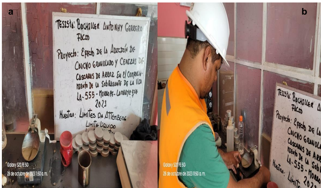
Nota: Fig. a. Preparación de lo copa de Casagrande para limite líquido, Fig. b. Aplicación de 25 golpes para cerrado de la junta.
