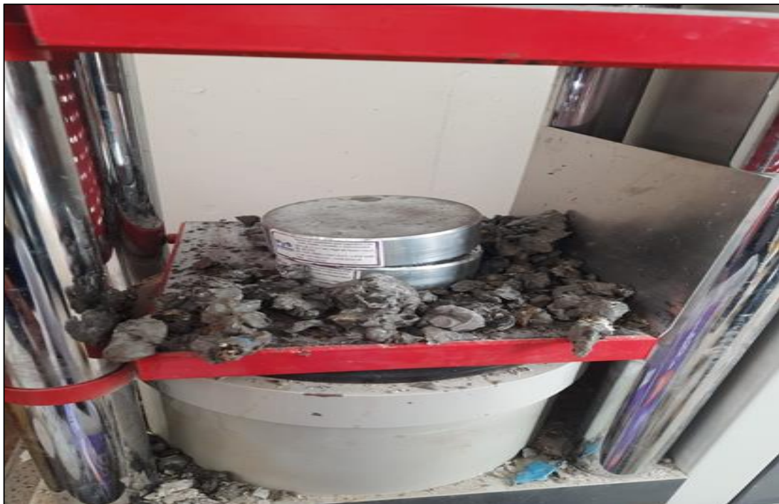
Fotografía 10. Ruptura del concreto a los 14 días
