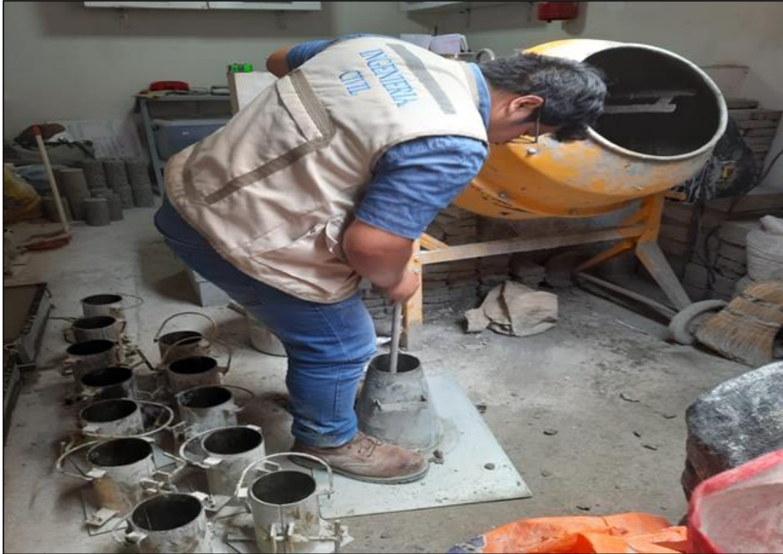
Fotografía 7. Proceso de chuceado de las probetas
