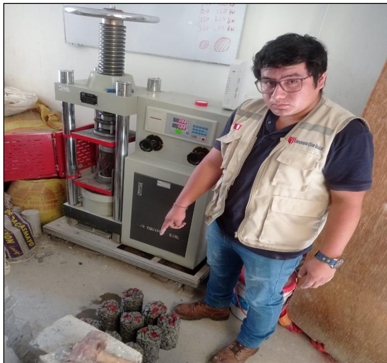
Fotografía 12. Ruptura del concreto a los 28 días
