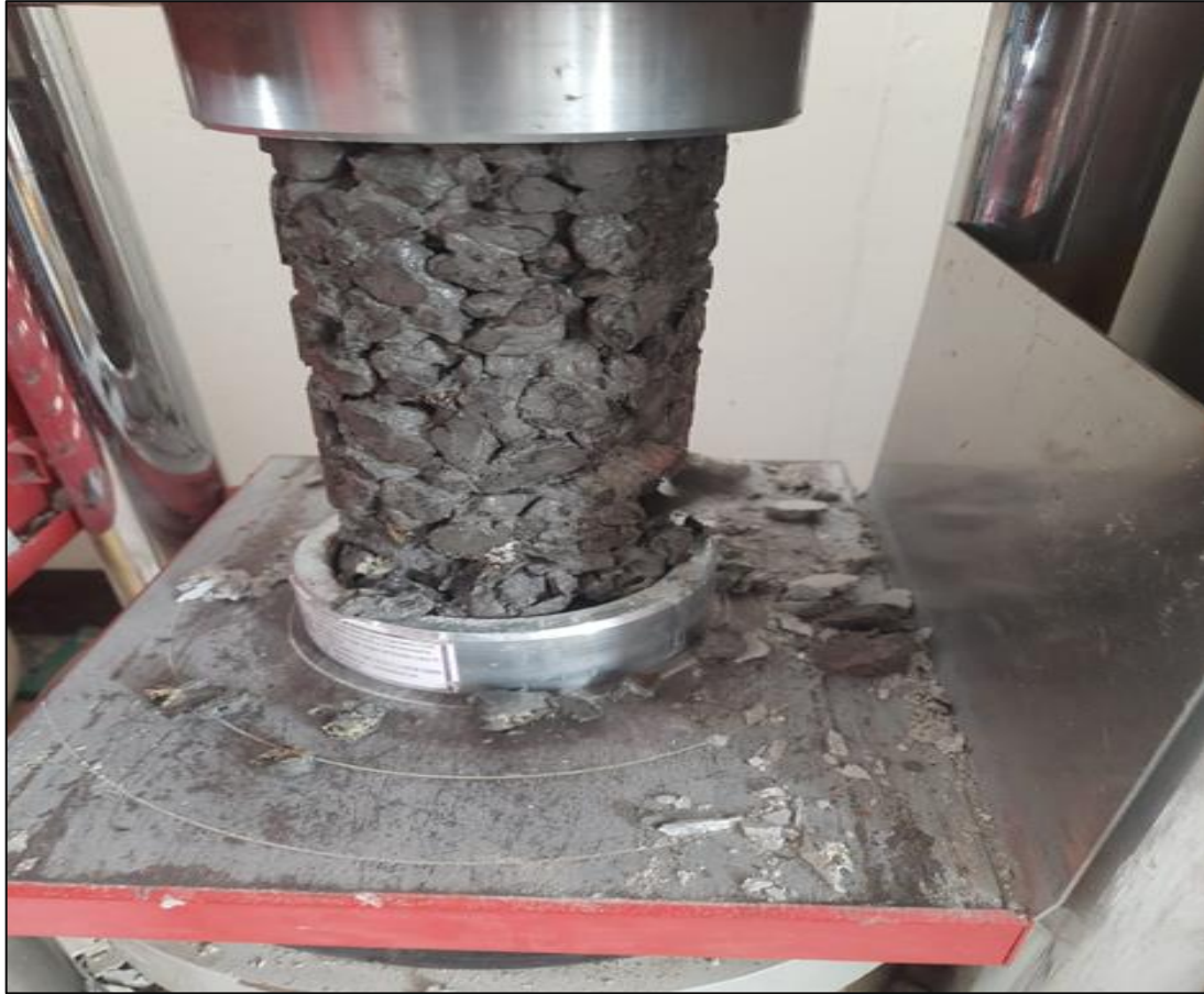
Fotografía 9. Ruptura del concreto a los 7 días
