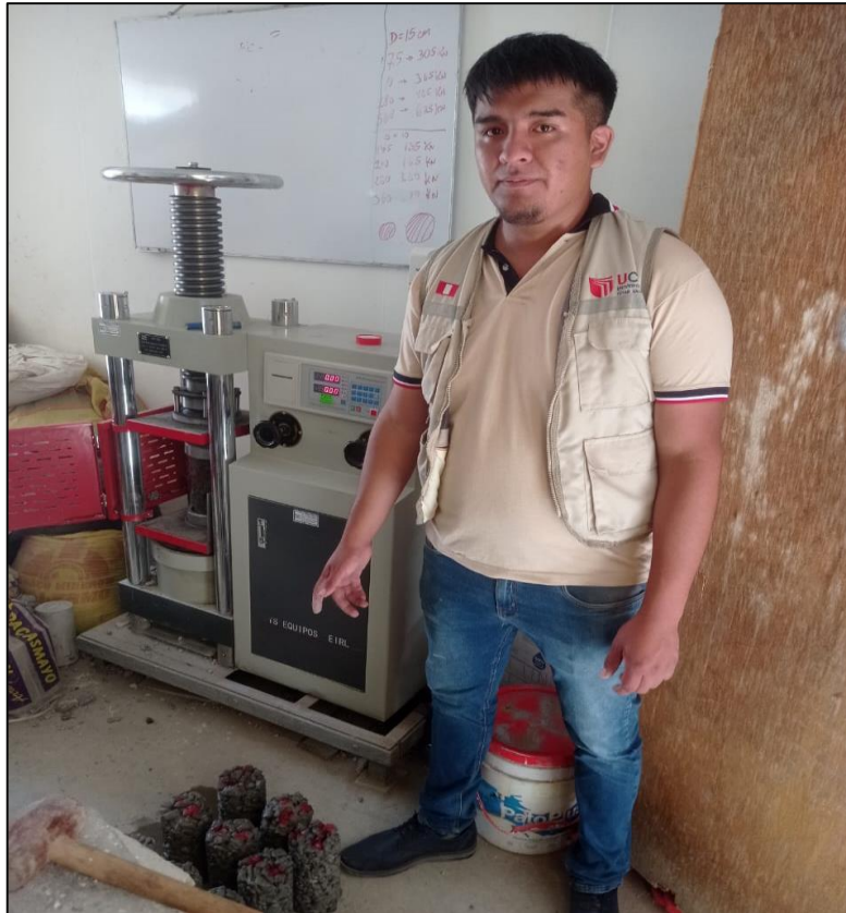
Fotografía 11. Ruptura del concreto a los 28 días
