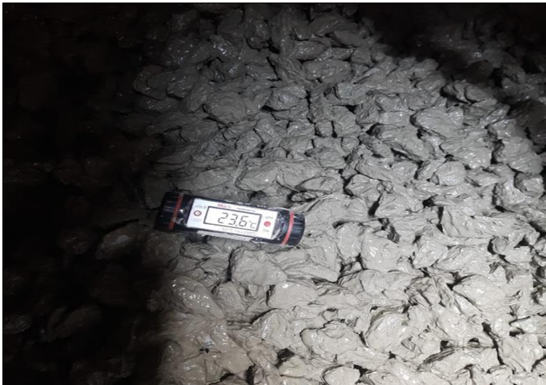
Fotografía 6. Medición de la temperatura de la mezcla
