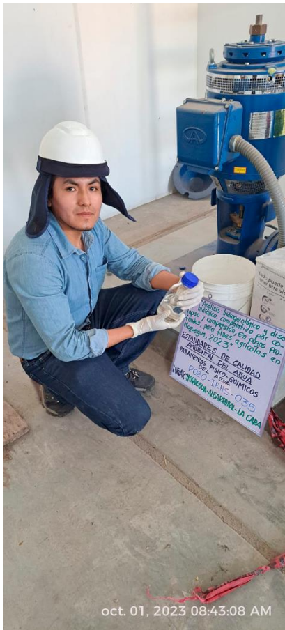
Toma de muestras de agua subterránea, en estación de bombeo POZO IRHS-035 – La Cara, para análisis físico químico.
