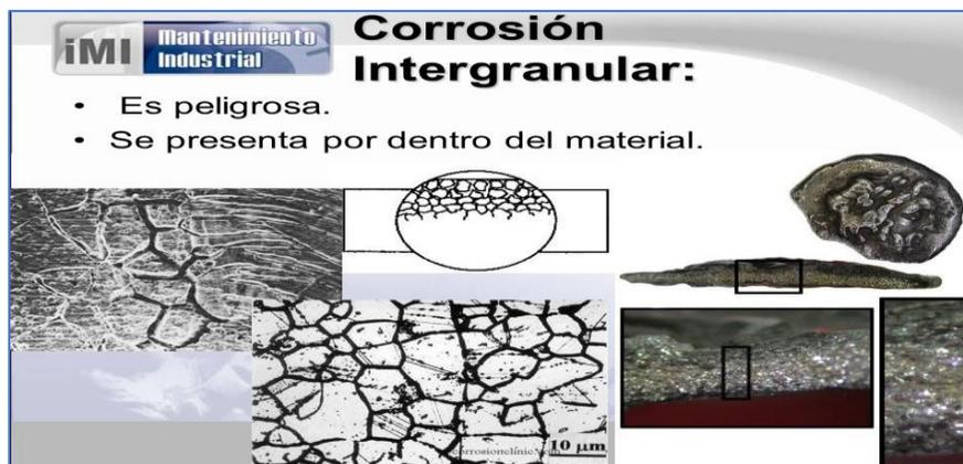
**Figura 6:** Corrosión Intergranular
