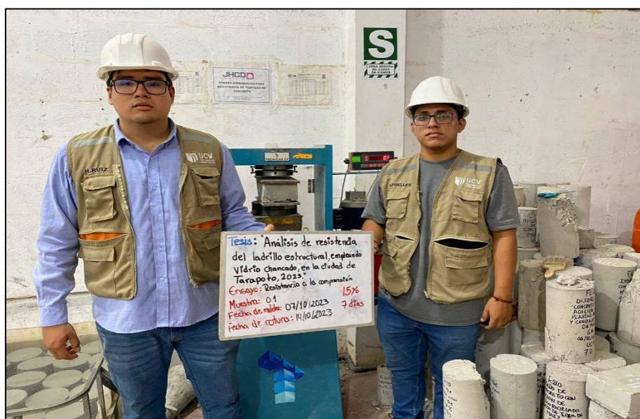
IMAGEN 12: Se observa el ensayo de resistencia a la compresión De los testigos de ladrillo estructural
