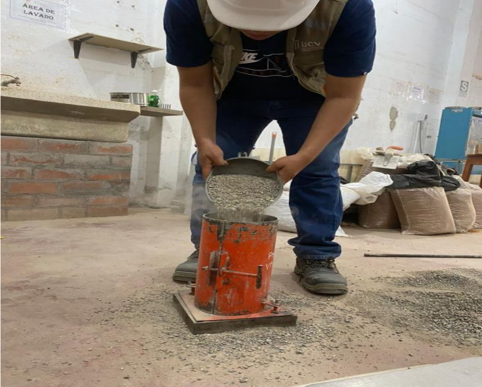
IMAGEN 05: SE OBSERVA EL ENSAYO DE PESO UNITARIO SUELTO - NTP 400.017
