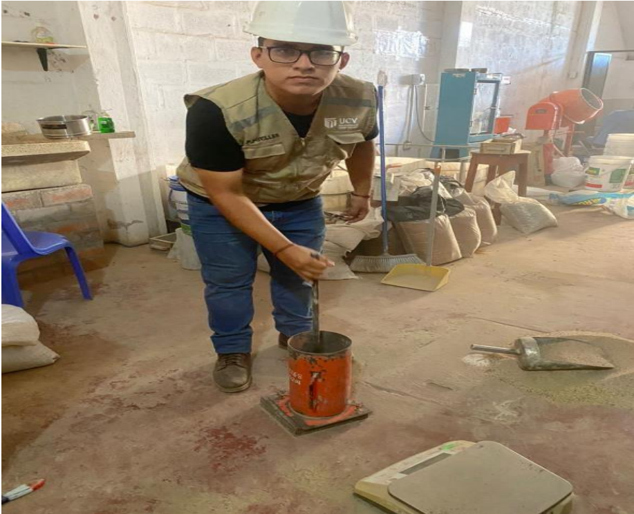
IMAGEN 06: SE OBSERVA EL ENSAYO DE PESO UNITARIO VARILLADO - NTP 400.017
