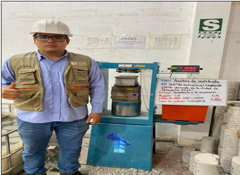
IMAGEN 11: Se observa el ensayo de resistencia a la compresión De los testigos de ladrillo estructural
