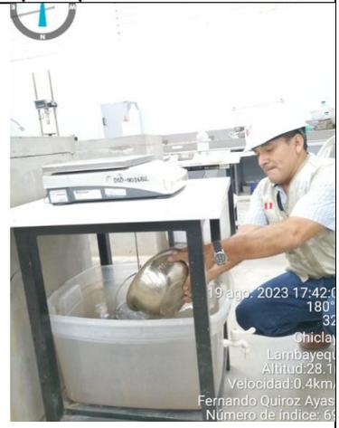
FOTO N°09: Colocación de agua en agregado
