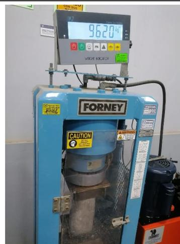
FOTO N°62: Resultados de ensayo de adherencia
