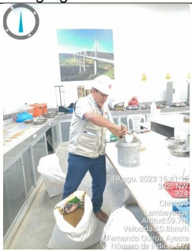
**FOTO N°17: Colocación de agregado fino para peso unitario**
