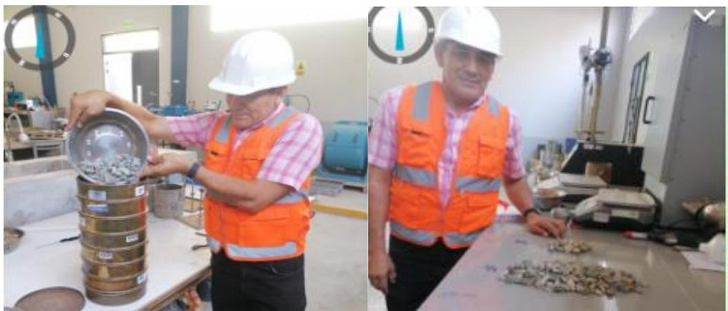
*Nota.* Se da en función al porcentaje retenido y al porcentaje que pasa del Tamizado Ensayo de piedra chancada en el laboratorio de mecánica de suelos y materiales de la UCV
