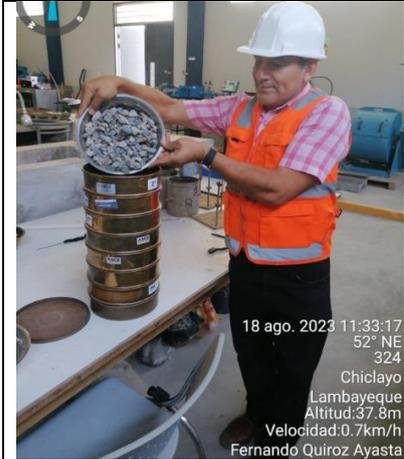
FOTO N°04: Tamizado de agregado
