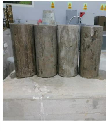
FOTO N°50: Probetas fisuradas del ensayo de resistencia a la compresión
