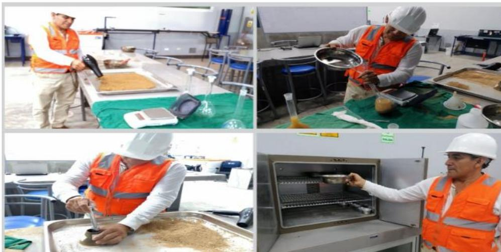
*Nota.* Se observa el secado de la arena, comprobación cono de Abrams, colocación de la rena en la fiola, y secado de muestra.
