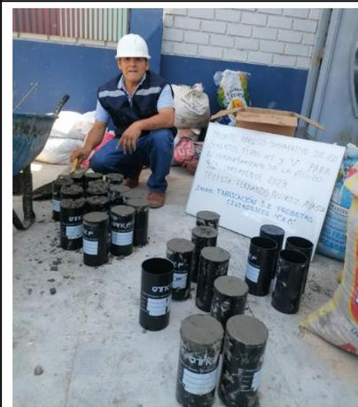
FOTO N°43: Elaboración de probetas de concreto
