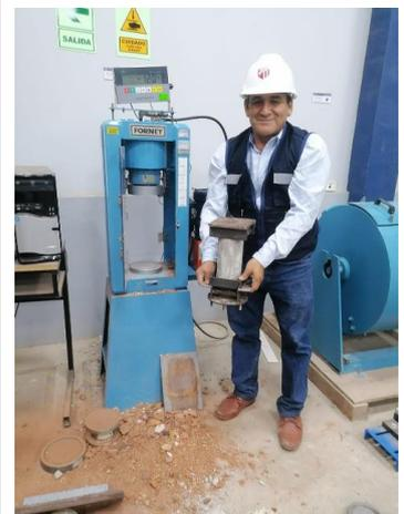
FOTO N°60: Colocación de probeta en máquina
