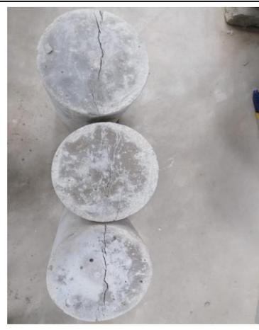
FOTO N°42: Fisura en probetas en eje de diámetro
