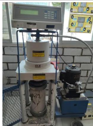
FOTO N°56: Ensayo de compresión para 40% $f_c$
