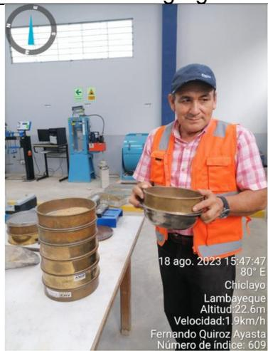
**FOTO N°14: Tamizado de agregado fino**
