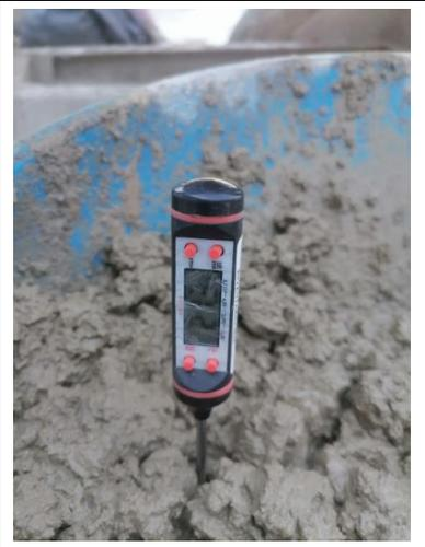
FOTO N°33: Medición de temperatura del concreto
