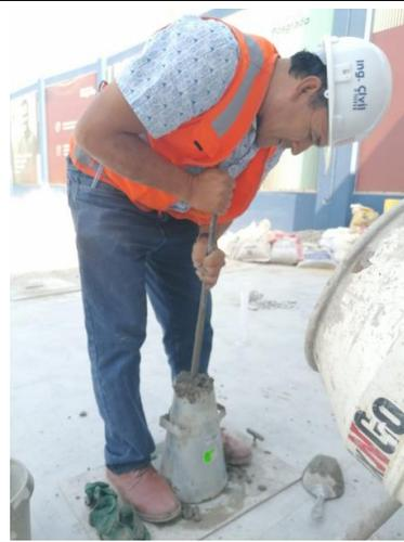
FOTO N°31: Varillado de mezcla de concreto en cono de Abrahams
