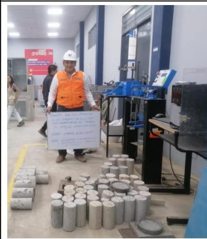
FOTO N°40: Secado de probetas previa a rotura
