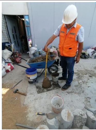
FOTO N°32: Medición de slum (asentamiento del concreto)
