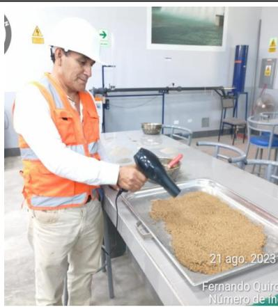
FOTO N°20: Secado de agregado fino
