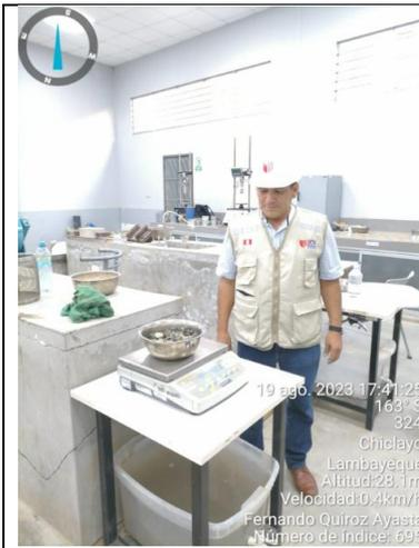
**FOTO N°10: Peso de muestra de agregado**
