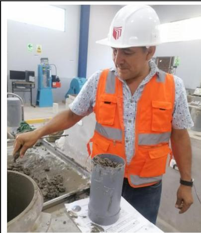
FOTO N°37: Varillado de segunda capa de concreto en molde
