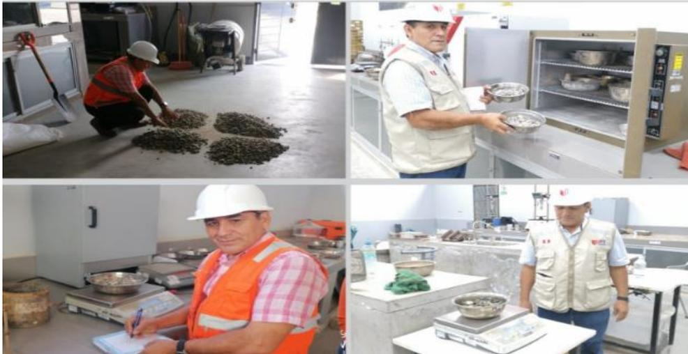
*Nota.* Ensayos de peso específico en laboratorio
