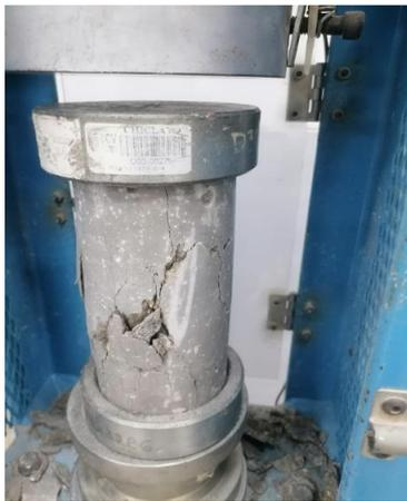
FOTO N°49: Probeta fisurada tipo 3 por compresión
