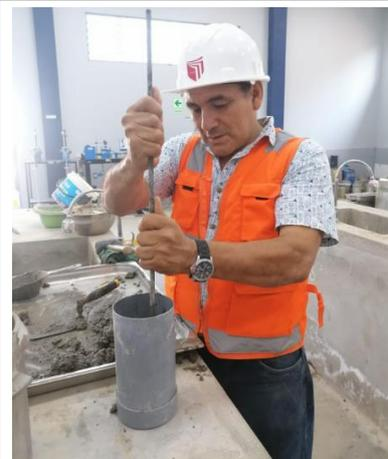
FOTO N°36: Varillado de primera capa de concreto en molde
