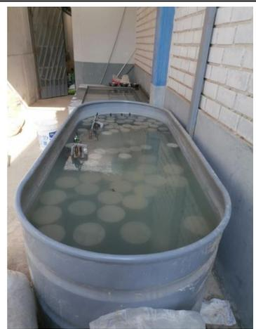
FOTO N°39: Curado de probetas de concreto
