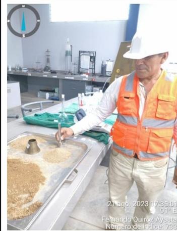
FOTO N°22: Muestra de agregado fino sss
