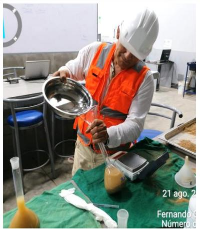
FOTO N°23: Colocación del agua en la fiola con agregado fino
