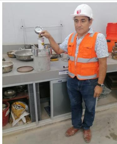
FOTO N°35: Contenido de aire del concreto
