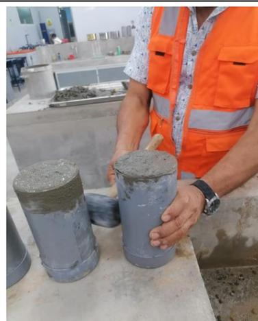
FOTO N°38: Probeta de concreto terminada
