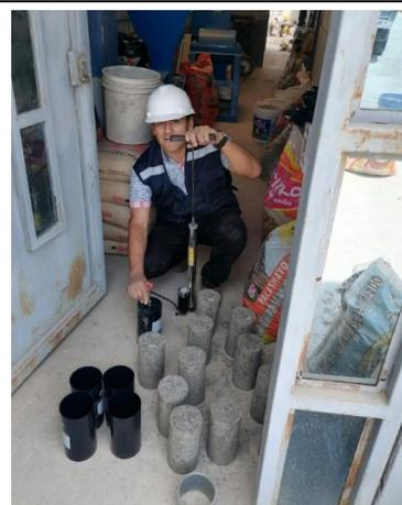
FOTO N°45: Desencofrado de probeta de concreto
