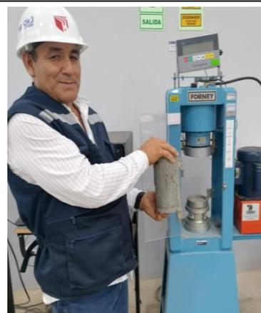
FOTO N°47: Colocación de probeta en máquina de rotura
