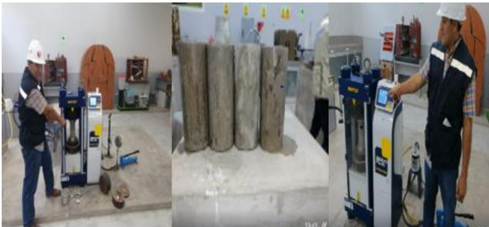
*Nota.* Rotura de probetas en laboratorio de mecánica de suelos y materiales de la UCV., de fuente propia, 2023.
