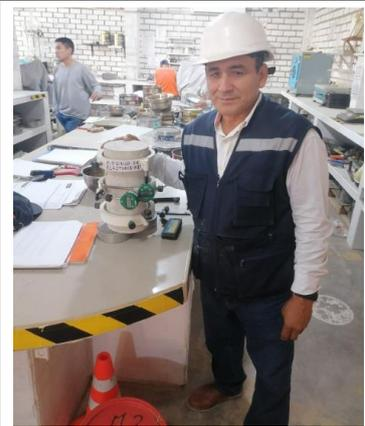
FOTO N°57: Colocación de abrazadera en probeta de concreto
