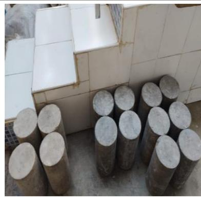
FOTO N°55: Probetas para ensayo de módulo de elasticidad
