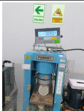
FOTO N°41: Ensayo de resistencia a la tracción de probetas de concreto
