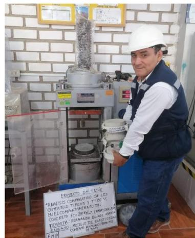
FOTO N°58: Colocación de probeta en máquina
