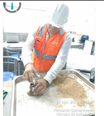
FOTO N°21: Compactación de agregado fino en el cono
