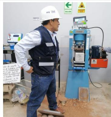
FOTO N°53: Ensayo de resistencia a flexión de vigas
