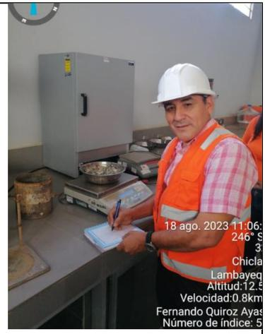
FOTO N°03: Pesado de agregado para tamizado
