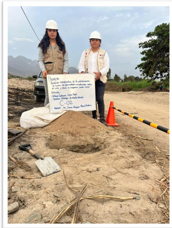
Excavación para obtener muestras en la C-02
