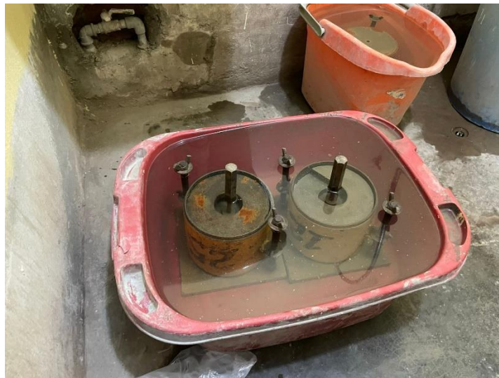
Figura: saturación de muestras en moldes para CBR
