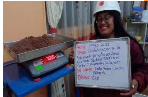
Peso del suelo de la muestra, utilizado para el ensayo de CBR
