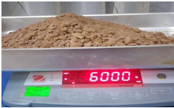
Peso de muestras de nuestro suelo para el ensayo del Proctor modificado
