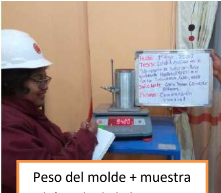
Peso del molde + muestra húmeda para el ensayo de compresión uniaxial
