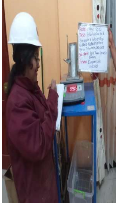
Peso del molde + muestra húmeda para el ensayo de compresión uniaxial
