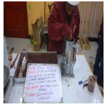
Ensayo de compresión uniaxial muestra de suelo más Pet
