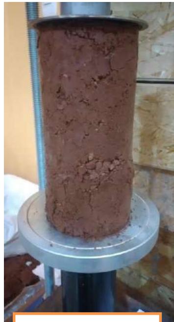
Briqueta después de la falla
