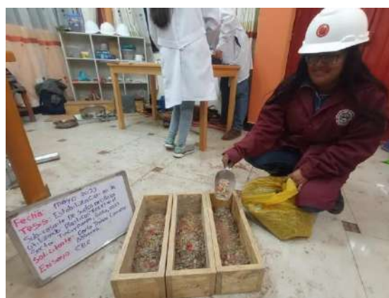
Muestras de Pet pesadas al 2%, 4%, 6%. Para el ensayo CBR
