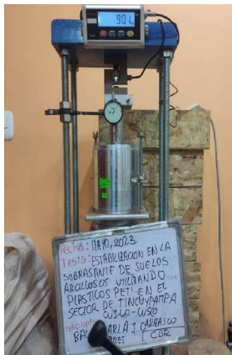
Ensayo de penetración con el 4% de Pet – calicata N°2
