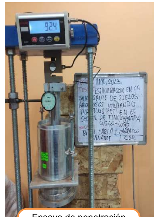
Ensayo de penetración con el 6% de Pet – calicata N°2
