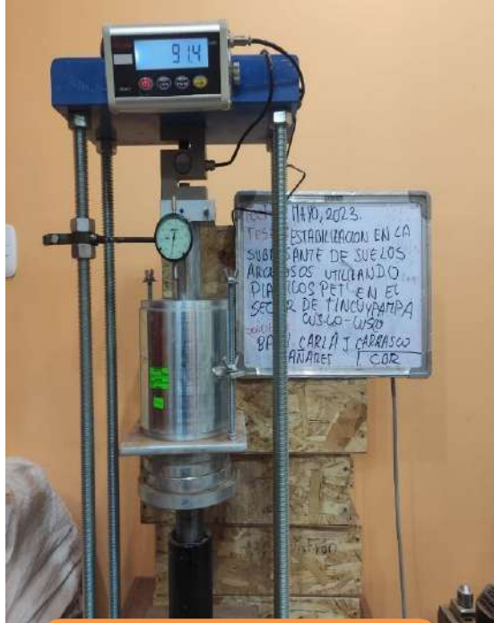
Ensayo de penetración con el 2% de Pet – calicata N°1
