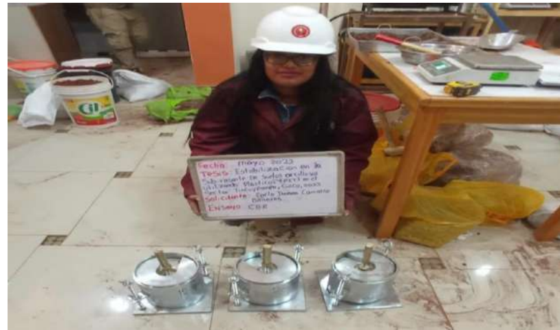
Ensayo del CBR, listo para la saturación
