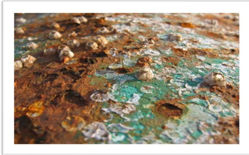
**Corrosión Electroquímica.** Es un proceso automático no reversible el cual se genera en reacciones simultáneas de oxidación y reducción, para que se produzca este fenómeno se requiere un medio de zona anódica (zona oxidada), zona catódica (zona de disminución) y un electrolito. Según Compañía Global de Pinturas (Galindo, 2020)
