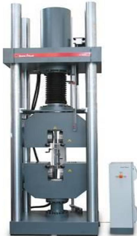
Las varillas se enumeran como se muestra en las tablas, luego se procede a medir y pesar para estimar la pérdida de masa en comparación con el peso de las varillas en perfecto estado. Para comprender la variación del alargamiento final en base a 3 diámetros, se realizan marcas distanciadas 50 mm con el objeto facilitar el cálculo de elongación del acero una vez producida la rotura.
