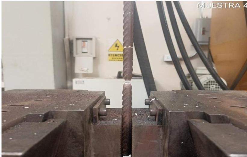
Una vez terminada con los ensayos a tracción de las barras, se obtienen los datos y se procede a realizar los diagramas de tensión-deformación ( $\sigma$ - $\epsilon$ ), para determinar las características mecánicas, obteniendo valores:
