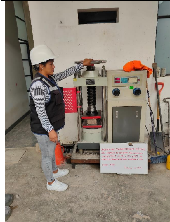
Figura 25: Ensayo de compresión a los 14 días de los ladrillos con 5% de ceniza.
