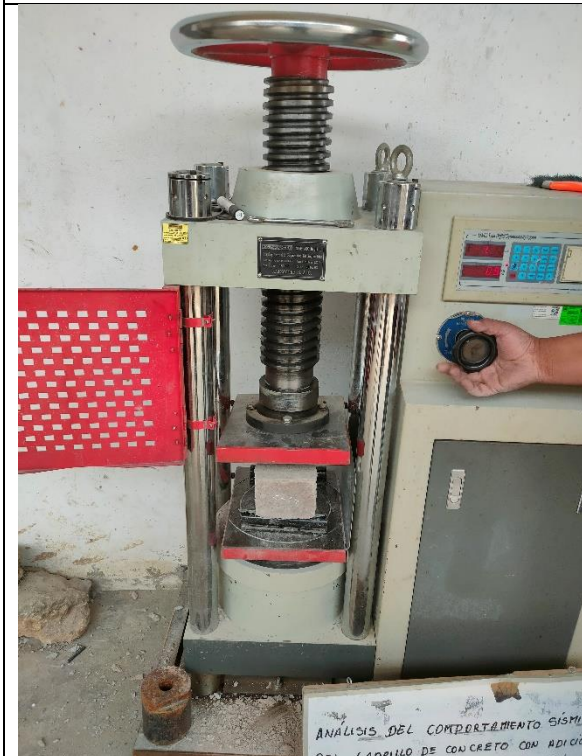
Figura 23: Ensayo a flexion a los 7 dias del ladrillo con adicon de 15% de ceniza.
