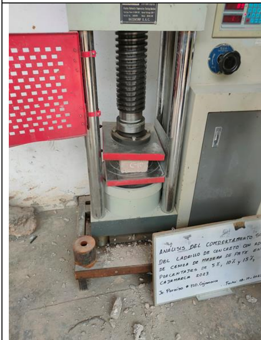
Figura 19: Ensayo a compresión a los 7 días del ladrillo con adición de 10% de ceniza.
