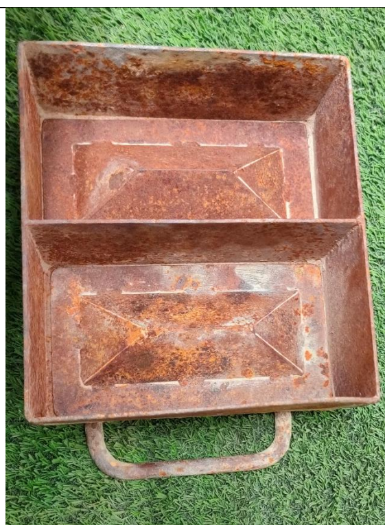
Figura 12: Molde para la elaboración de ladrillos.
