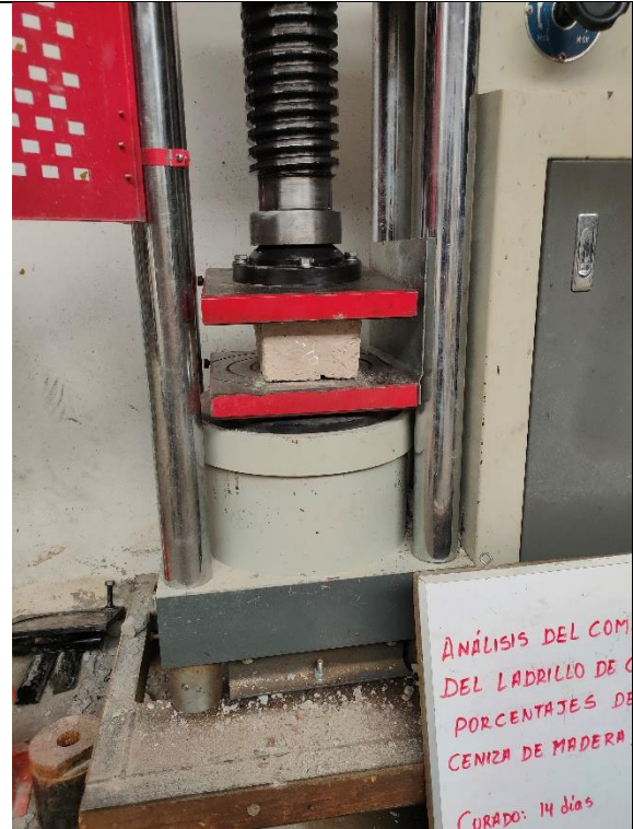
Figura 26: Ensayo de compresión a los 14 días de los ladrillos con 10% de ceniza.
