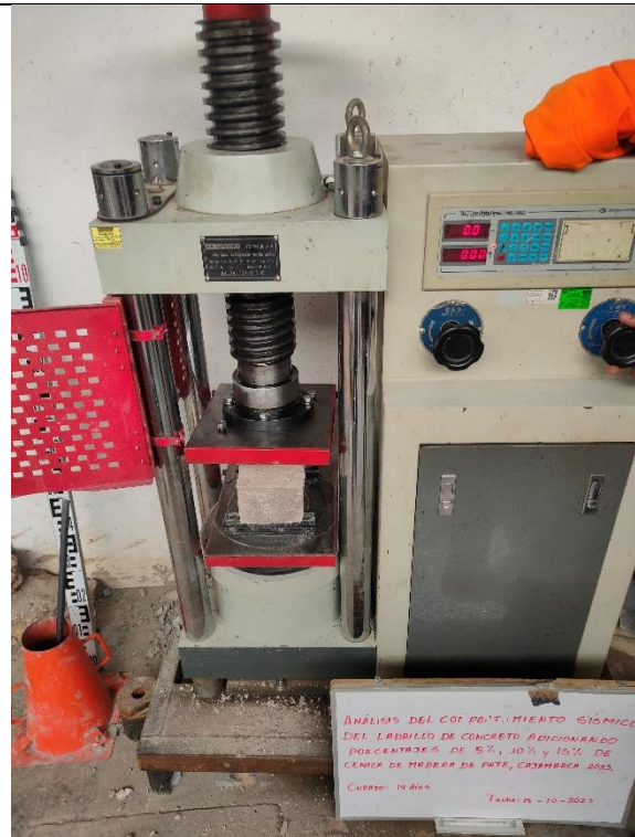
Figura 29: Ensayo de flexión a los 14 días de los ladrillos con 10% de ceniza.
