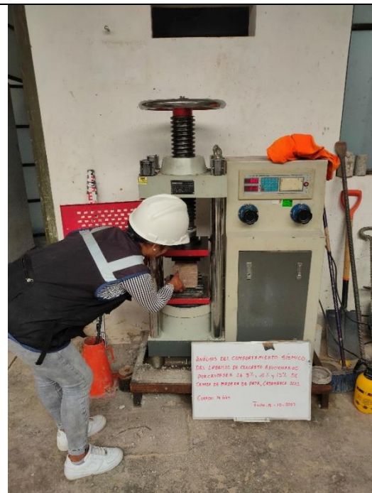
Figura 26: Ensayo de compresión a los 14 días de los ladrillos con 10% de ceniza.
