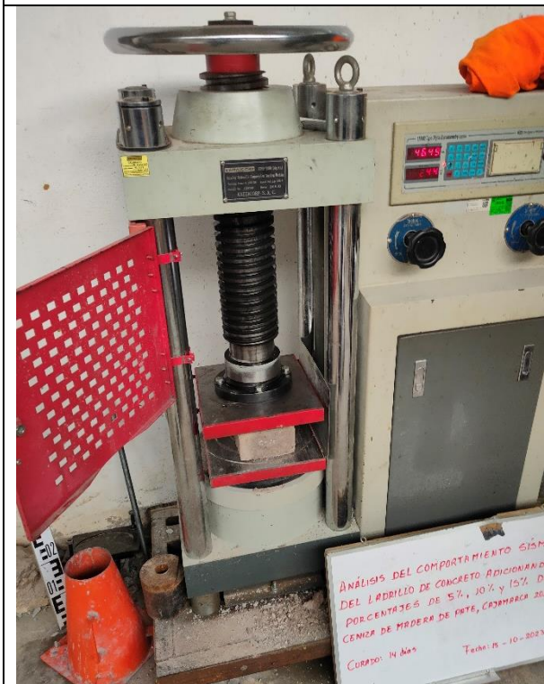
Figura 25: Ensayo de compresión a los 14 días de los ladrillos con 5% de ceniza.
