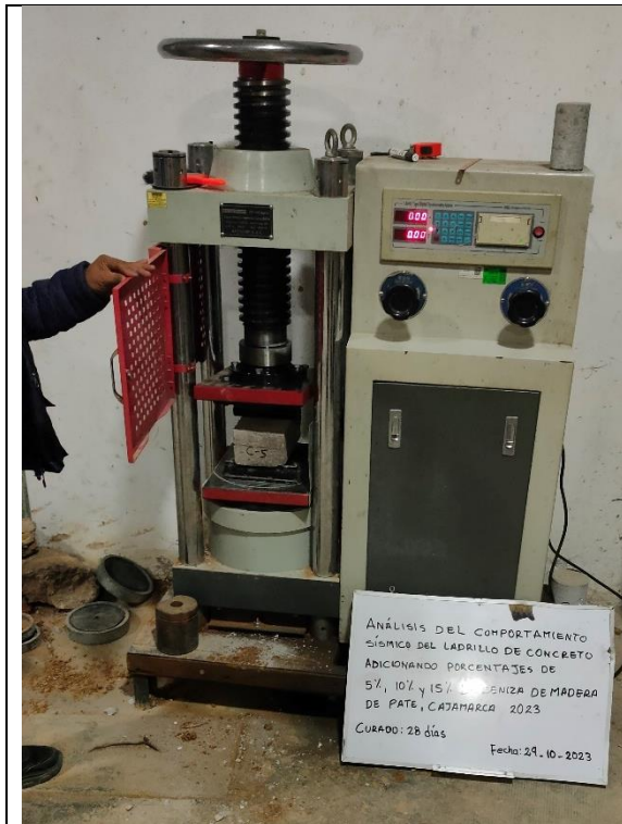
Figura 31: Ensayo a compresión de los ladrillos con 5% de ceniza a los 28 días.
