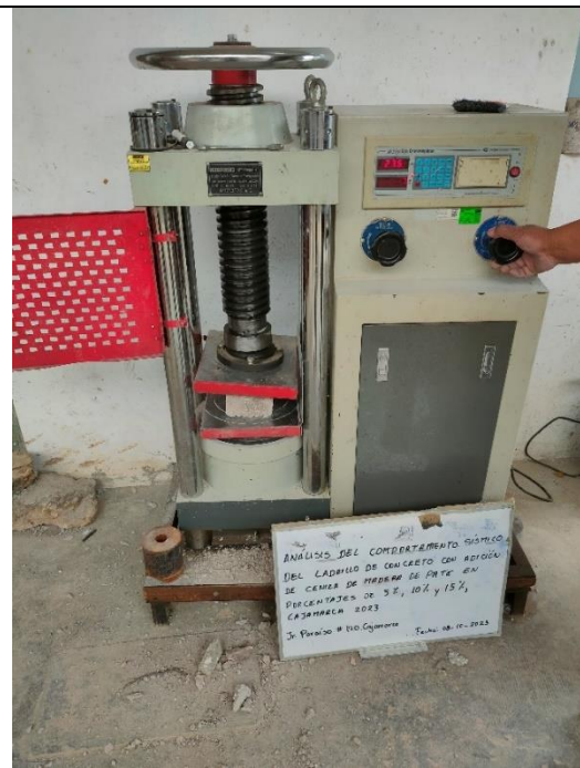
Figura 20: Ensayo a compresión a los 7 días del ladrillo con adición de 15% de ceniza.
