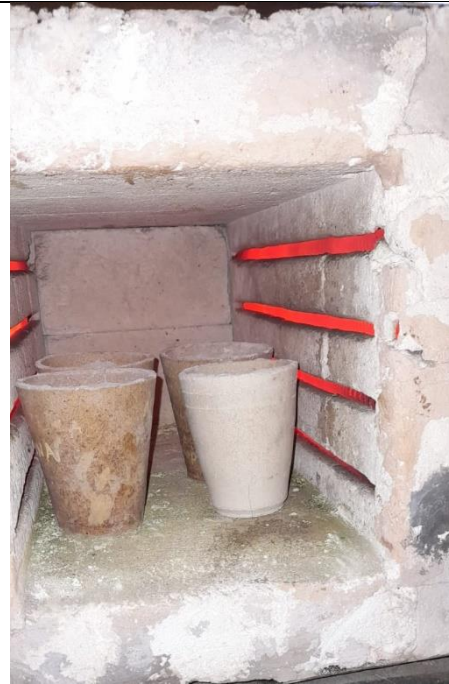
Figura 6: Quema de ceniza a 1100 °C.
