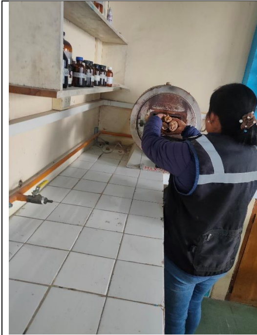
Figura 5: Quema de madera 500 °C.
