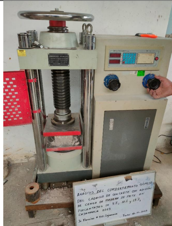
Figura 18: Ensayo a compresión a los 7 días del ladrillo con adición de 5% de ceniza.
