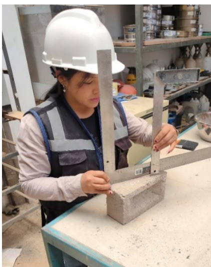
Figura 21. Medida para ensayo de alabeo.
