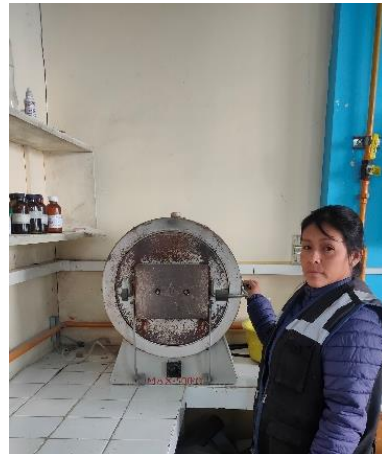
Figura 6 . Quema de la madera para la obtención de ceniza pate
