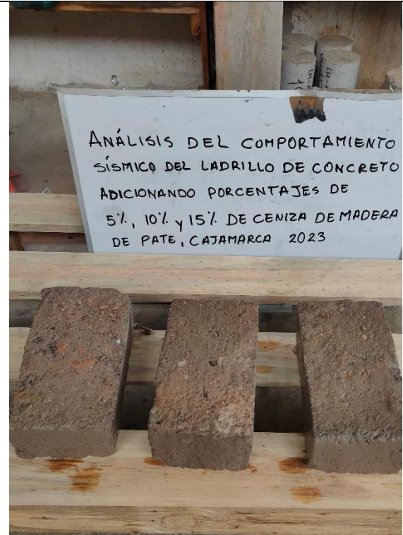
Figura 36: Muestras ensayo absorción.
