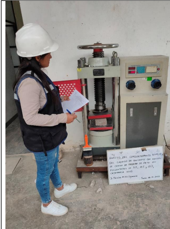
Figura 17: Ensayo a compresión a los 7 días del ladrillo con adición de 5% de ceniza.
