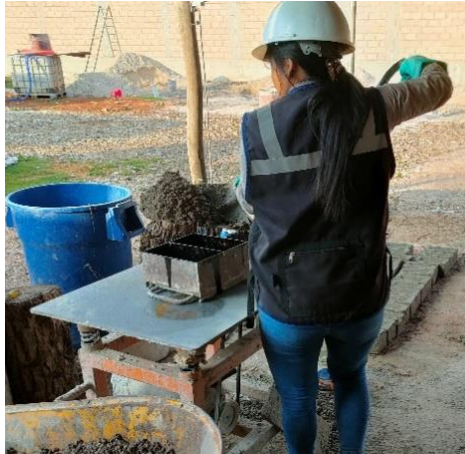
Figura 13 . Elaboración de ladrillos en mesa vibradora.
