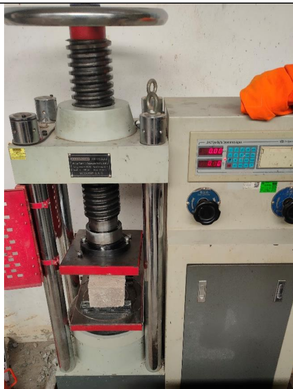
Figura 33: Ensayo a compresión de los ladrillos con 15% de ceniza a los 28 días.
