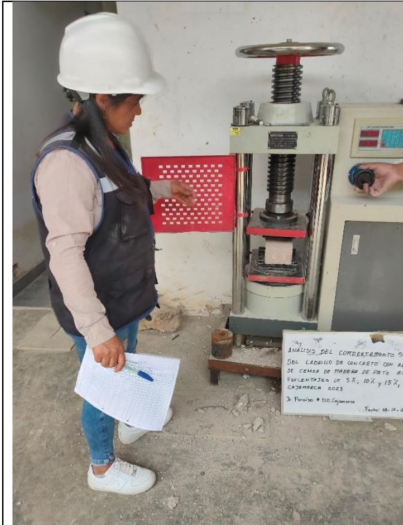
Figura 21: Ensayo a flexion a los 7 dias del ladrillo co adición de 5% de ceniza.
