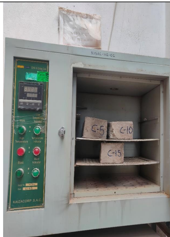
Figura 34: Secado de muestras- Ensayo de absorción.
