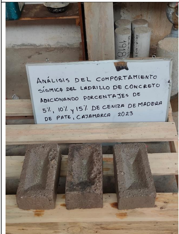
Figura 37: Muestras ensayo absorción.
