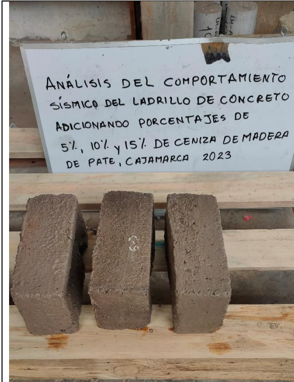
Figura 35: Muestras ensayo absorción.
