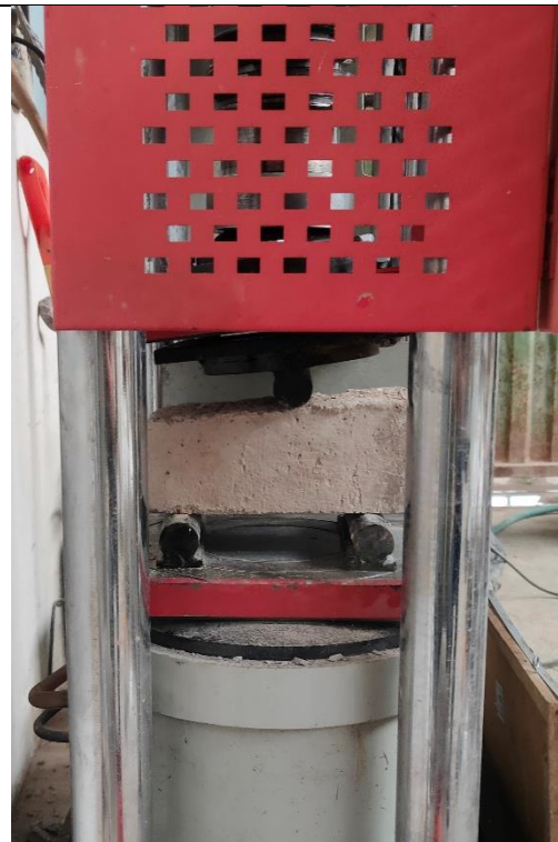
Figura 32: Ensayo a compresión de los ladrillos con 10% de ceniza a los 28 días.
