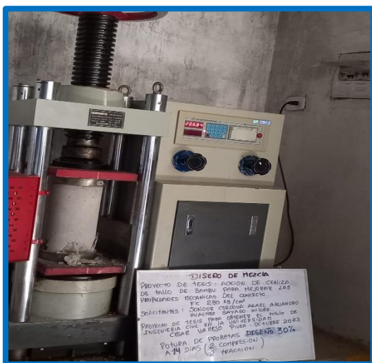
Imagen 49 y 50: Rotura de muestra con adición de ceniza al 30% a compresión y tracción.
