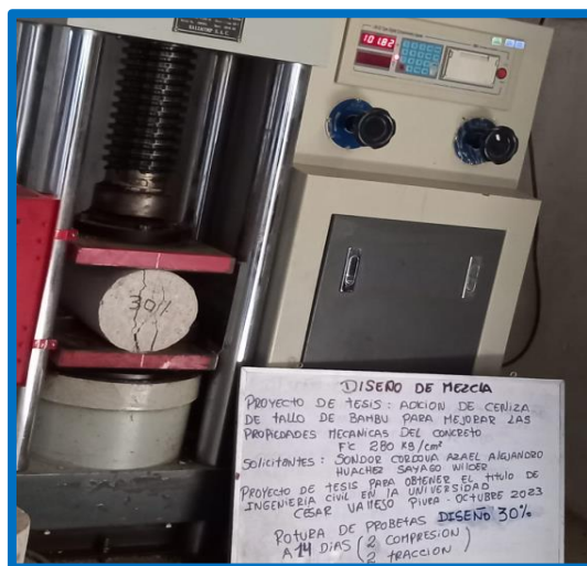
Imagen 49 y 50: Rotura de muestra con adición de ceniza al 30% a compresión y tracción.
