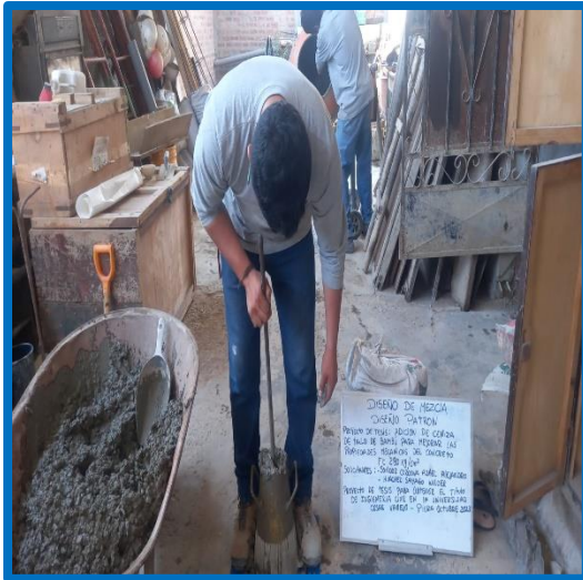
Imagen 39 y 40: Ensayo del cono de Abrams y resultado de asentamiento.
