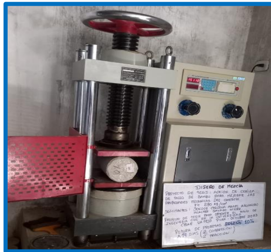
Imagen 47 y 48: Rotura de muestra con adición de ceniza al 20% a compresión y tracción.
