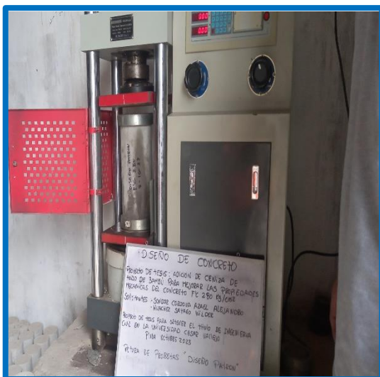
Imagen 43 y 44: Rotura de muestra patrón a compresión y tracción
