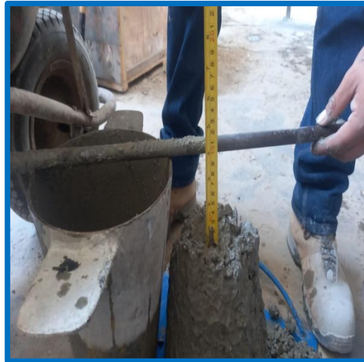
Imagen 39 y 40: Ensayo del cono de Abrams y resultado de asentamiento.
