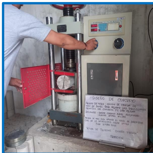
Imagen 43 y 44: Rotura de muestra patrón a compresión y tracción
