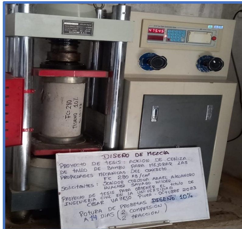
Imagen 10 – Resistencia a la compresión concreto patrón 280kg/cm 2
