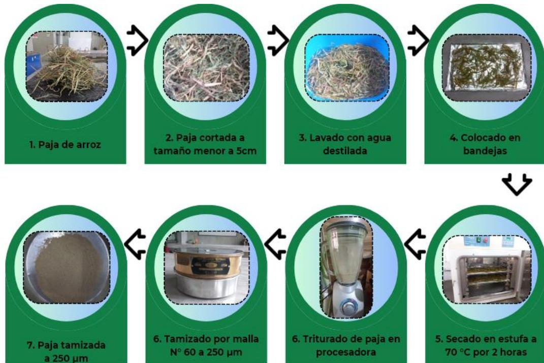
Figura 7. Proceso de acondicionamiento de paja de arroz a tamaño de 250  $\mu\text{m}$
