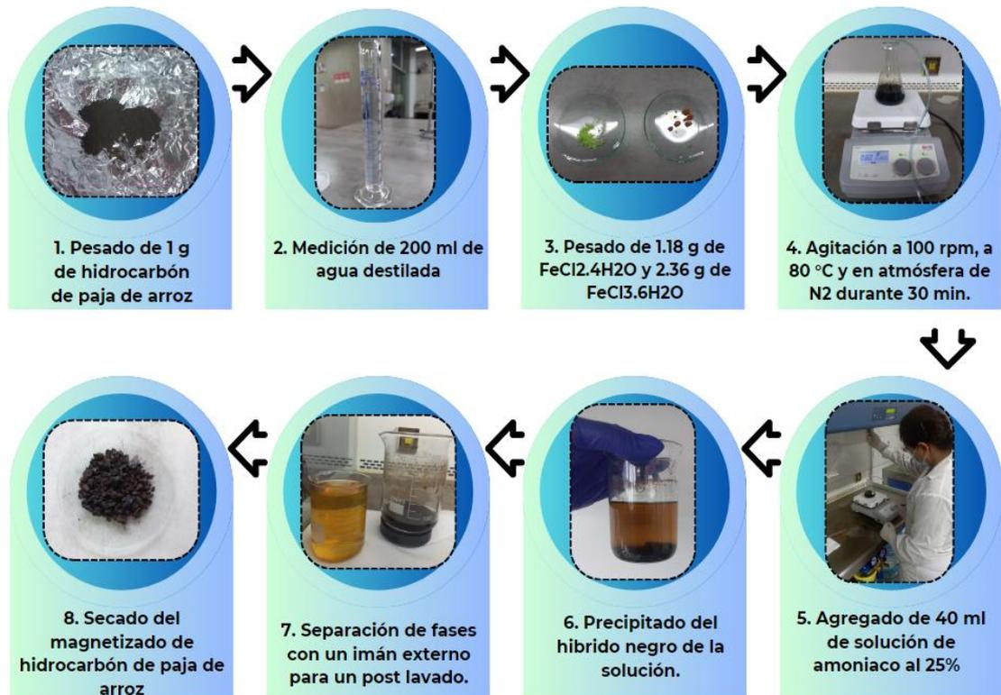
Figura 9. Proceso de magnetización del hidrocarbón de paja de arroz (Elaboración Propia).
