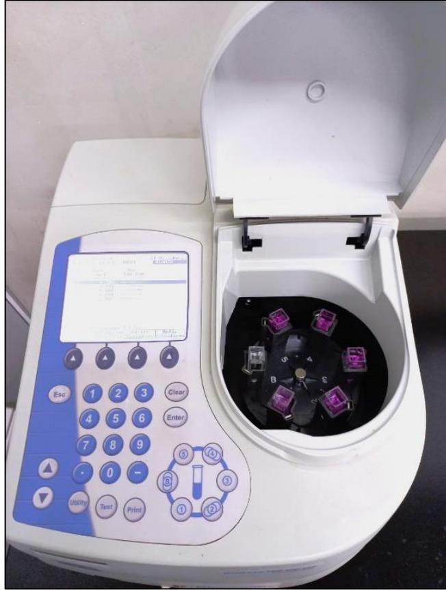
Figura 16. Lectura de muestras en el espectrofotómetro UV-Visible (Elaboración Propia).
