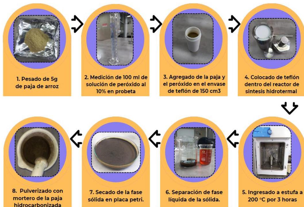
Figura 8. Proceso de hidrocarbonización de paja de arroz (Elaboración Propia).
