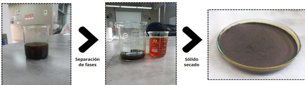
Figura 17. Separación de fases hasta la obtención de sólido de hidrocarbón de paja de arroz
