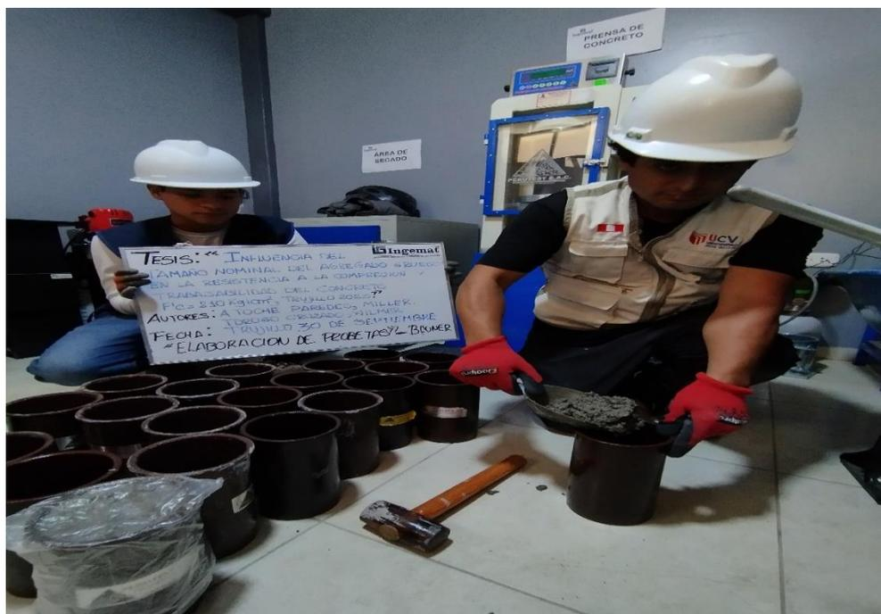
Figura 32. Elaboración de probetas de concreto
