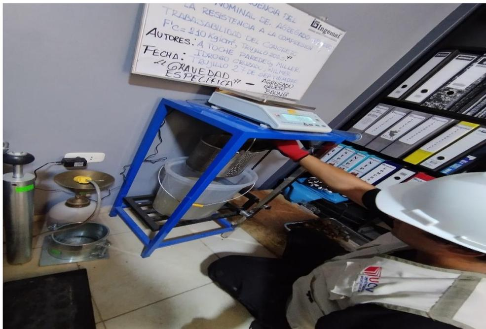
Figura 18. Ensayo de gravedad específica de agregado grueso
