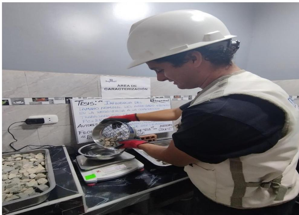
Figura 10. Ensayo granulométrico de agregado fino
