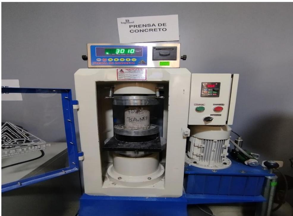
Figura 38. Ensayos de resistencia a la compresión del concreto
