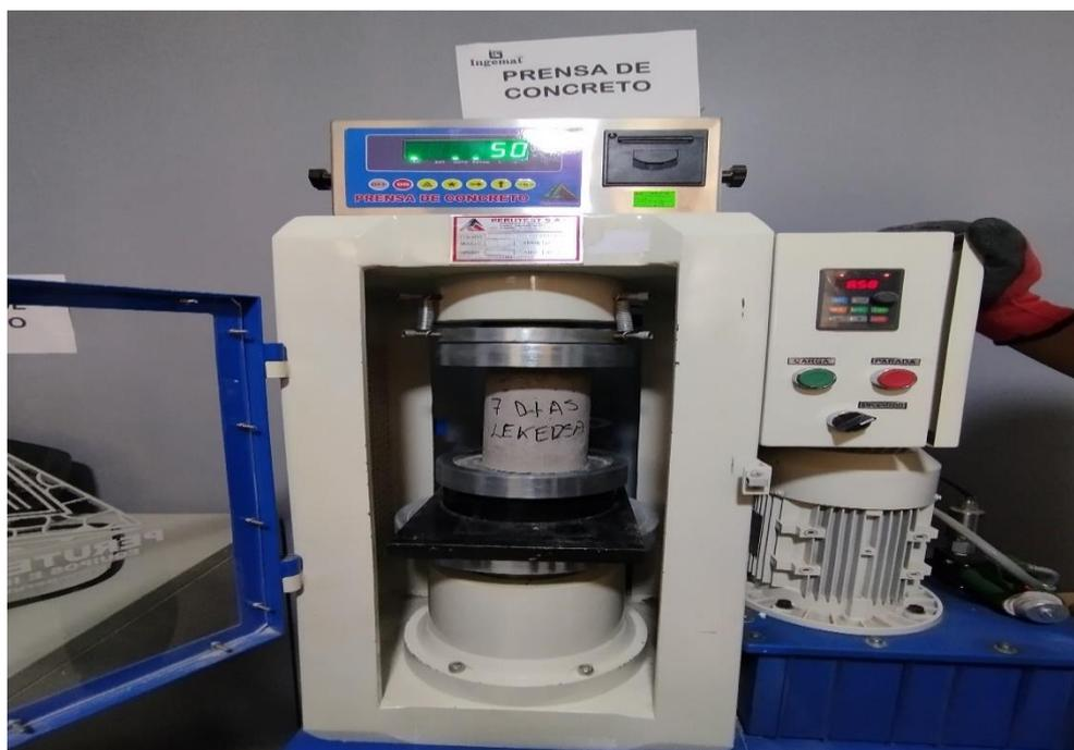
Figura 36. Ensayos de resistencia a la compresión del concreto
