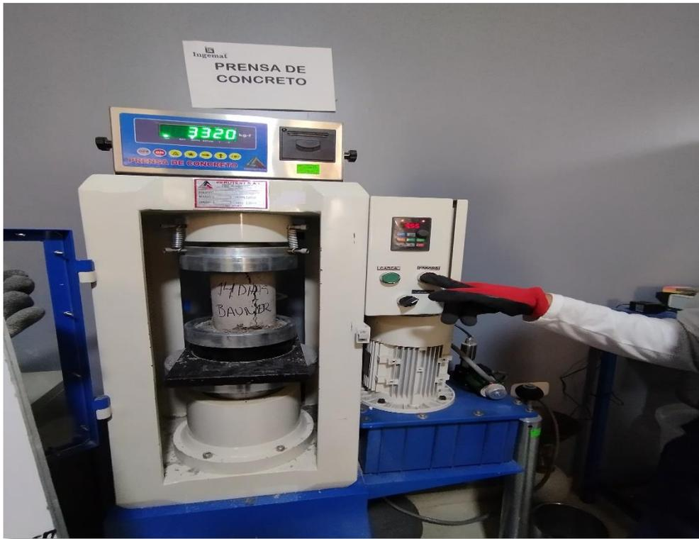
Figura 39. Ensayos de resistencia a la compresión del concreto
