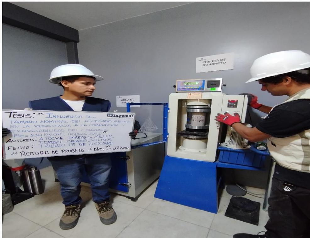
Figura 35. Ensayos de resistencia a la compresión del concreto
