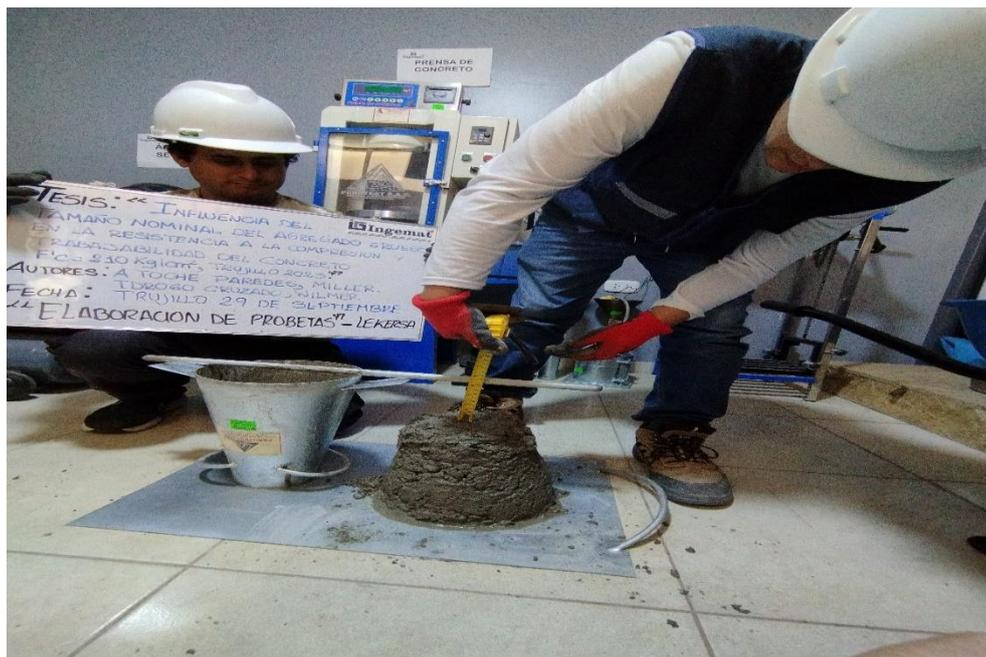
Figura 28. Ensayo de asentamiento del concreto fresco
