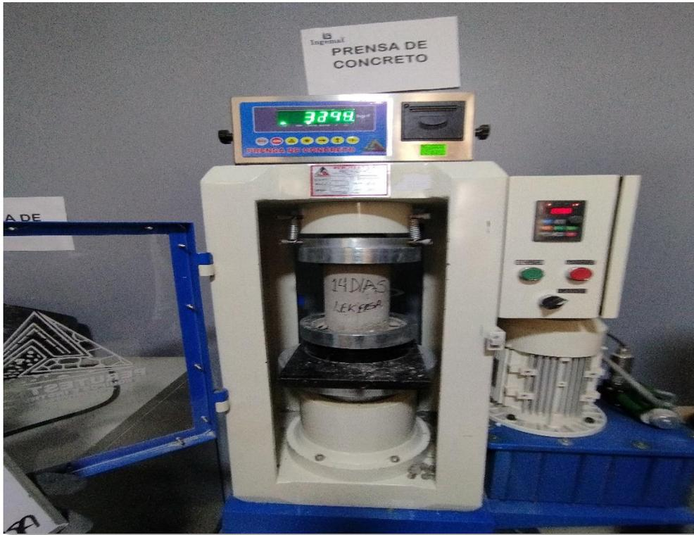
Figura 41. Ensayos de resistencia a la compresión del concreto
