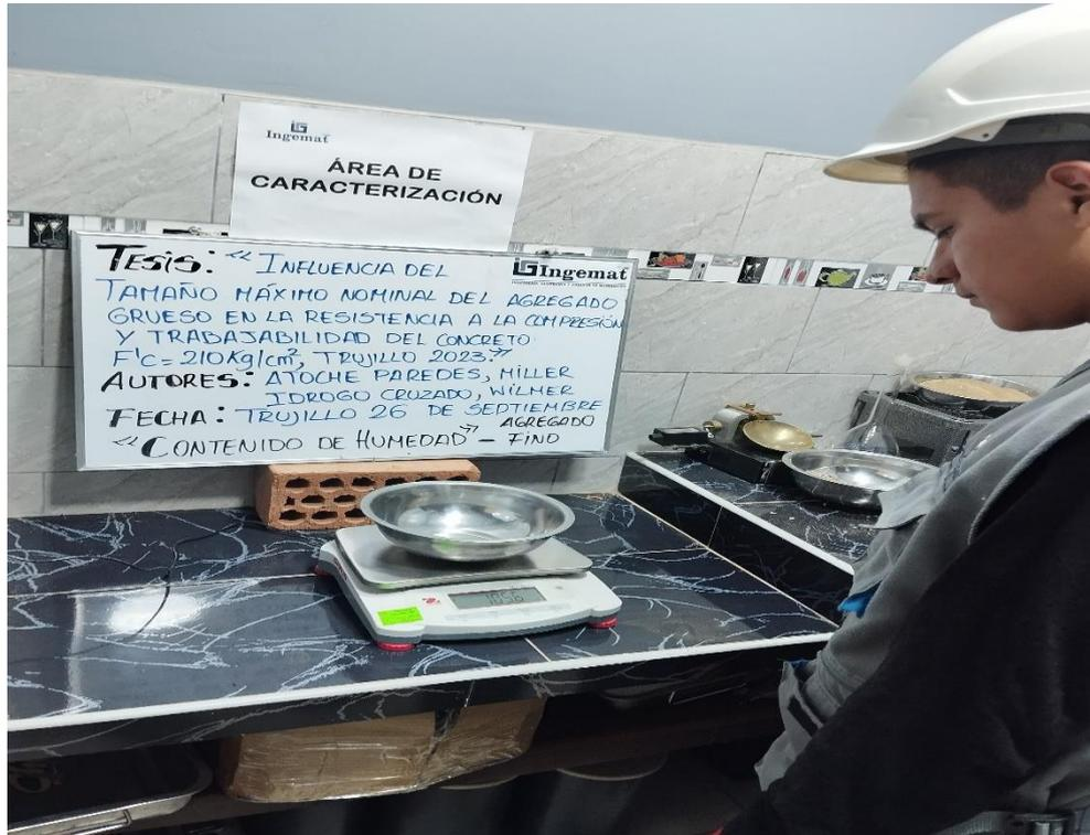
Figura 13. Ensayo de contenido de humedad de agregado fino
