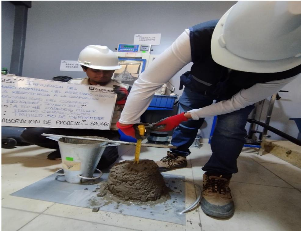
Figura 29. Ensayo de asentamiento del concreto fresco
