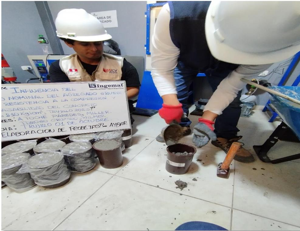
Figura 33. Elaboración de probetas de concreto
