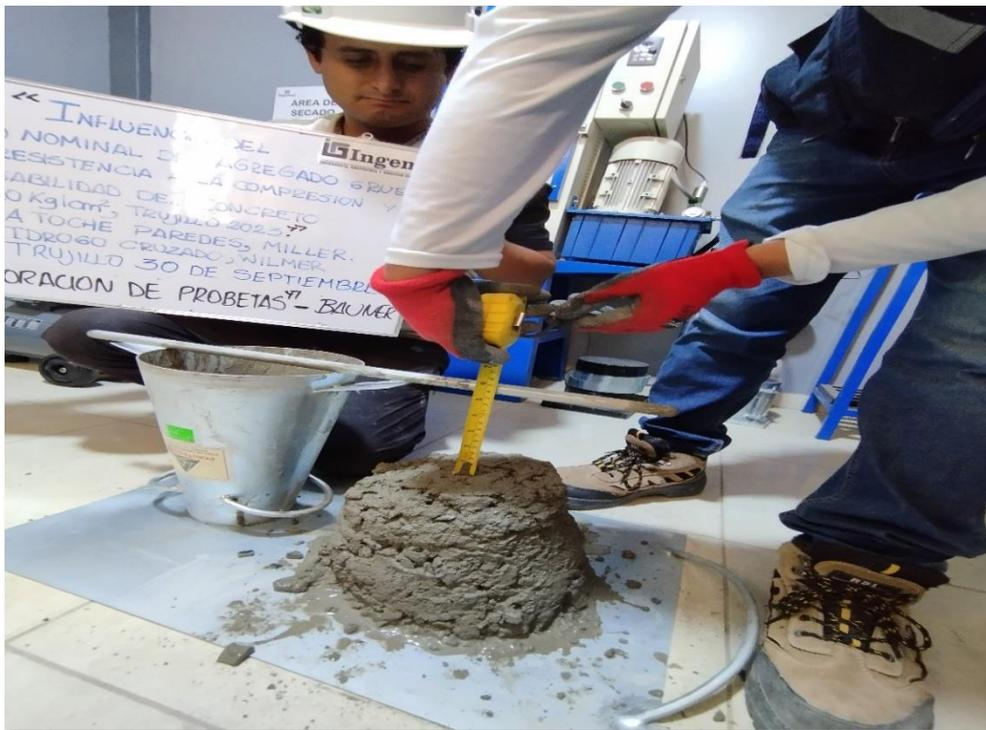
Figura 30. Elaboración de probetas de concreto
