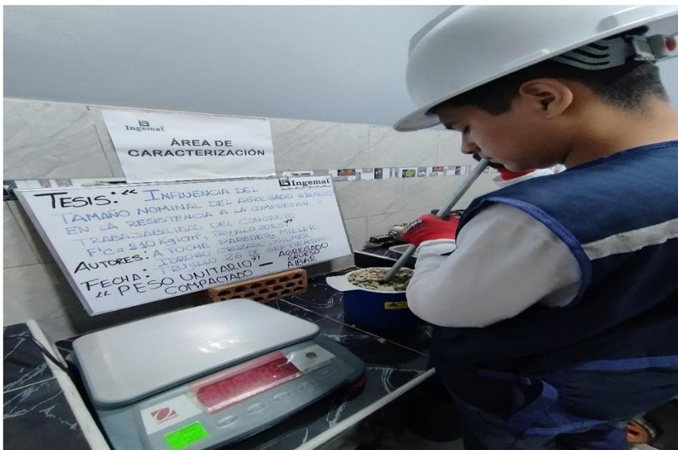
Figura 24. Ensayo de peso unitario suelto y compactado de agregado grueso
