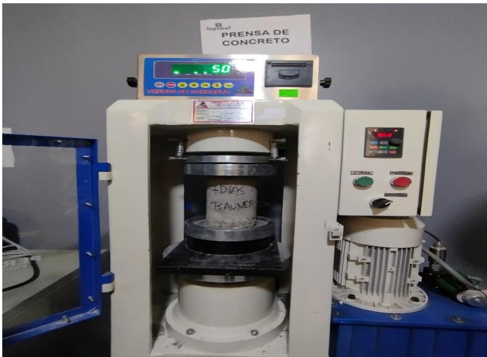
Figura 40. Ensayos de resistencia a la compresión del concreto
