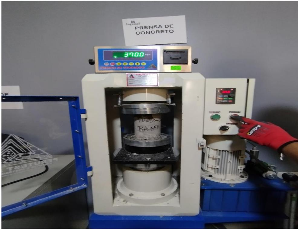
Figura 37. Ensayos de resistencia a la compresión del concreto
