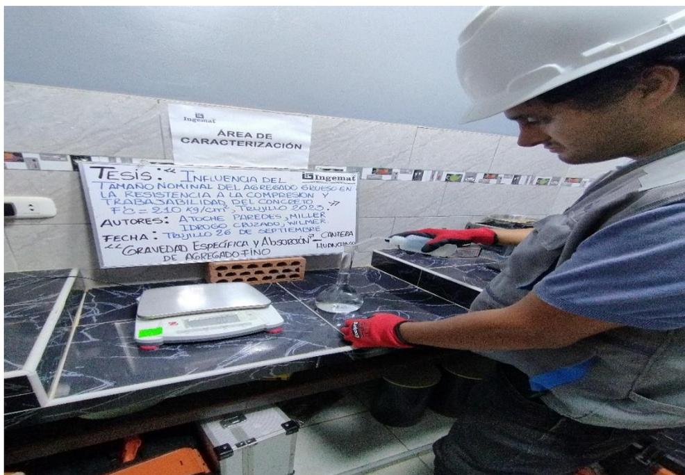
Figura 16. Ensayo de gravedad específica de agregado fino
