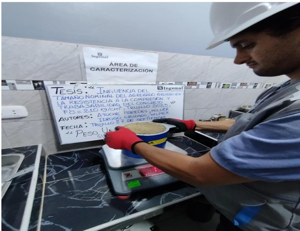
Figura 22. Ensayo de peso unitario suelto y compactado de agregado fino
