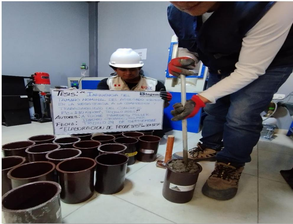
Figura 31. Elaboración de probetas de concreto
