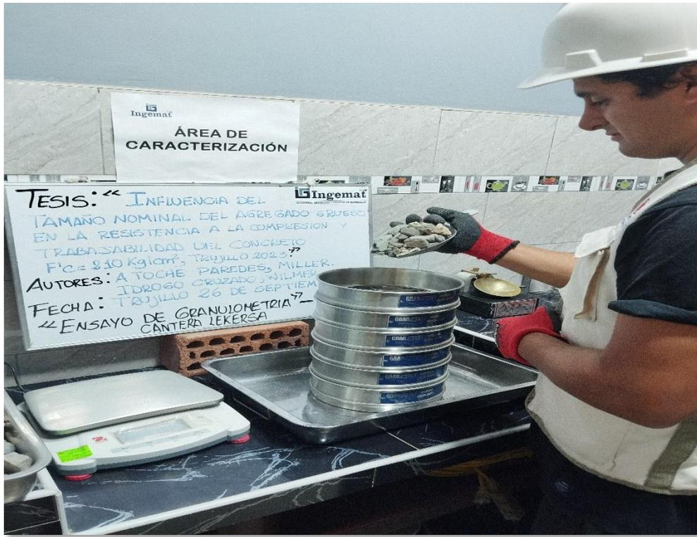
Figura 9. Ensayo granulométrico de agregado grueso
