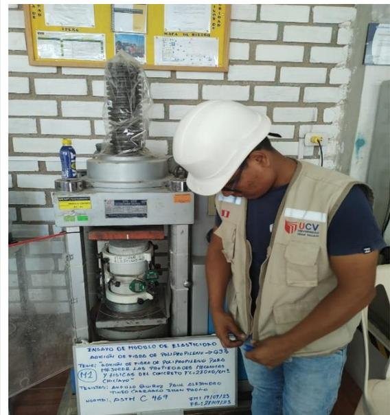
**Imagen N°85: CHICLAYO.** Ensayo de módulo de elasticidad, con adición de 0.3% de fibra a los 14 días de curado, 2023.
