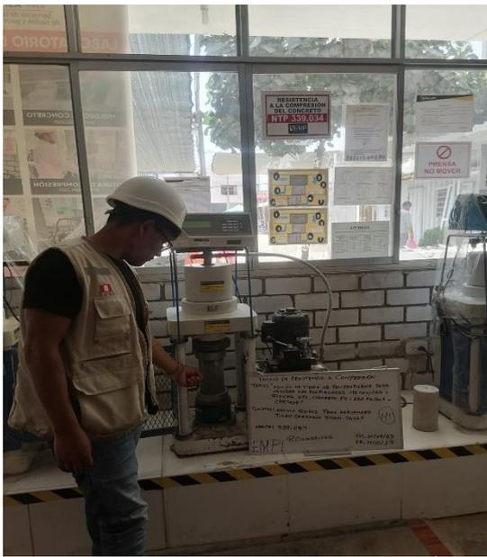
**Imagen N°114: CHICLAYO.** Ensayo de resistencia a compresión, con adición de 2.5% de fibra a los 7 días de curado, 2023.
