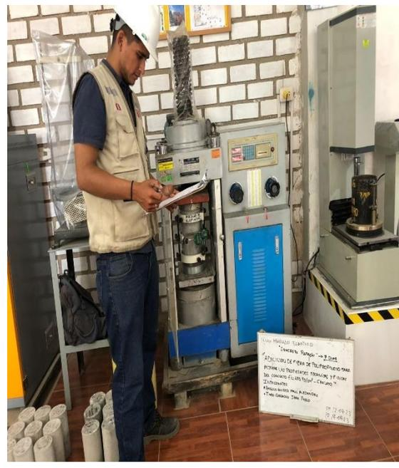
**Imagen N°69: CHICLAYO.** Ensayo de módulo de elasticidad, concreto patrón, a los 7 días de curado, 2023.
