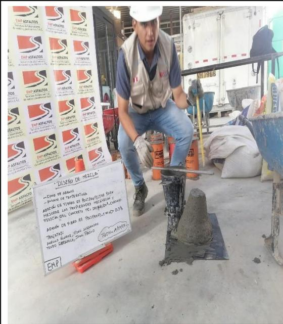
**Imagen N°30: CHICLAYO.** Ensayo de asentamiento (slump), adición de 0.3% fibra de polipropileno, 2023.
