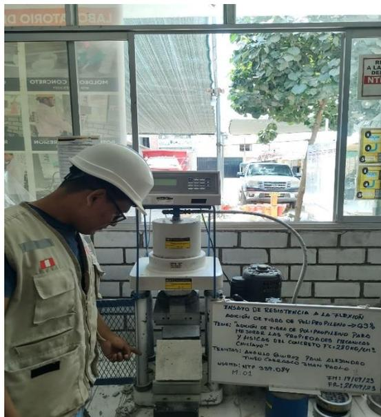
**Imagen N°84: CHICLAYO.** Ensayo de resistencia a flexión, con adición de 0.3% de fibra a los 14 días de curado, 2023.
