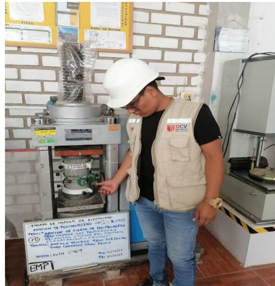
**Imagen N°117: CHICLAYO.** Ensayo de módulo de elasticidad, con adición de 2.5% de fibra a los 7 días de curado, 2023.
