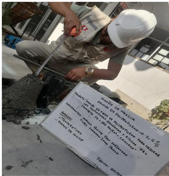
**Imagen N°46: CHICLAYO.** Ensayo de asentamiento (slump), adición de 1.5% fibra de polipropileno, 2023.
