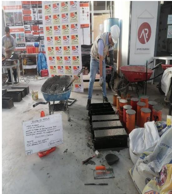
**Imagen N°50: CHICLAYO.** Elaboración de probetas, adición de 1.5% fibra de polipropileno, 2023.
