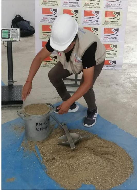
**Imagen N°14: CHICLAYO.** Ensayo de Peso específico, agregado fino, 2023.
