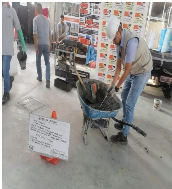
**Imagen N°24: CHICLAYO.** Ensayo de temperatura, del concreto patrón, 2023.
