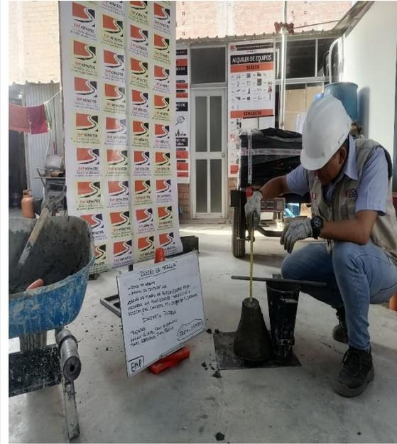
**Imagen N°23: CHICLAYO.** Ensayo de asentamiento (slump), del concreto patrón, 2023.
