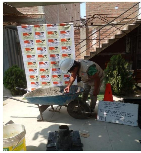
**Imagen N°25: CHICLAYO.** Ensayo de temperatura, del concreto patrón, 2023.
