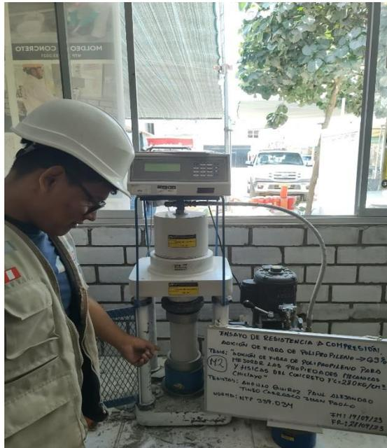
**Imagen N°82: CHICLAYO.** Ensayo de resistencia a compresión, con adición de 0.3% de fibra a los 17 días de curado, 2023.
