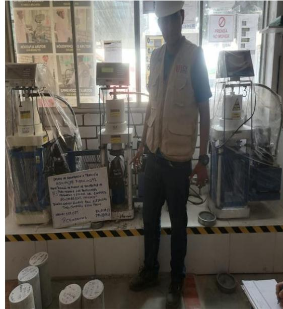
**Imagen N°91: CHICLAYO** Ensayo de resistencia a tracción, con adición de 0.9% de fibra a los 7 días de curado, 2023.
