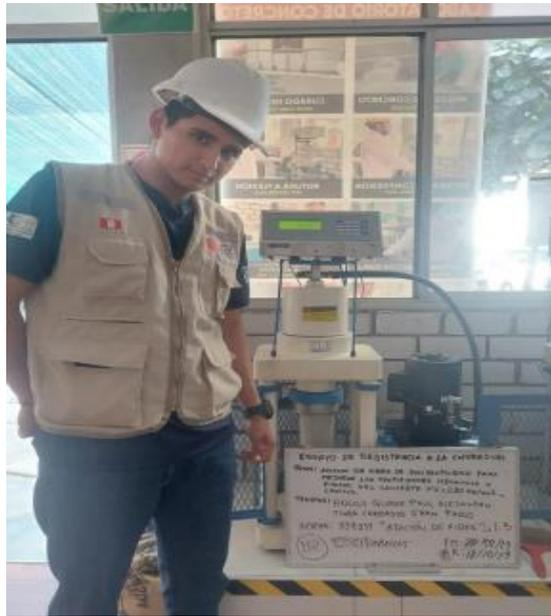
**Imagen N°110: CHICLAYO.** Ensayo de resistencia a compresión, con adición de 1.5% de fibra a los 28 días de curado, 2023.
