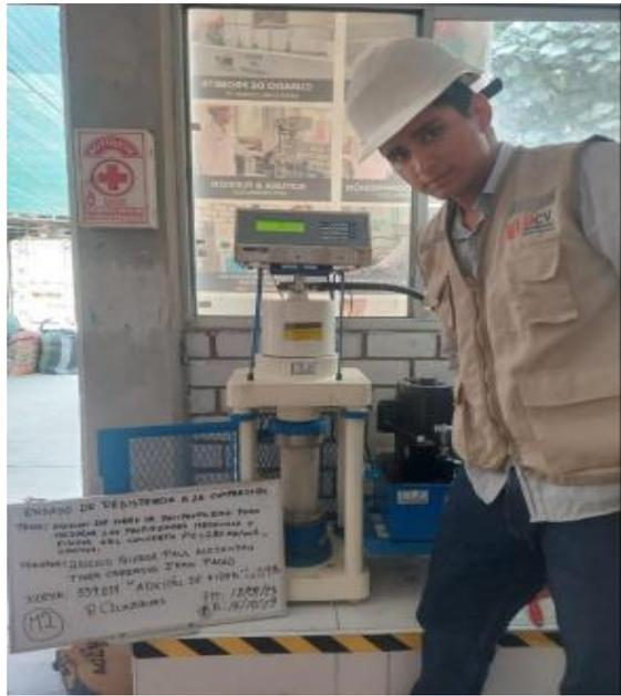
**Imagen N°98: CHICLAYO.** Ensayo de resistencia a compresión, con adición de 0.9% de fibra a los 28 días de curado, 2023.
