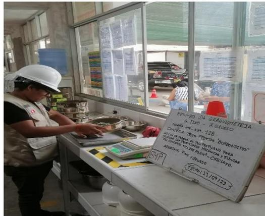
**Imagen N°05: CHICLAYO. Ensayo de granulometría, agregado grueso, 2023.**
