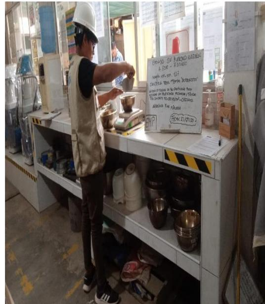
**Imagen N°09: CHICLAYO.** Ensayo de Peso específico, agregado grueso, 2023.
