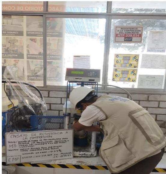
**Imagen N°118: CHICLAYO.** Ensayo de resistencia a compresión, con adición de 2.5% de fibra a los 14 días de curado, 2023.
