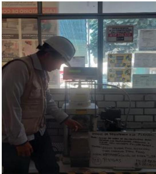
**Imagen N°100: CHICLAYO.** Ensayo de resistencia a flexión, con adición de 0.9% de fibra a los 28 días de curado, 2023.
