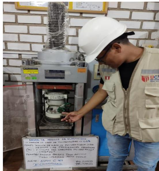
**Imagen N°113: CHICLAYO.** Ensayo de módulo de elasticidad, con adición de 1.5% de fibra a los 28 días de curado, 2023.
