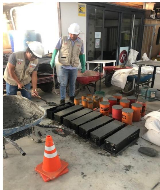
**Imagen N°60: CHICLAYO.** Elaboración de probetas, adición de 2.5% fibra de polipropileno, 2023.
