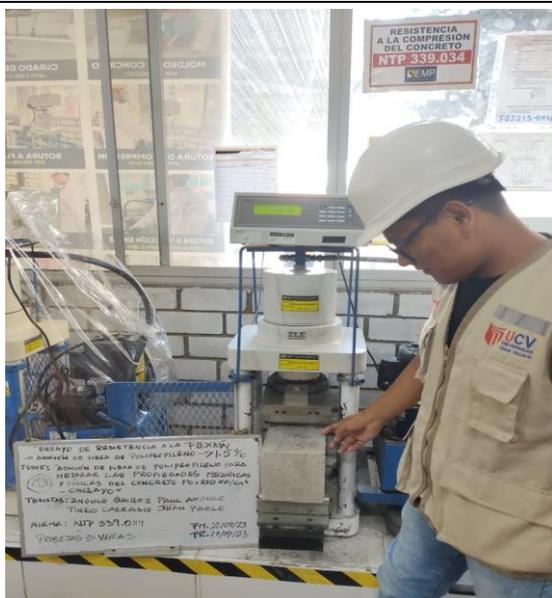
**Imagen N°104: CHICLAYO.** Ensayo de resistencia a flexión, con adición de 1.5% de fibra a los 7 días de curado, 2023.
