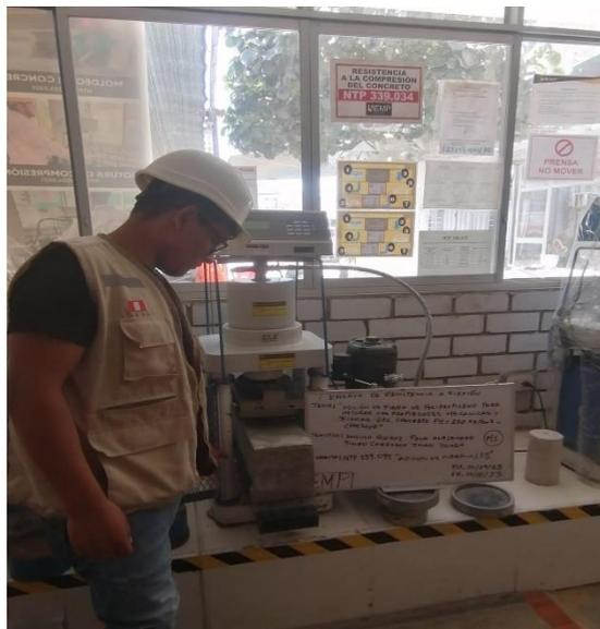
**Imagen N°108: CHICLAYO.** Ensayo de resistencia a flexión, con adición de 1.5% de fibra a los 14 días de curado, 2023.
