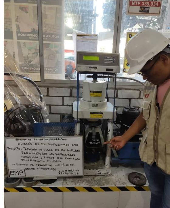
**Imagen N°79: CHICLAYO** Ensayo de resistencia a tracción, con adición de 0.3% de fibra a los 7 días de curado, 2023.
