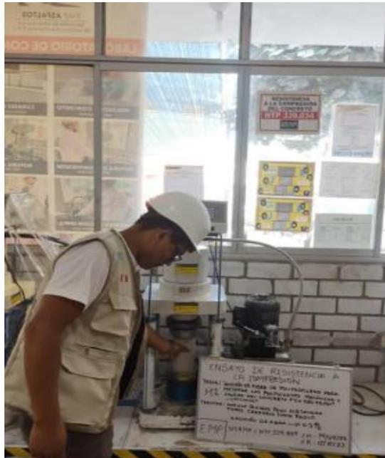
**Imagen N°86: CHICLAYO.** Ensayo de resistencia a compresión, con adición de 0.3% de fibra a los 28 días de curado, 2023.
