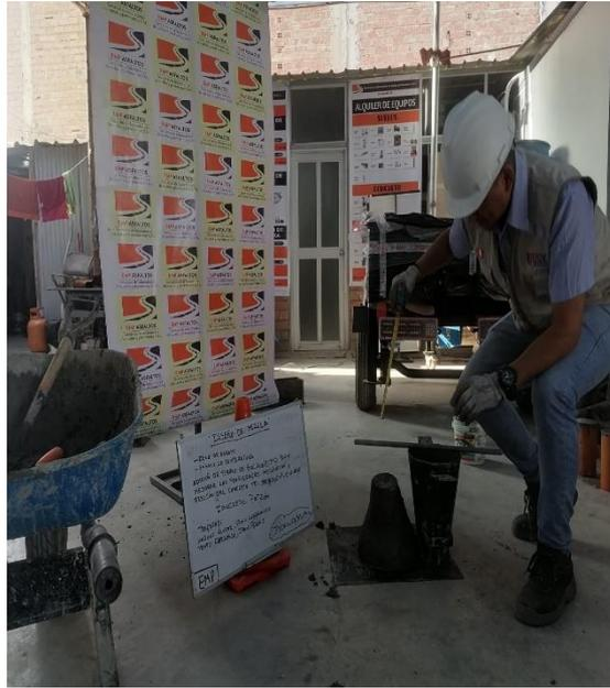
**Imagen N°22: CHICLAYO.** Ensayo de asentamiento (slump), del concreto patrón, 2023.
