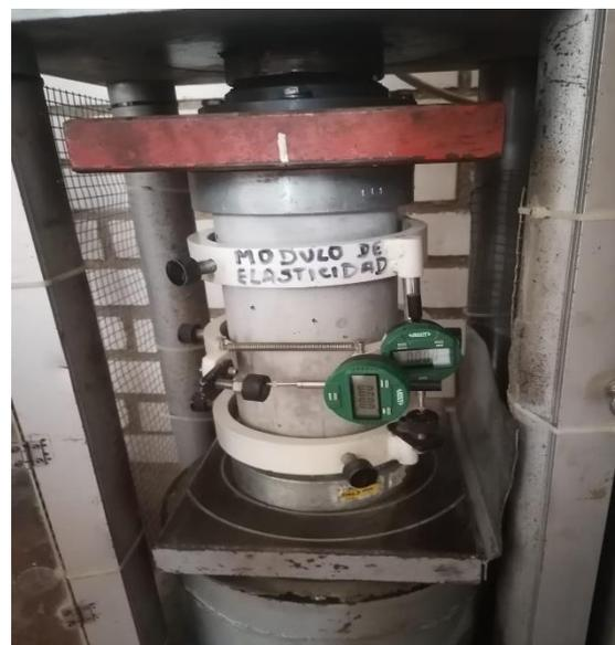
**Imagen N°89: CHICLAYO.** Ensayo de módulo de elasticidad, con adición de 0.3% de fibra a los 28 días de curado, 2023.
