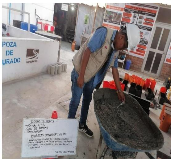
**Imagen N°40: CHICLAYO.** Ensayo de temperatura, adición de 0.9% fibra de polipropileno, 2023.
