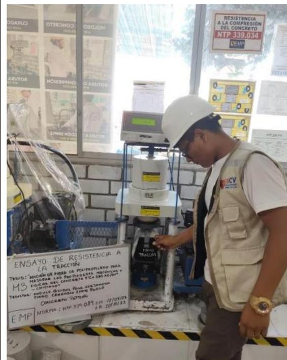
**Imagen N°75: CHICLAYO** Ensayo de resistencia a tracción, concreto patrón, a los 28 días de curado, 2023.
