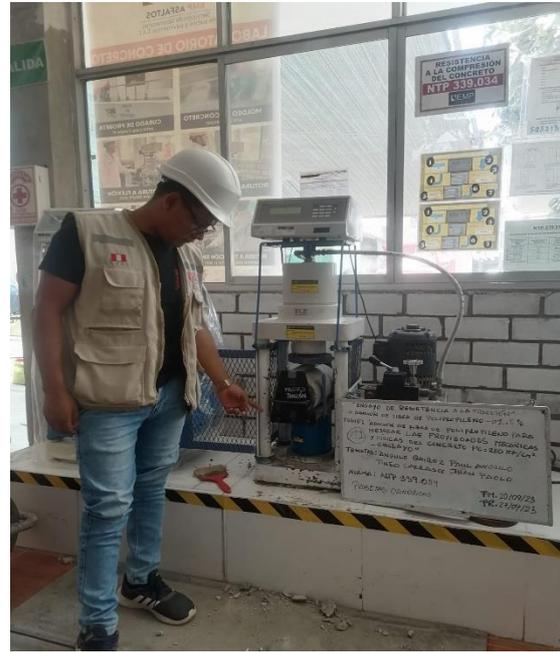
**Imagen N°103: CHICLAYO** Ensayo de resistencia a tracción, con adición de 1.5% de fibra a los 7 días de curado, 2023.
