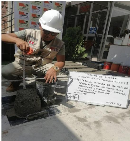
**Imagen N°54: CHICLAYO.** Ensayo de asentamiento (slump), adición de 2.5% fibra de polipropileno, 2023.
