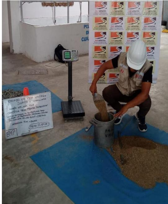
**Imagen N°10: CHICLAYO.** Ensayo de Peso específico, agregado fino, 2023.
