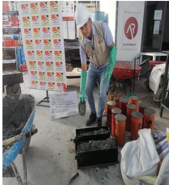
**Imagen N°43: CHICLAYO.** Elaboración de probetas, adición de 0.9% fibra de polipropileno, 2023.
