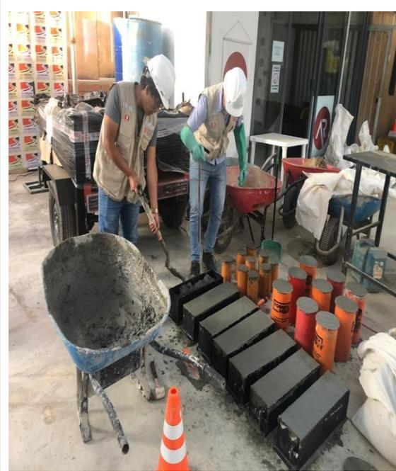
**Imagen N°59: CHICLAYO.** Elaboración de probetas, adición de 2.5% fibra de polipropileno, 2023.
