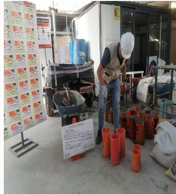
**Imagen N°51: CHICLAYO.** Elaboración de probetas, adición de 1.5% fibra de polipropileno, 2023.
