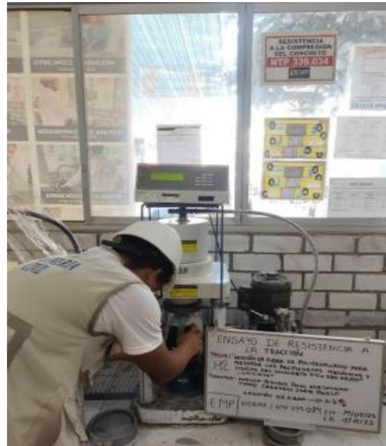
**Imagen N°87: CHICLAYO** Ensayo de resistencia a tracción, con adición de 0.3% de fibra a los 28 días de curado, 2023.
