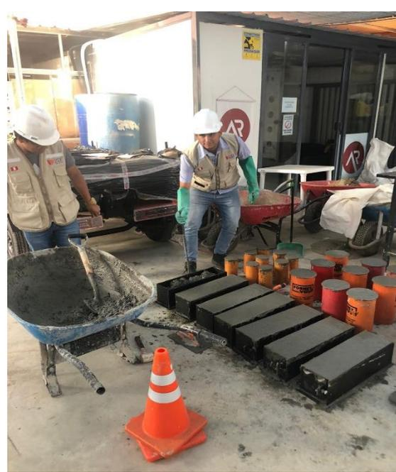
**Imagen N°58: CHICLAYO.** Elaboración de probetas, adición de 2.5% fibra de polipropileno, 2023.
