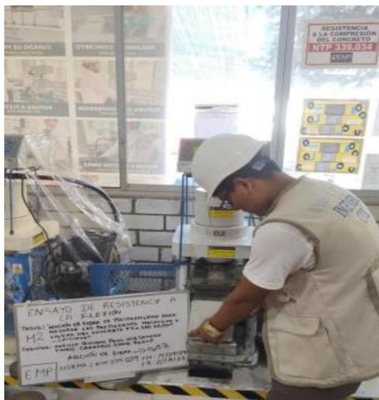
**Imagen N°88: CHICLAYO.** Ensayo de resistencia a flexión, con adición de 0.3% de fibra a los 28 días de curado, 2023.
