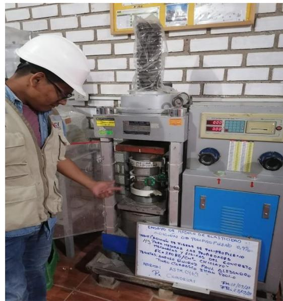
**Imagen N°93: CHICLAYO.** Ensayo de módulo de elasticidad, con adición de 0.9% de fibra a los 7 días de curado, 2023.
