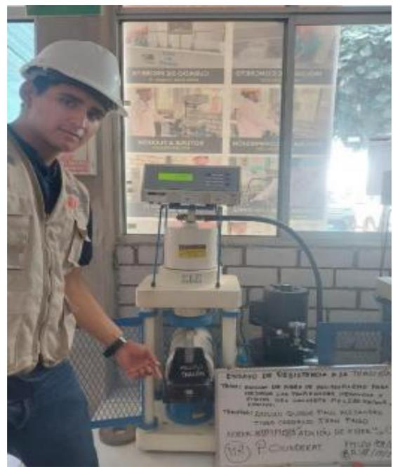
**Imagen N°123: CHICLAYO** Ensayo de resistencia a tracción, con adición de 2.5% de fibra a los 28 días de curado, 2023.
