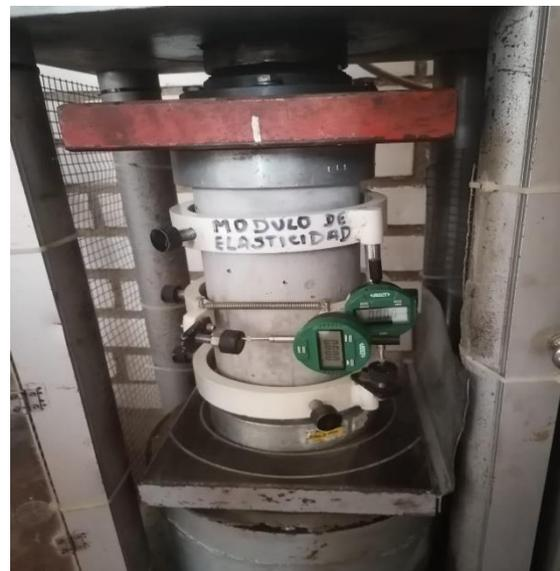
**Imagen N°105: CHICLAYO.** Ensayo de módulo de elasticidad, con adición de 1.5% de fibra a los 7 días de curado, 2023.
