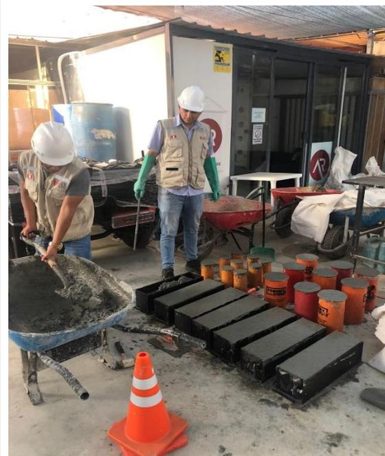
**Imagen N°61: CHICLAYO.** Elaboración de probetas, adición de 2.5% fibra de polipropileno, 2023.
