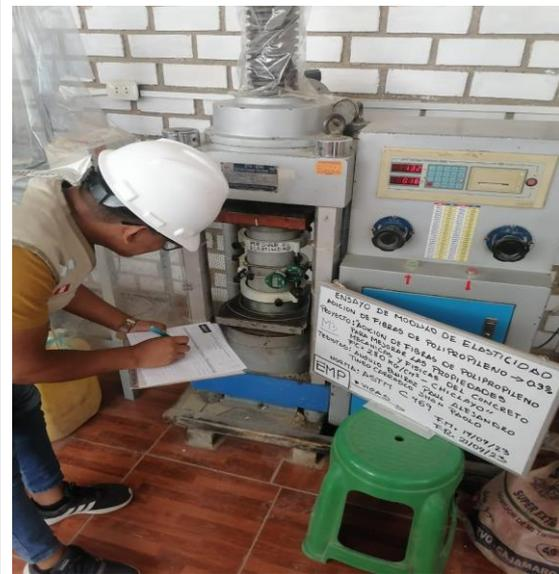
**Imagen N°81: CHICLAYO.** Ensayo de módulo de elasticidad, con adición de 0.3% de fibra a los 7 días de curado, 2023.
