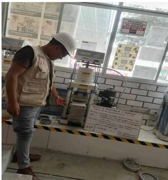
**Imagen N°92: CHICLAYO.** Ensayo de resistencia a flexión, con adición de 0.9% de fibra a los 7 días de curado, 2023.
