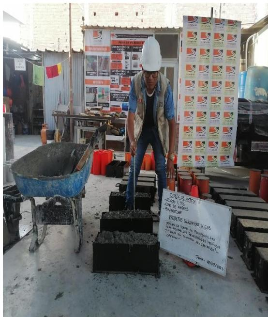
**Imagen N°44: CHICLAYO.** Elaboración de probetas, adición de 0.9% fibra de polipropileno, 2023.
