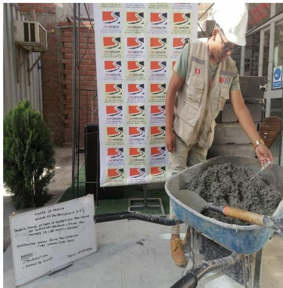
**Imagen N°48: CHICLAYO.** Ensayo de temperatura, adición de 1.5% fibra de polipropileno, 2023.
