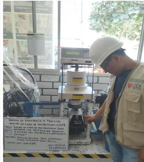
**Imagen N°83: CHICLAYO** Ensayo de resistencia a tracción, con adición de 0.3% de fibra a los 14 días de curado, 2023.
