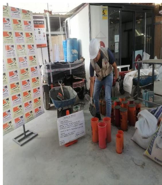
**Imagen N°34: CHICLAYO.** Elaboración de probetas, adición de 0.3% fibra de polipropileno, 2023.
