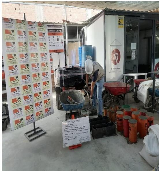
**Imagen N°52: CHICLAYO.** Elaboración de probetas, adición de 1.5% fibra de polipropileno, 2023.
