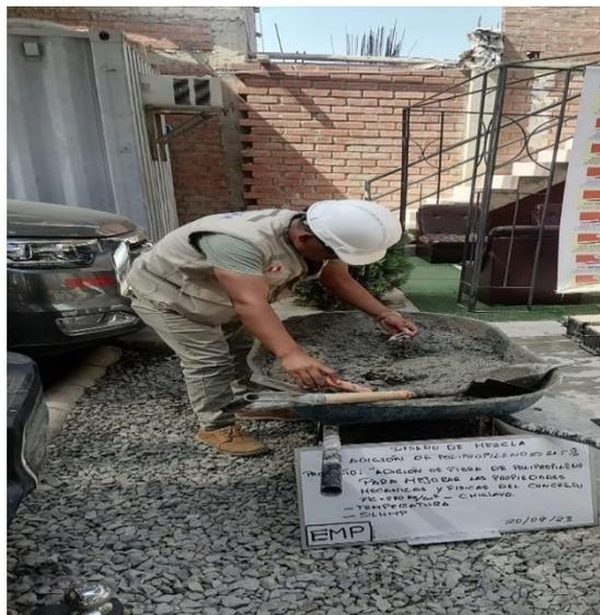
**Imagen N°56: CHICLAYO.** Ensayo de temperatura, adición de 2.5% fibra de polipropileno, 2023.
