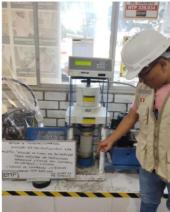
**Imagen N°78: CHICLAYO.** Ensayo de resistencia a compresión, con adición de 0.3% de fibra a los 7 días de curado, 2023.
