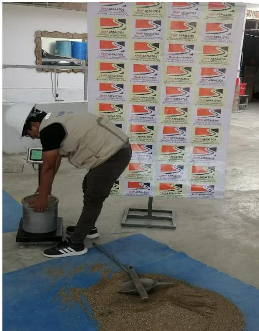
**Imagen N°16: CHICLAYO.** Ensayo de Peso específico, agregado fino, 2023.
