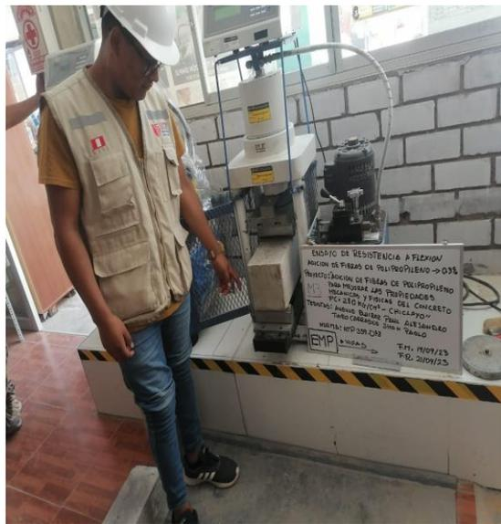
**Imagen N°80: CHICLAYO.** Ensayo de resistencia a flexión, con adición de 0.3% de fibra a los 7 días de curado, 2023.
