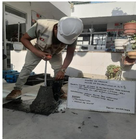
**Imagen N°47: CHICLAYO.** Ensayo de asentamiento (slump), adición de 1.5% fibra de polipropileno, 2023.
