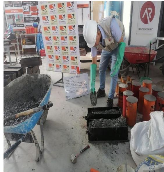
**Imagen N°53: CHICLAYO.** Elaboración de probetas, adición de 1.5% fibra de polipropileno, 2023.
