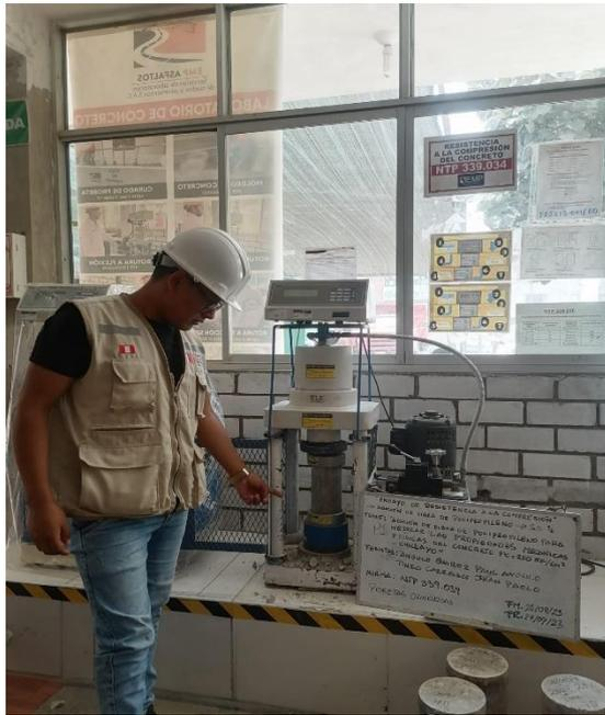
**Imagen N°102: CHICLAYO.** Ensayo de resistencia a compresión, con adición de 1.5% de fibra a los 7 días de curado, 2023.
