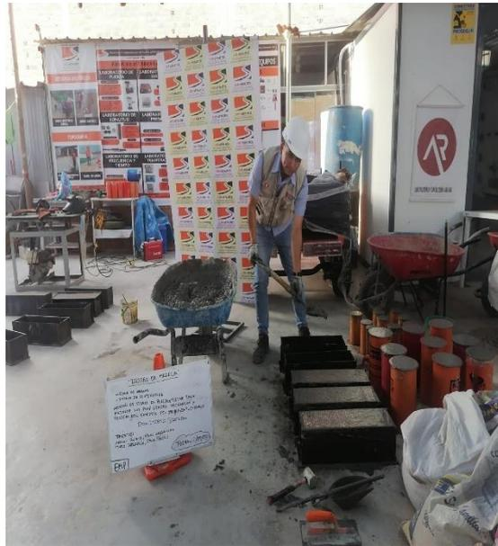
**Imagen N°42: CHICLAYO.** Elaboración de probetas, adición de 0.9% fibra de polipropileno, 2023.
