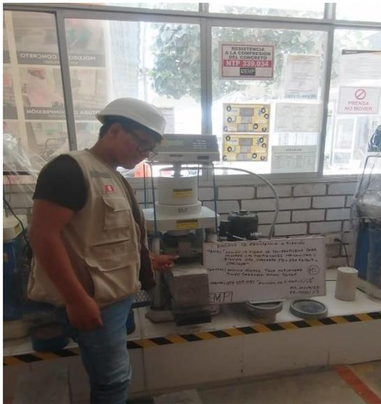
**Imagen N°116: CHICLAYO.** Ensayo de resistencia a flexión, con adición de 2.5% de fibra a los 7 días de curado, 2023.
