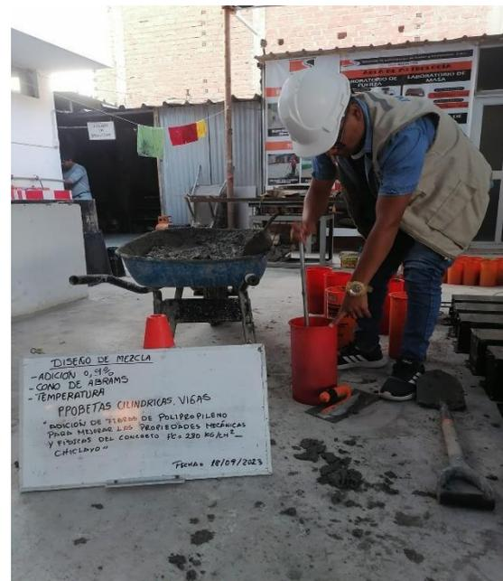
**Imagen N°45: CHICLAYO.** Elaboración de probetas, adición de 0.9% fibra de polipropileno, 2023.
