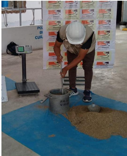
**Imagen N°12: CHICLAYO.** Ensayo de Peso específico, agregado fino, 2023.
