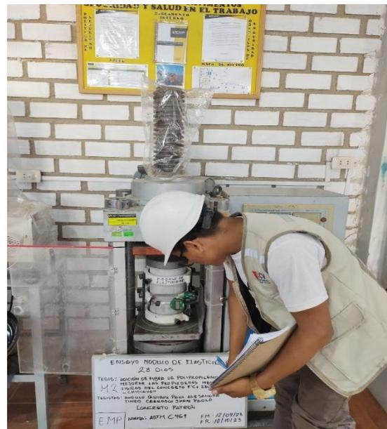
**Imagen N°121: CHICLAYO.** Ensayo de módulo de elasticidad, con adición de 2.5% de fibra a los 14 días de curado, 2023.
