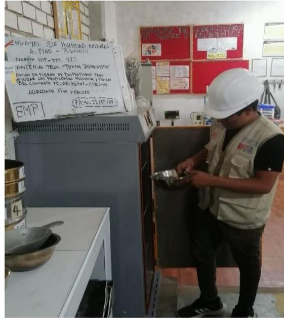
**Imagen N°07: CHICLAYO.** Ensayo de contenido de humedad, agregado grueso, 2023.
