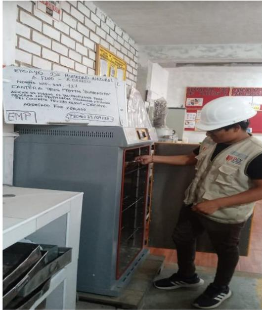
**Imagen N°06: CHICLAYO.** Ensayo de contenido de humedad, agregado fino, 2023.
