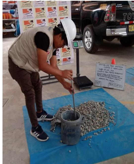
**Imagen N°13: CHICLAYO.** Ensayo de Peso específico, agregado grueso, 2023.
