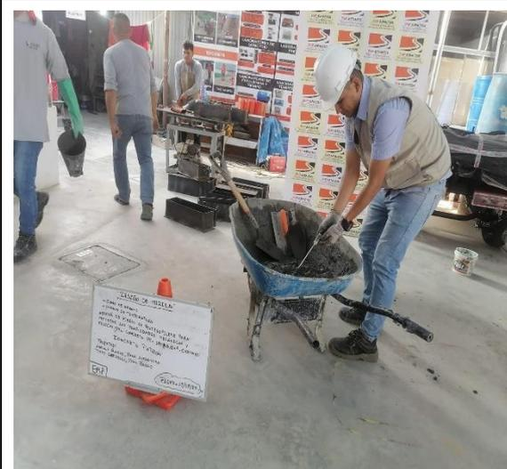
**Imagen N°32: CHICLAYO.** Ensayo de temperatura, adición de 0.3% fibra de polipropileno, 2023.
