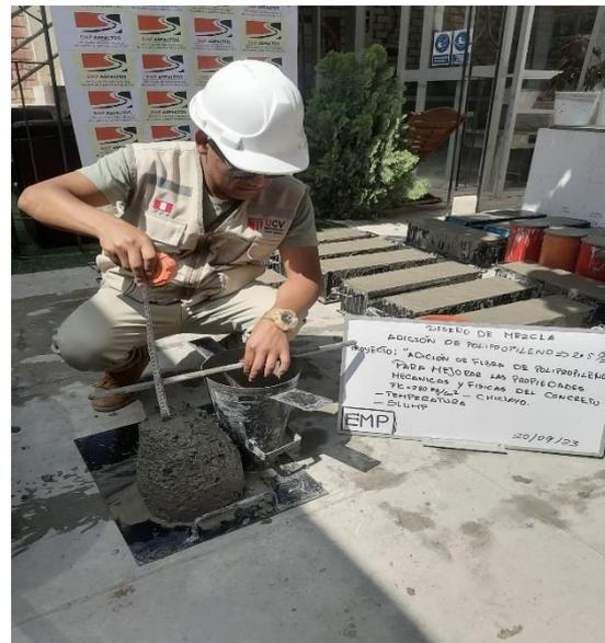
**Imagen N°55: CHICLAYO.** Ensayo de asentamiento (slump), adición de 2.5% fibra de polipropileno, 2023.
