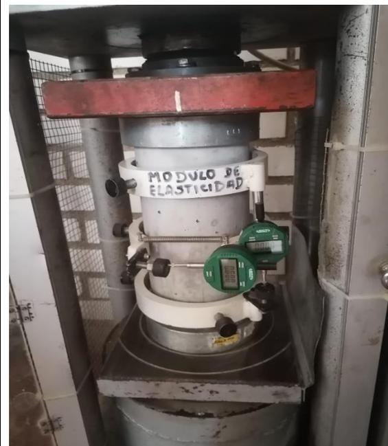
**Imagen N°77: CHICLAYO.** Ensayo de módulo de elasticidad, concreto patrón, a los 28 días de curado, 2023.
