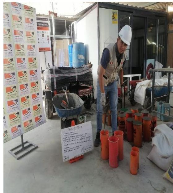
**Imagen N°37: CHICLAYO.** Elaboración de probetas, adición de 0.3% fibra de polipropileno, 2023.
