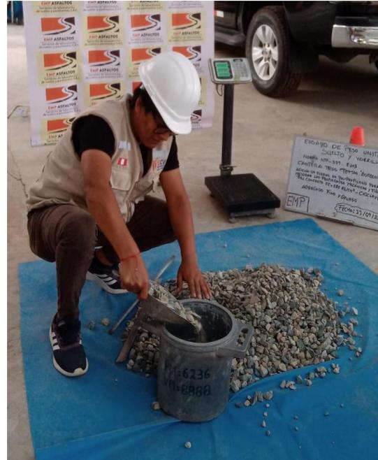
**Imagen N°11: CHICLAYO.** Ensayo de Peso específico, agregado grueso, 2023.
