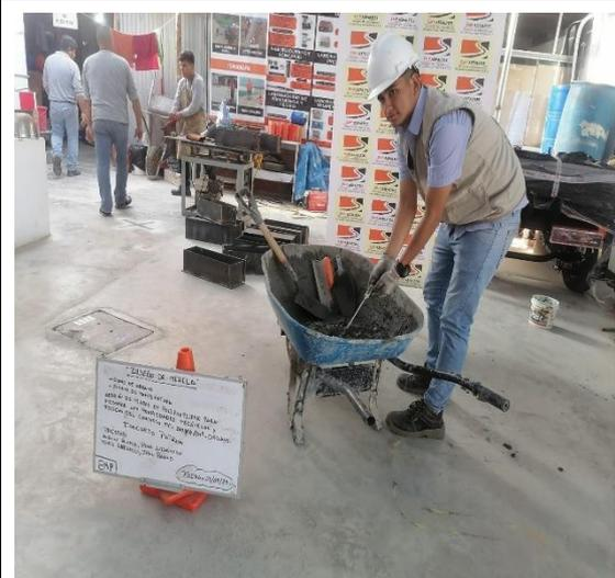
**Imagen N°33: CHICLAYO.** Ensayo de temperatura, adición de 0.3% fibra de polipropileno, 2023.
