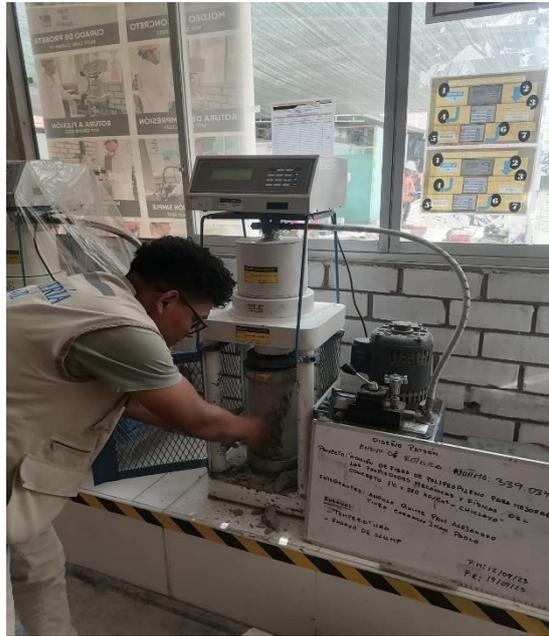
**Imagen N°66: CHICLAYO.** Ensayo de resistencia a compresión, concreto patrón, a los 7 días de curado, 2023.
