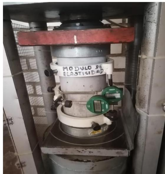
**Imagen N°125: CHICLAYO.** Ensayo de módulo de elasticidad, con adición de 2.5% de fibra a los 28 días de curado, 2023.
