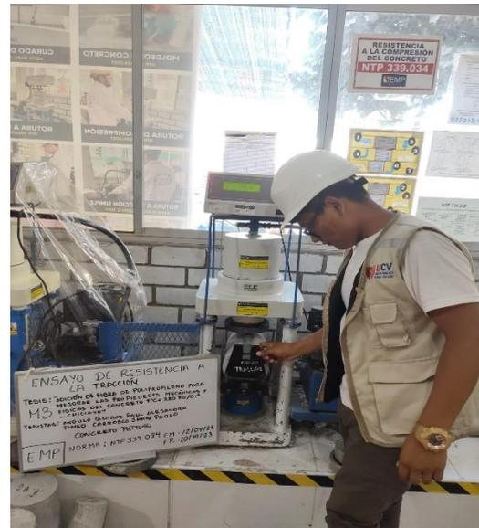
**Imagen N°119: CHICLAYO** Ensayo de resistencia a tracción, con adición de 2.5% de fibra a los 14 días de curado, 2023.
