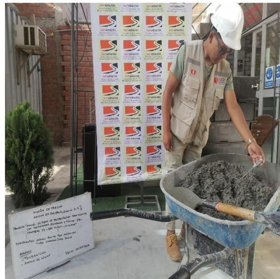
**Imagen N°49: CHICLAYO.** Ensayo de temperatura, adición de 1.5% fibra de polipropileno, 2023.
