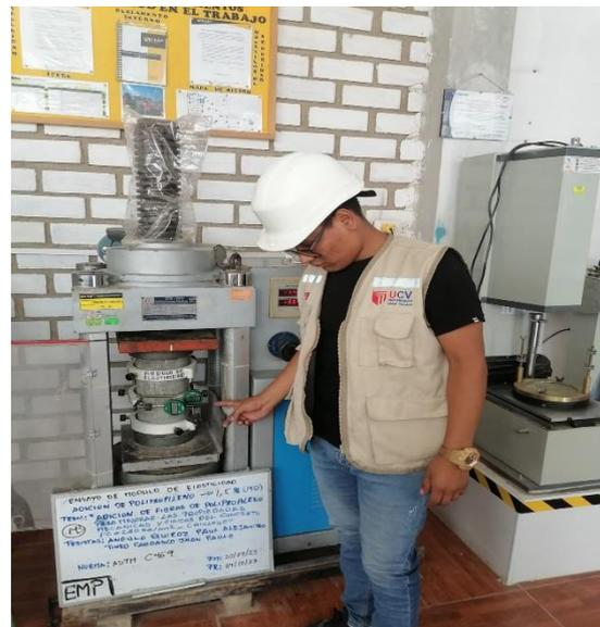
**Imagen N°109: CHICLAYO.** Ensayo de módulo de elasticidad, con adición de 1.5% de fibra a los 14 días de curado, 2023.
