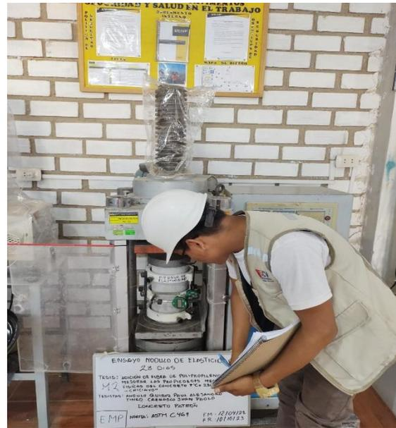
**Imagen N°101: CHICLAYO.** Ensayo de módulo de elasticidad, con adición de 0.9% de fibra a los 28 días de curado, 2023.
