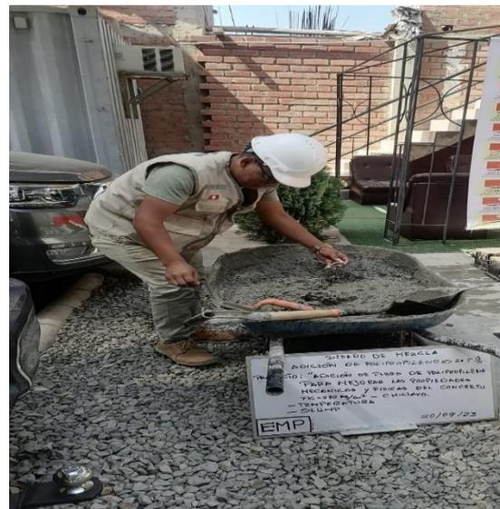
**Imagen N°57: CHICLAYO.** Ensayo de temperatura, adición de 2.5% fibra de polipropileno, 2023.
