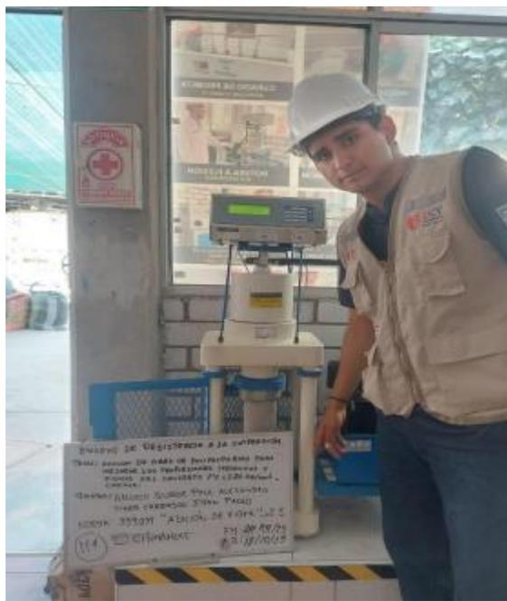
**Imagen N°122: CHICLAYO.** Ensayo de resistencia a compresión, con adición de 2.5% de fibra a los 28 días de curado, 2023.
