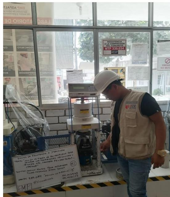
**Imagen N°107: CHICLAYO** Ensayo de resistencia a tracción, con adición de 1.5% de fibra a los 14 días de curado, 2023.
