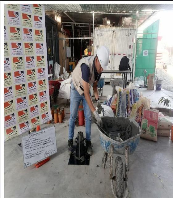
**Imagen N°31: CHICLAYO.** Ensayo de asentamiento (slump), adición de 0.3% fibra de polipropileno, 2023.
