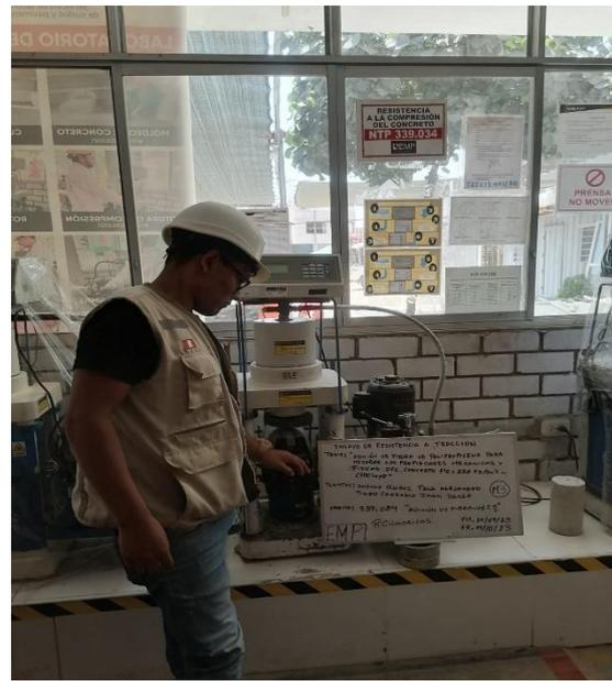
**Imagen N°115: CHICLAYO** Ensayo de resistencia a tracción, con adición de 2.5% de fibra a los 7 días de curado, 2023.
