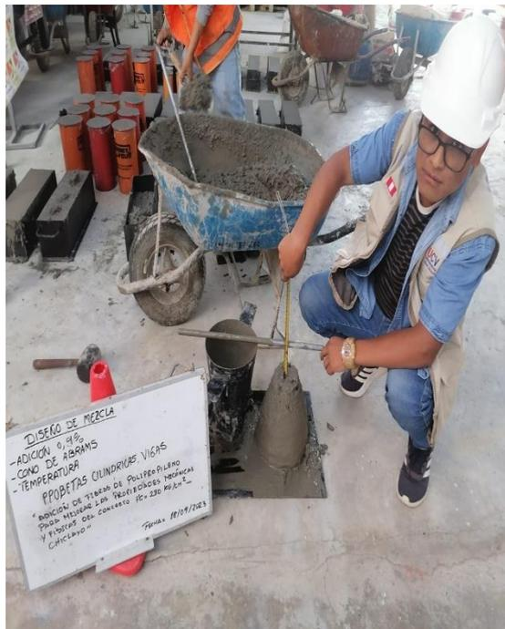
**Imagen N°38: CHICLAYO.** Ensayo de asentamiento (slump), adición de 0.9% fibra de polipropileno, 2023.
