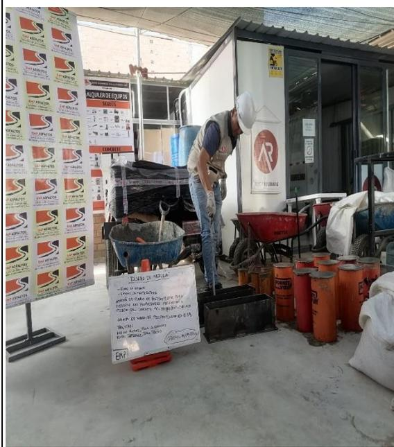
**Imagen N°35: CHICLAYO.** Elaboración de probetas, adición de 0.3% fibra de polipropileno, 2023.
