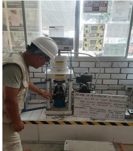
**Imagen N°67: CHICLAYO** Ensayo de resistencia a tracción, concreto patrón, a los 7 días de curado, 2023.
