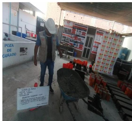
**Imagen N°41: CHICLAYO.** Ensayo de temperatura, adición de 0.9% fibra de polipropileno, 2023.
