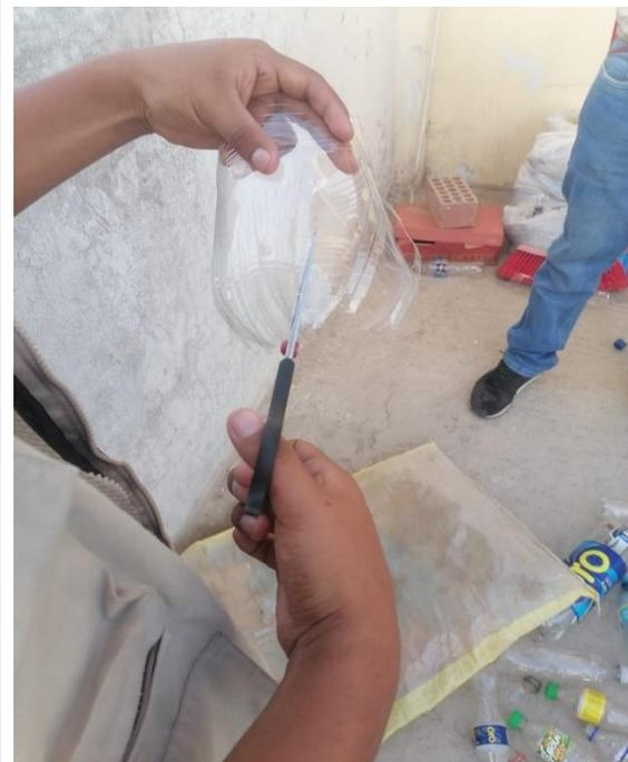
**Imagen N°21: CHICLAYO.** Obtención de la fibra de polipropileno, material reciclado, 2023.
