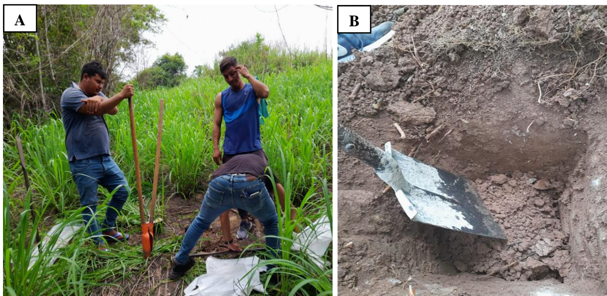
Figura 2. Apertura de calicatas
