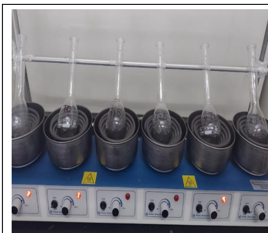
Figura 33: Digestión de los tratamientos de muestra UCV.
