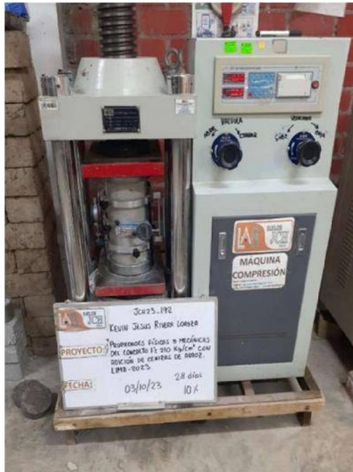
Foto 21. Ensayo de módulo de elasticidad al 15% de adición C.A.
