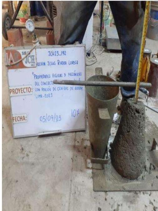
Foto 6. Ensayo de slump al 10% de adición de C.A.
