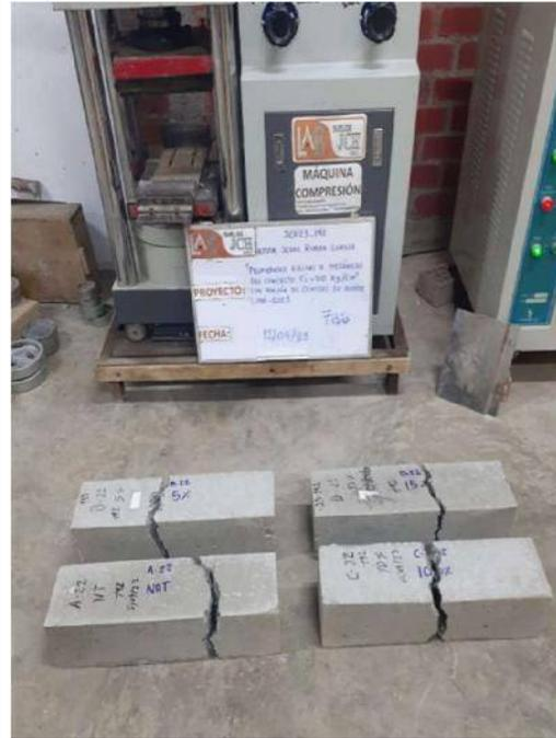
Foto 18. Ensayo de módulo de elasticidad al 0% de adición C.A.
