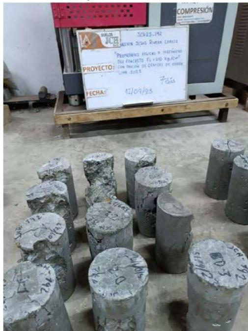
Foto 23. Ensayos de tracción al 0%, 10% y 15% de adición C.A.
