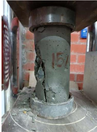
**Ensayo de Resistencia a Tracción**
