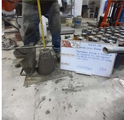
La imagen ilustra el ensayo de trabajabilidad de las muestras con adiciones del 15% de cenizas de arroz (CA)
