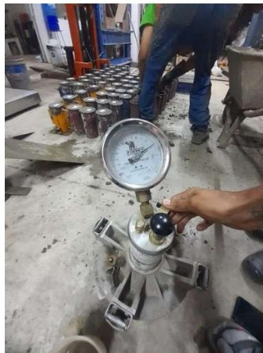
En la visualización, se destaca claramente la ejecución de los ensayos de contenidos de aire, un procedimiento que permiten determinar las cantidades de aire presentes en la muestra. Este análisis es esencial para comprender y controlar las propiedades del concreto, particularmente cuando se considera unas adiciones del 5% de cenizas de arroz (CA) en la mezcla
