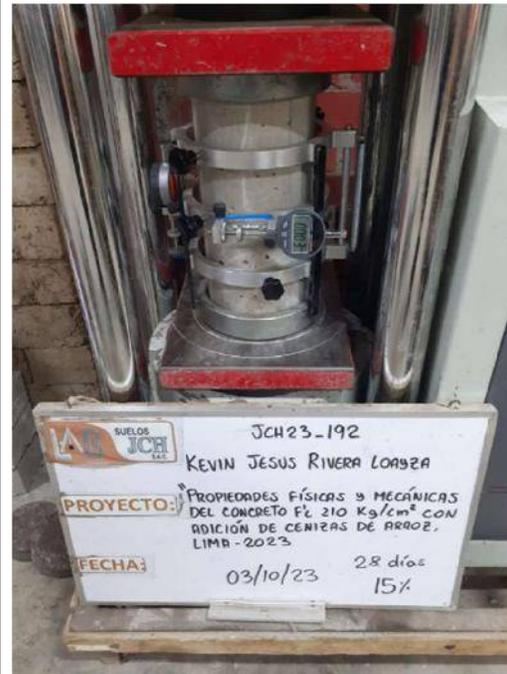
Foto 22. Ensayos de compresión al 0%, 10% y 15% de adición C.A.
