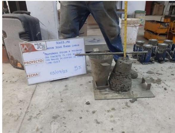
La imagen ilustra el ensayo de trabajabilidad de las muestras con adiciones del 5% de cenizas de arroz (CA)
