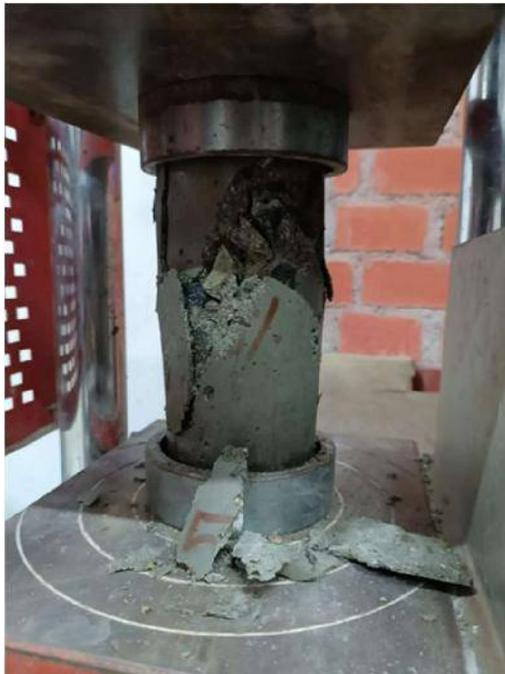
Foto 15. Ensayo de compresión con adición al 10% de C.A
