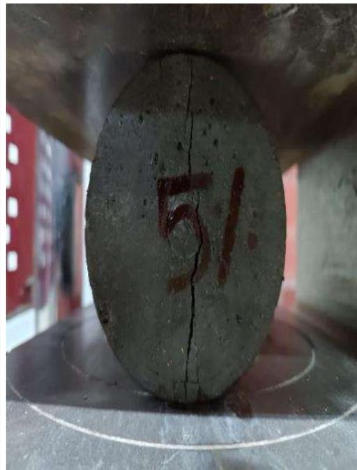
Foto 12. Ensayo de tracción con adición al 10% de C.A
