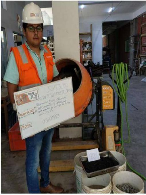
Foto 3. Dosificación de componentes al 15% de adición de C.A.
