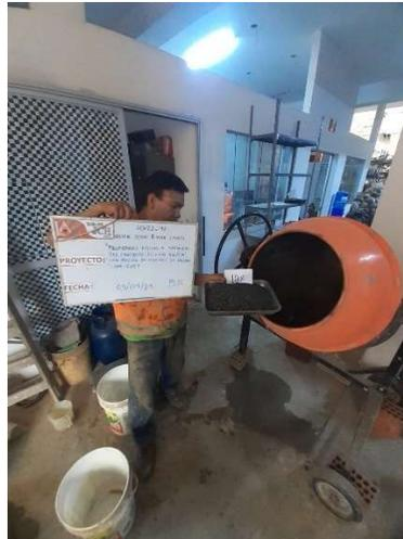
**Figura 20.** Mezcla de Materiales al 15% de Ceniza de Arroz
