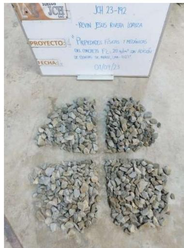
Los AG. son partículas de materiales pétreos que varían en tamaño y se emplean en las mezclas de concretos para beneficiar resistencias estructurales. Estos suelen consistir en rocas trituradas, grava o piedra triturada con tamaños que van desde 5 mm hasta 50 mm de diámetro. Su fundamental función es mejorar la resistencia y durabilidad del concreto, ya que contribuyen a llenar el espacio entre las partículas de cemento y proporcionan una estructura robusta a la mezcla.
