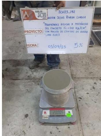
La imagen presenta el ensayo de peso unitario con las adiciones del 5% de cenizas de arroz (CA).
