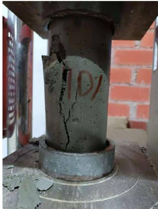
Foto 16. Ensayo de compresión con adición al 15% de C.A
