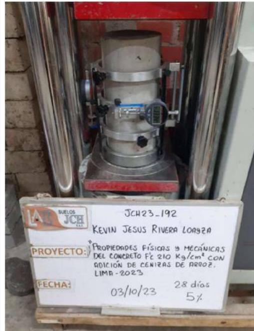
Foto 20. Ensayo de módulo de elasticidad al 10% de adición C.A.
