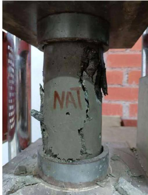
Foto 14. Ensayo de compresión con adición al 5% de C.A
