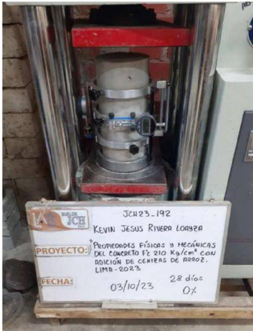
Foto 19. Ensayo de módulo de elasticidad al 5% de adición C.A.
