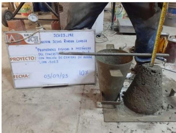
La imagen ilustra el ensayo de trabajabilidad de las muestras con adiciones del 10% de cenizas de arroz (CA)
