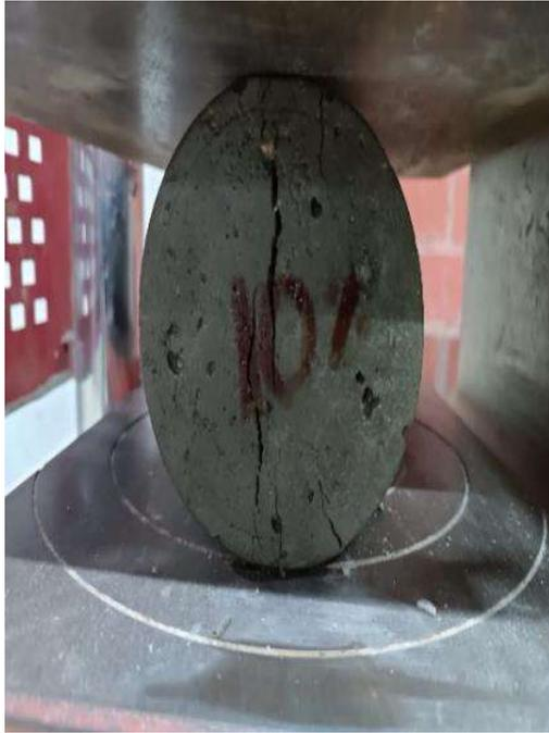
Foto 13. Ensayo de compresión con adición al 0% de C.A
