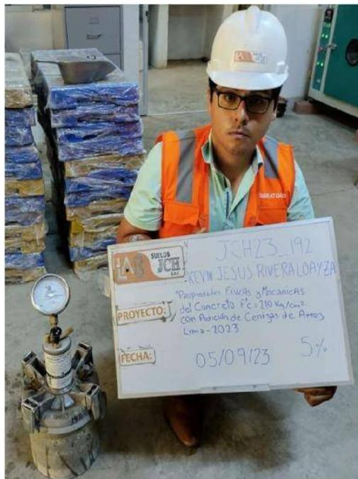
Foto 8. Ensayo para determinación del contenido de aire al 15% de adición de C.A.
