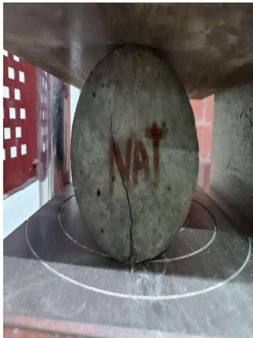
Foto 11. Ensayo de tracción con adición al 5% de C.A
