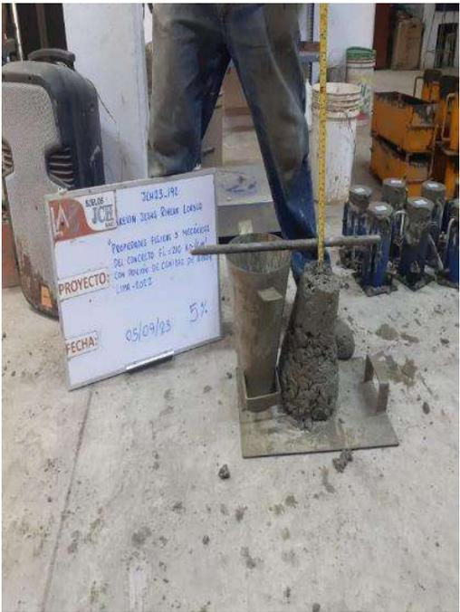
Foto 5. Ensayo de slump al 10% de adición de C.A.
