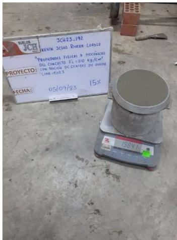
La imagen presenta el ensayo de peso unitario con las adiciones del 15% de cenizas de arroz (CA).
