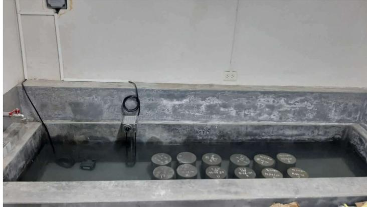
**Figura 24.** *Curado de especímenes Rectangulares*
