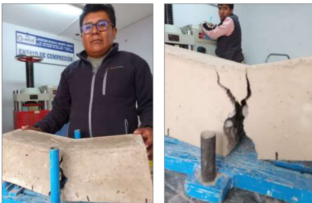
Figura N° 43: Detalle de fractura en tercio central
