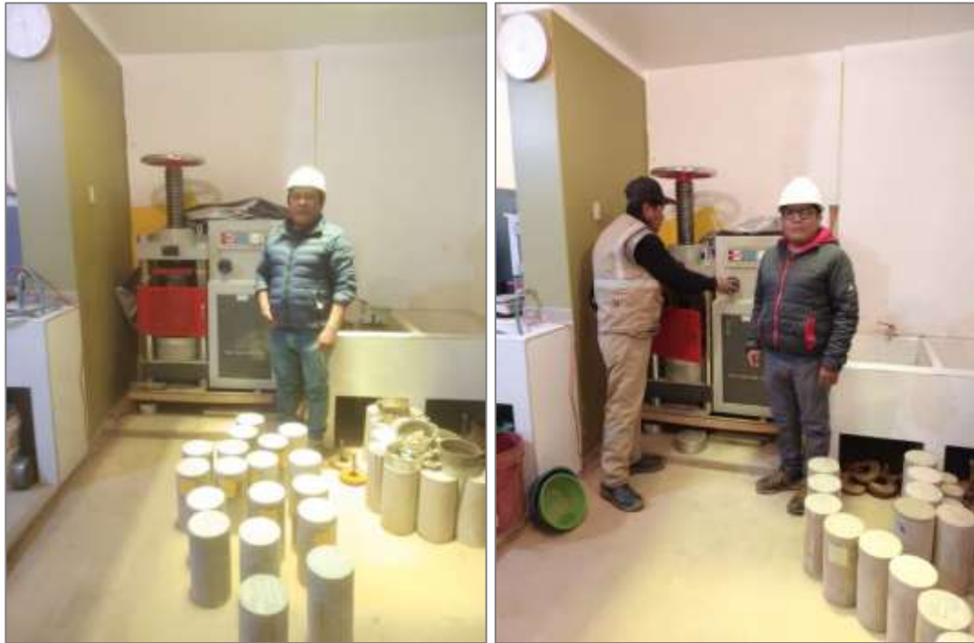
Figura N° 37: Rotura de Probetas
