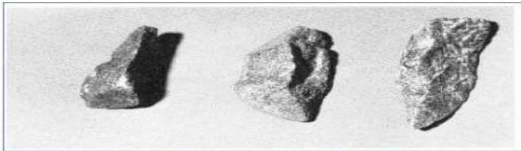
Figura N° 20: Partículas Fracturadas (Bordes Agudos, Superficies Rugosas)
