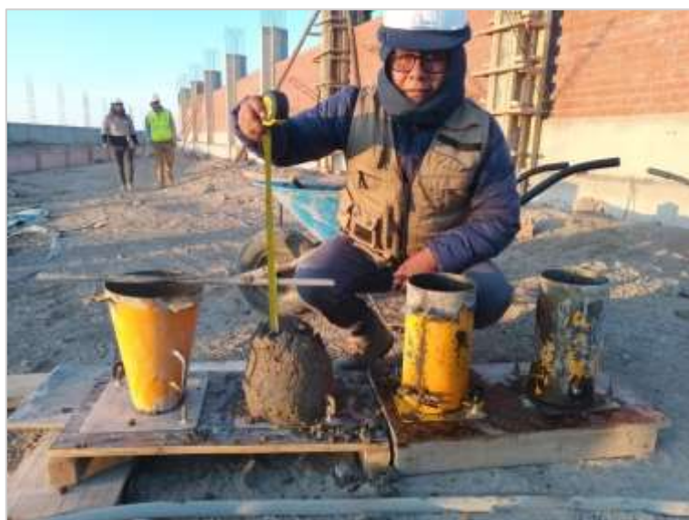
Figura N° 32: Medición de Slump – 80% Partículas Fracturada
