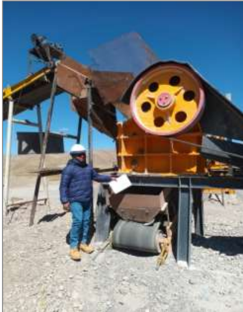
Figura N° 11: Trituradora Tipo Mandíbula (Modelo PE 250x400 Capacidad 20 Tn/h Fuente: Elaboración propia
