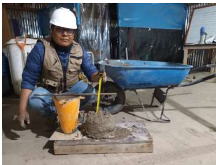
Figura N° 33: Medición de Slump – 70 % Partículas Fracturada
