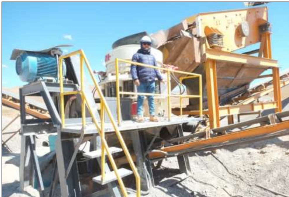
Figura N° 13: Trituradora de Cono (Modelo SYMONS PSGB – 0917 cap.59 – 163Tn/h)
