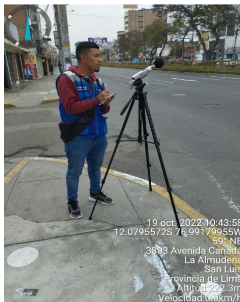
Figura 15: PMR2 Punto de monitoreo ambiental 2 Cruce entre la Av. Canadá y el Jirón Los Rosales, se muestra donde se ubicó el sonómetro.
