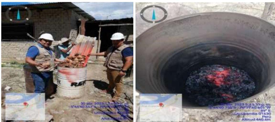
Figura 11. Colocación de cascara de coco en cilindros y calcinación
