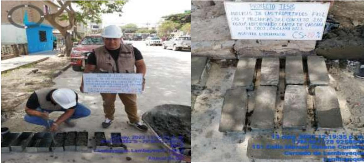
Figura 22. Obtención de 09 Muestras experimentales con 20% de Ceniza de cascara de coco
