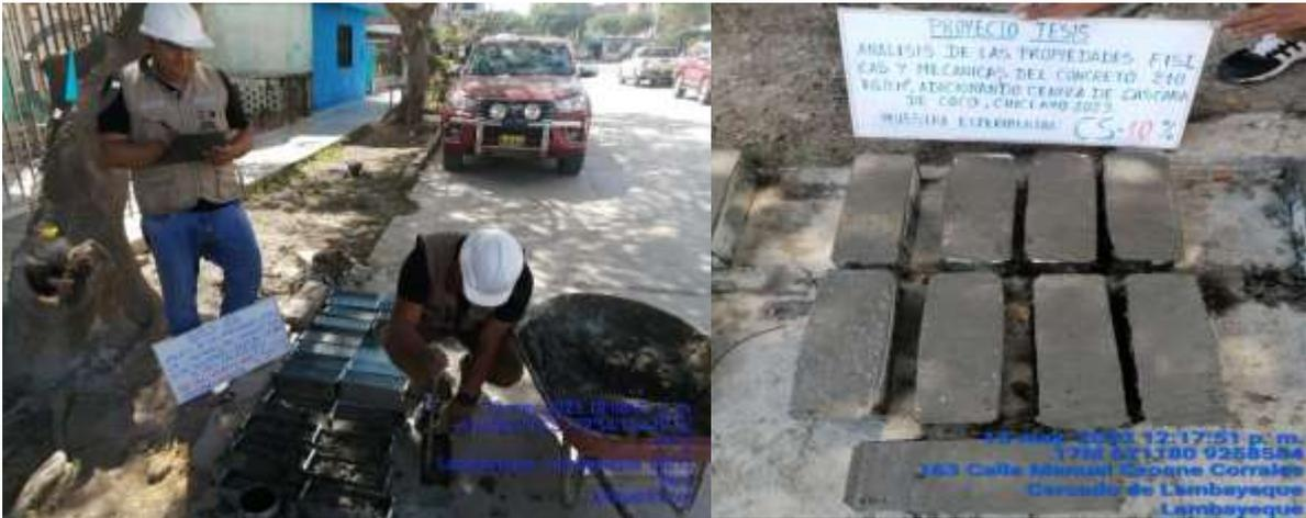
Figura 20. Obtención de 09 Muestras experimentales con 20% de Ceniza de cascara de coco
