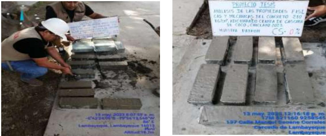
Figura 18. Obtención de 9 muestras patrón de resistencia  $f_c=210\text{kg/cm}^2$
