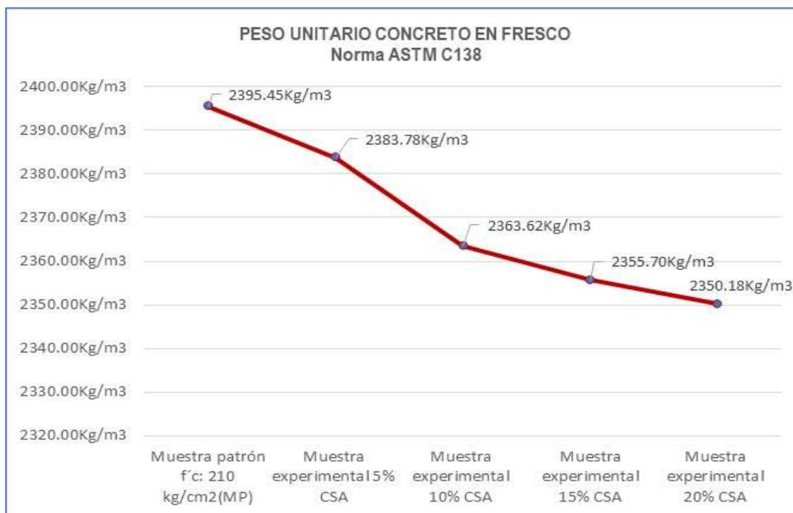
Figura 29. Grafica con respecto a la variación del peso unitario del C°(concreto) en fresco según tipo de muestra.
