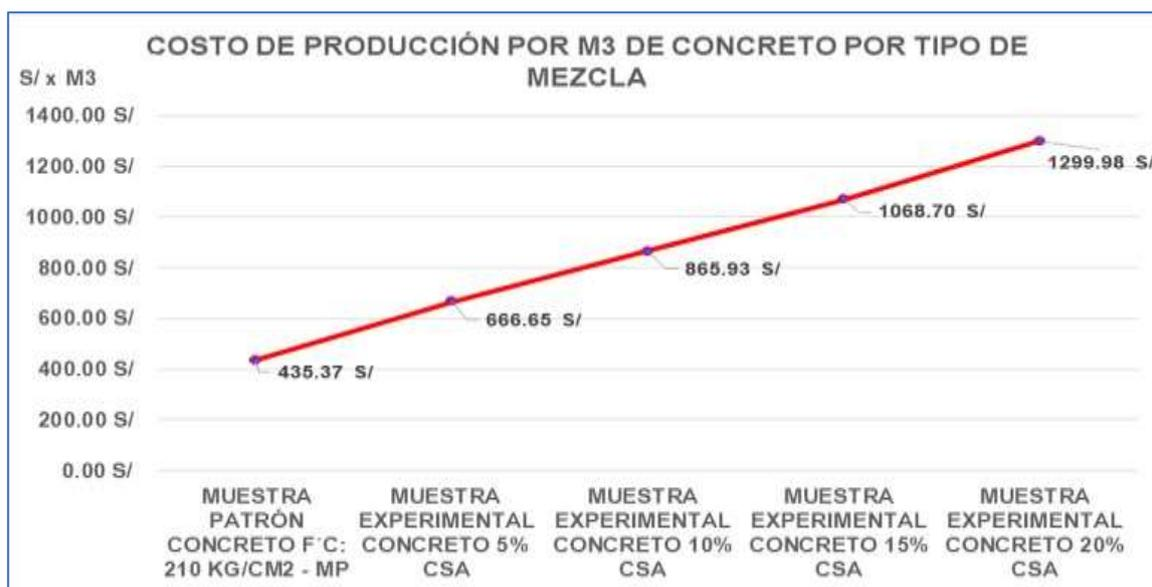
*Figura 35.* Tendencias de analizar los costos unitarios en la producción de la MP 210 kg/cm<sup>2</sup>, ME CSA5%, ME CSA10%, ME CSA15% y ME CSA20%.
