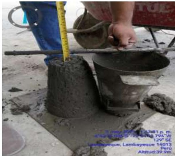
Figura 27. Trabajabilidad del concreto de la muestra experimental al 20% de ceniza de cascara de coco
