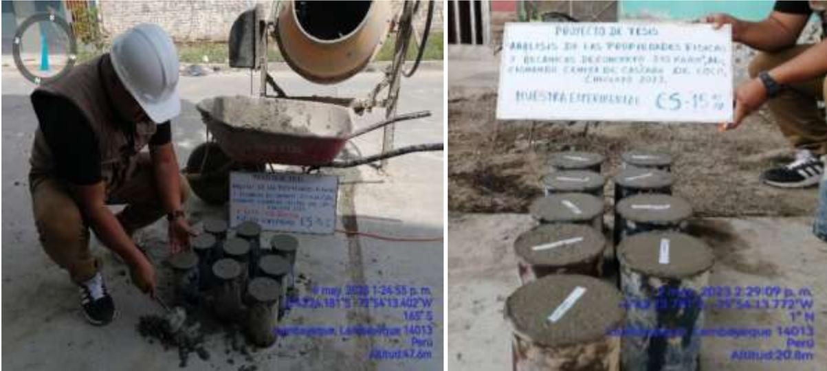
Figura 16. Obtención de 09 Muestras experimentales con 15% de Ceniza de cascara de coco
