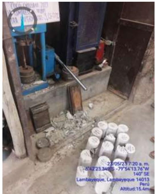
ROTURA DE MUESTRA PATRON - RESISTENCIA A LA COMPRESION 28 DIAS
