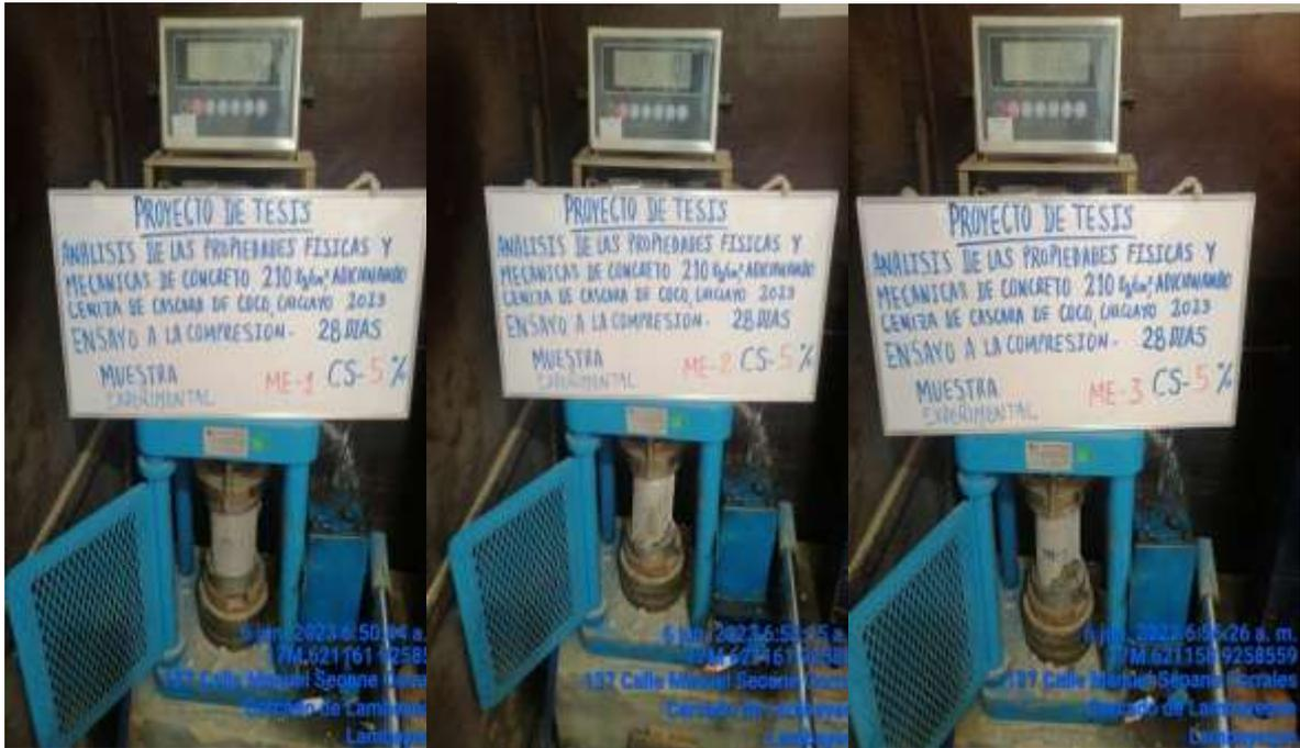
ROTURA MUESTRA EXPERIMENTAL - RESISTENCIA COMPRESION 10% CS – 28 DIAS
