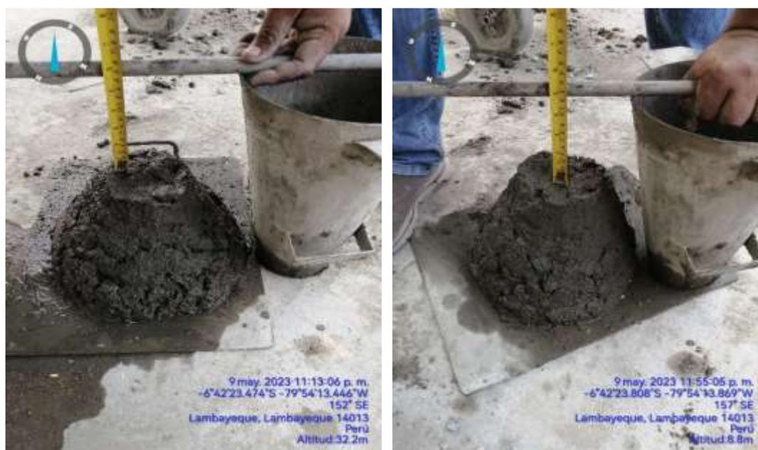
*Figura 25.* Trabajabilidad del concreto de la muestra patrón y muestra experimental al 5% de ceniza de cascara de coco
