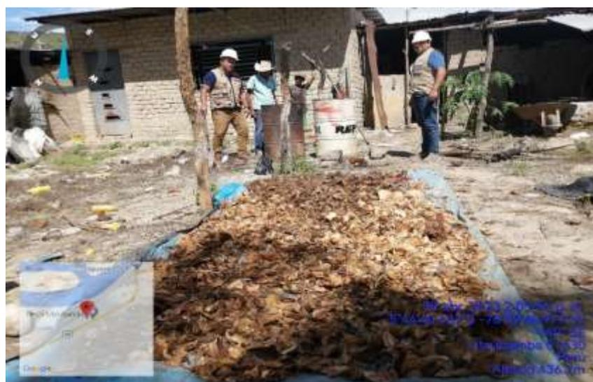
*Figura 09. Cascara de coco seleccionada y triturada*
