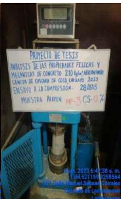
ROTURA MUESTRA EXPERIMENTAL - RESISTENCIA COMPRESION 05% CS – 28 DIAS
