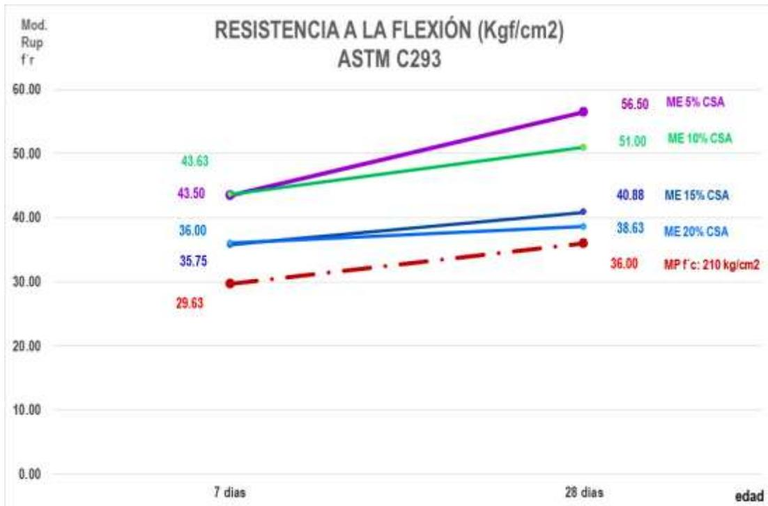
Figura 33. Grafica de las curvas del módulo de ruptura en el ensayo de la resistencia a la flexión por tipo de mezcla y probeta 7 y 28 días.
