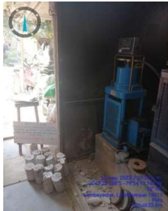
ROTURA DE MUESTRA PATRON - RESISTENCIA A LA COMPRESION 14 DIAS
