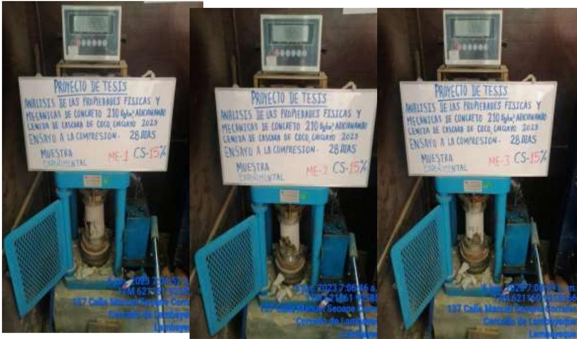
ROTURA MUESTRA EXPERIMENTAL - RESISTENCIA COMPRESION 20% CS – 28 DIAS
