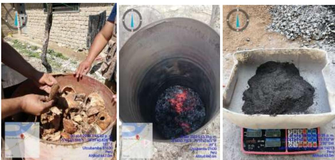
Figura 03. Proceso de obtención de la ceniza de cascara de coco
