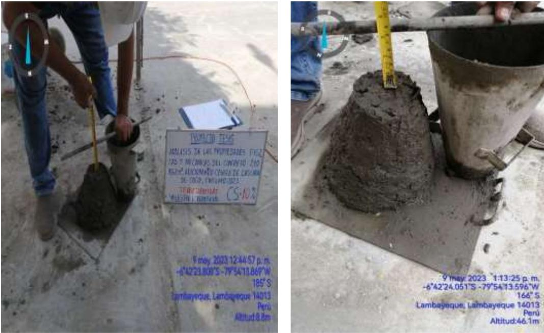
Figura 26. Trabajabilidad del concreto de la muestra experimental al 10% y 15% de ceniza de cascara de coco
