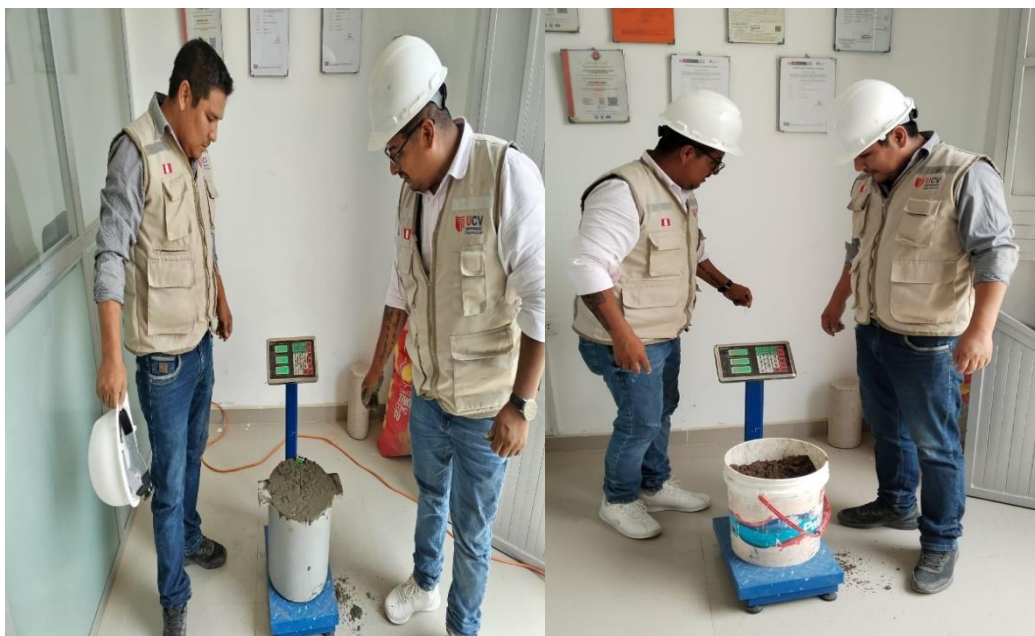
Figura 12. Cálculo de peso unitario y asentamiento
