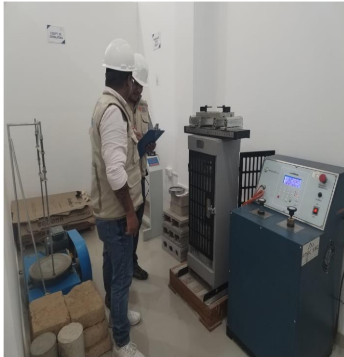
Figura 13. Ensayo resistencia de la compresión del concreto.
