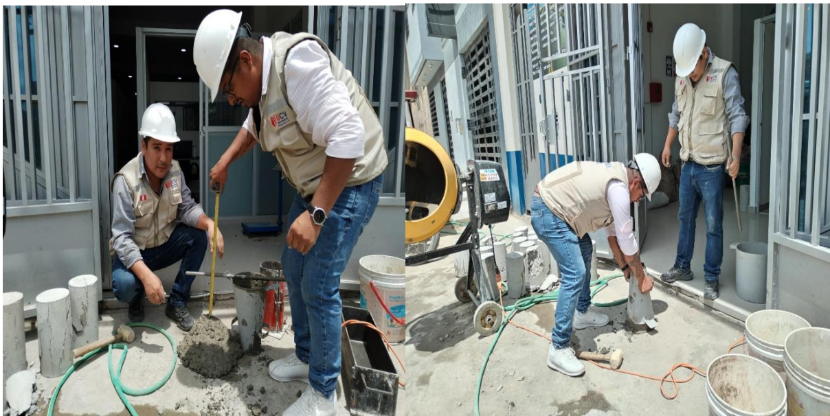
Figura 11. trabajabilidad del concreto fresco
