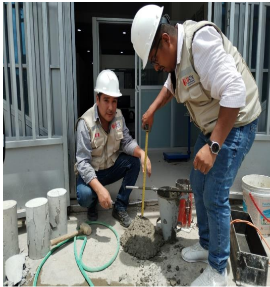
Figura 2. Trabajabilidad del concreto.
