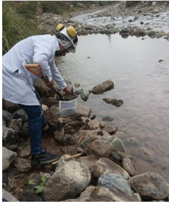
Figura 9. Vaciado de suelo en bolsas de membrana plástica
