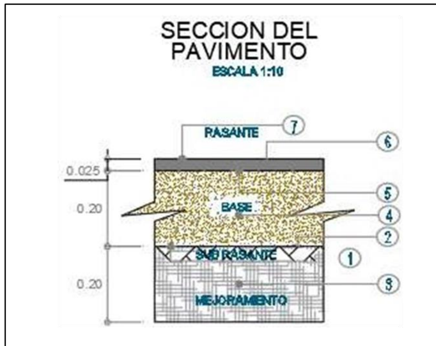
Figura 5. Sección del pavimento flexible
