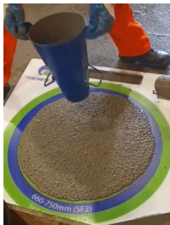
Figura 6. Ensayo de flujo del concreto auto compactante.
