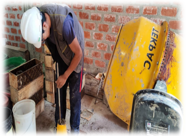
Figura09: Llenado de briquetas.
