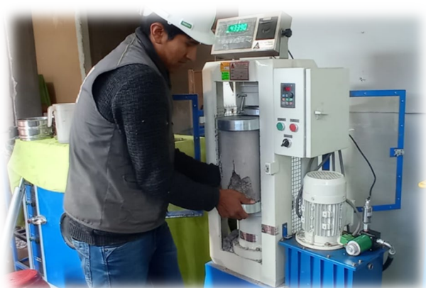
Figura22: .Rotura de especímenes cilíndricas a compresión.
