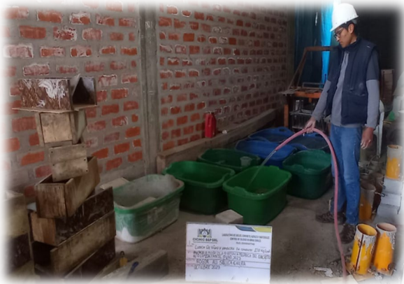
Figura19: Hidratación de especímenes.
