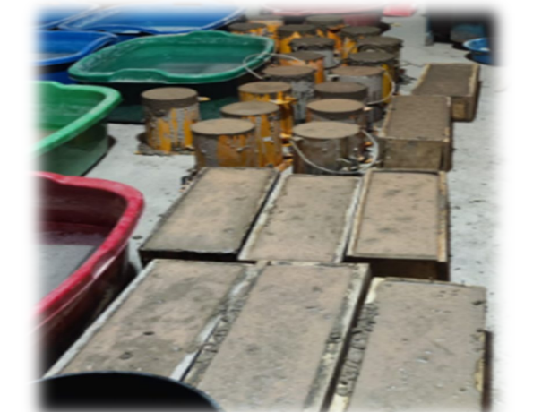
Figura11: Llenado de vigas.
