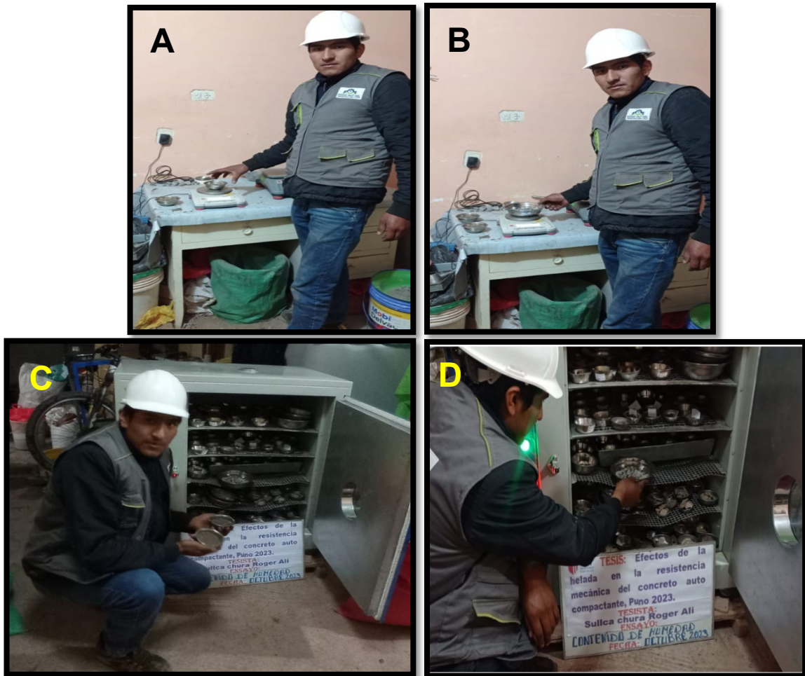
Figura 15 . Porcentaje de humedad del agregado fino y grueso.
