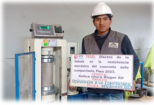
Figura21: .Rotura de especímenes cilíndricas a compresión.
