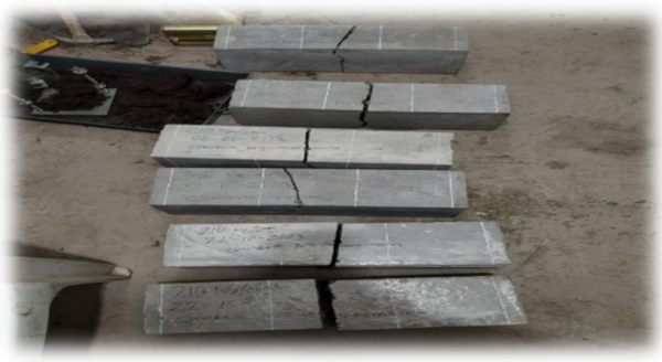
Figura24: .Rotura de especímenes viga a flexión.
