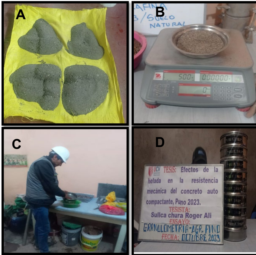
Figura 13 .Evaluación del tamaño de partículas en el árido fino.
