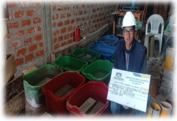
Figura20: .Hidratación de especímenes.
