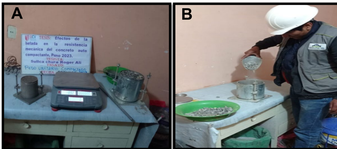
Figura 18 .Peso Volumétrico Suelto de Agregado Fino y Grueso.
