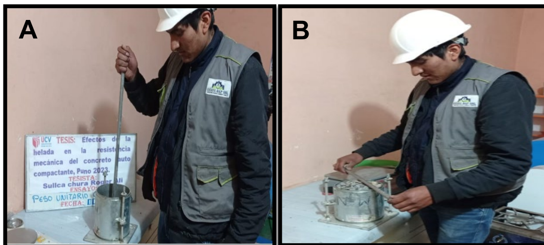
Figura 19 . Peso Volumétrico varillado de Agregado Fino y Grueso.
