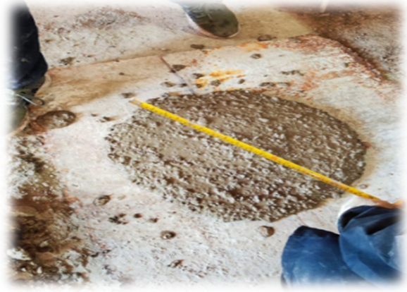
Figura08: Toma de medición de diámetro.
