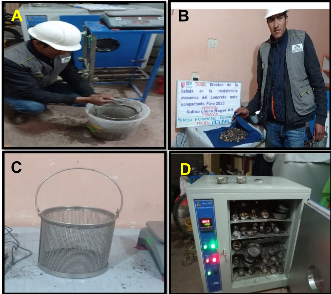
Figura 17 . Peso Específico y Absorción del agregado grueso
