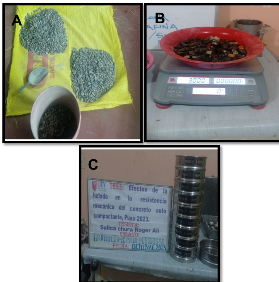
Figura 14 . Análisis granulométrico del agregado grueso.
