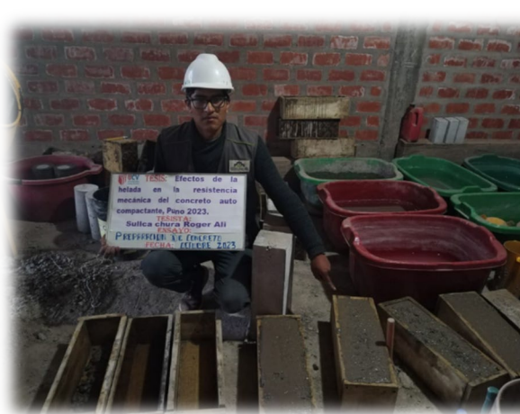
Figura12: Desencofrado de vigas.
