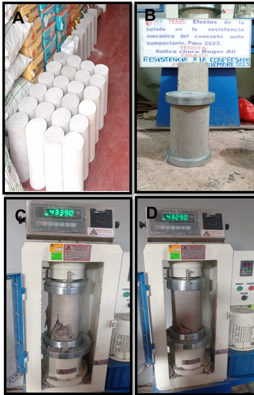
Figura 25 . Ensayo a la compresión.
