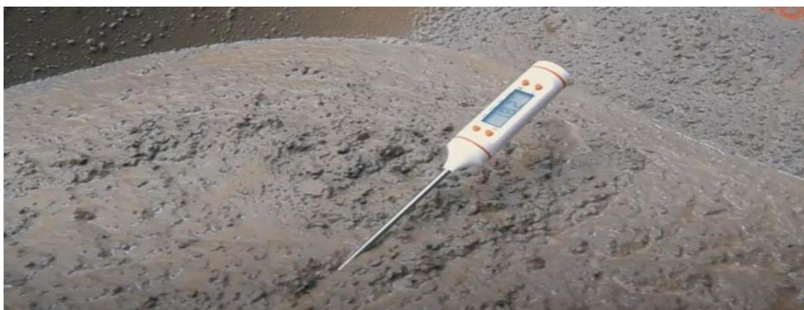
**Figura 6.** Ensayo de temperatura
