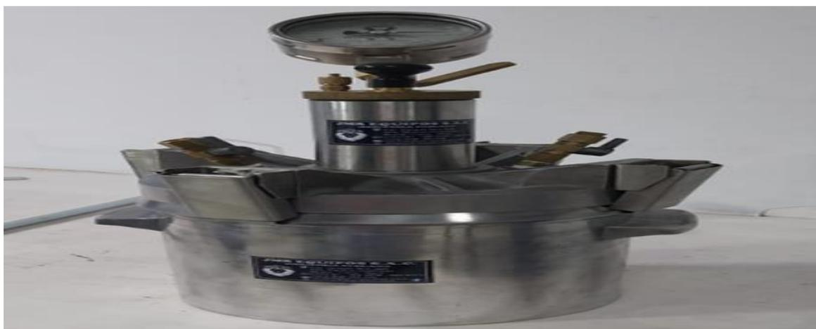
**Figura 5.** Ensayo contenido de aire (Olla de Washington)
