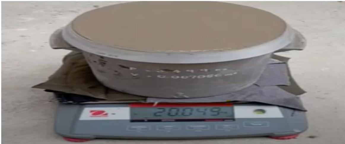
**Figura 7.** Ensayo de densidad (bascula)
