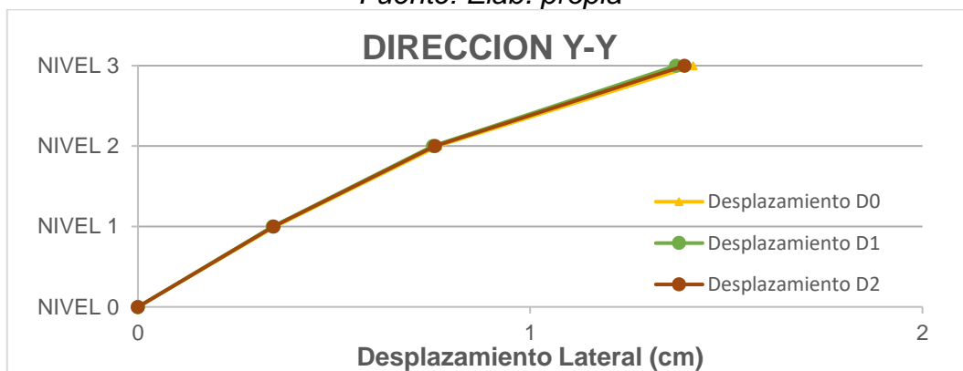
Figura N°78 Valores del análisis del desplazamiento con la D0=0% CV, D1=25% CV y D2=30% CV en dirección Y-Y
