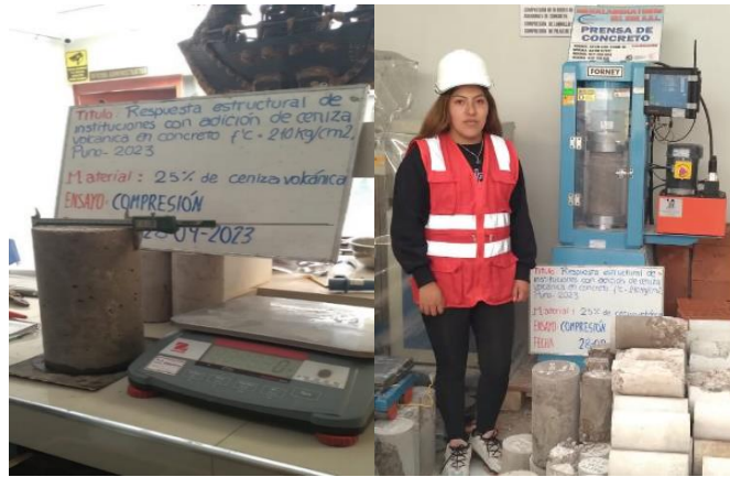
Figura N°28 Rotura de espécimen con adición del 25% CV
