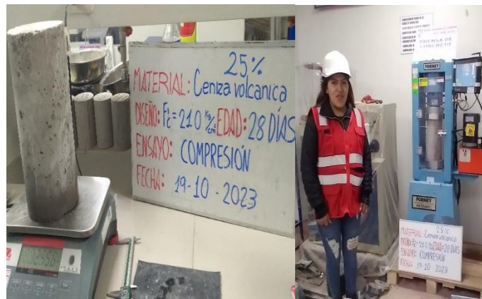
Figura N°40 Rotura de espécimen con adición del 25% de CV
