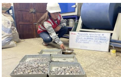
Figura N°12 Granulometría de la piedra chancada
