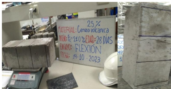
Figura N°41 Rotura de la viga con adición del 25% de ceniza volcánica
