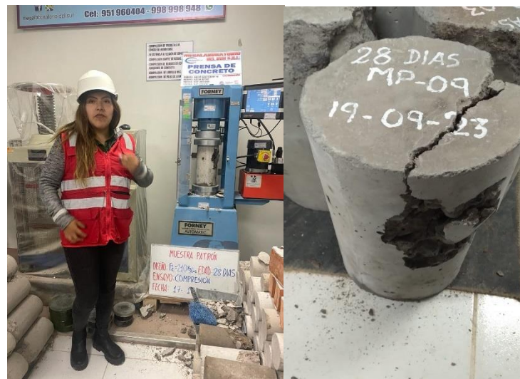
Figura N°38 Rotura de espécimen con adición del 25% de CV
