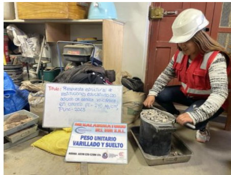
Figura N°14 Ensayo de peso unitario varillado y suelto- piedra chancada
