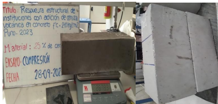
Figura N°29 Rotura de la viga con adición del 25% CV
