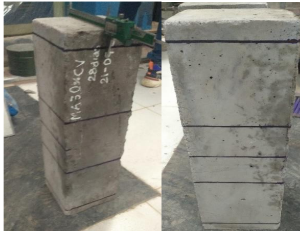
Figura N°43 Rotura de la viga con adición del 30% de ceniza volcánica
