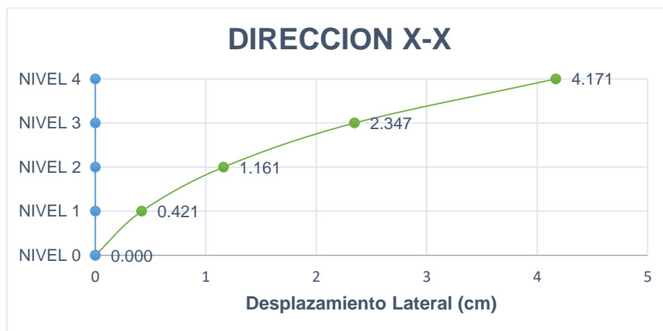
Figura N°73 Desplazamiento lateral (cm) en dirección X-X respecto a D2
