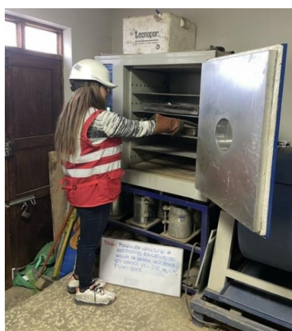
Figura N°11 Secado de la piedra chancada
