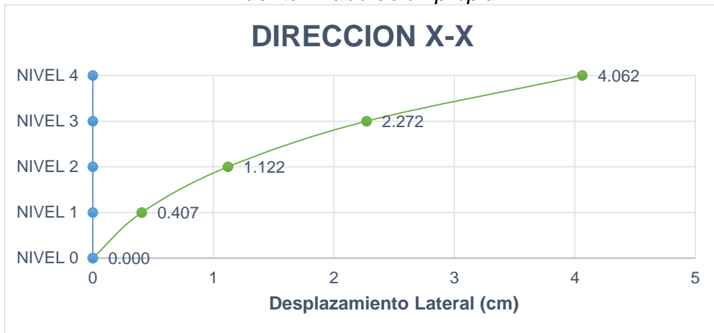
Figura N°71 Desplazamiento lateral (cm) en dirección X-X respecto a D1
