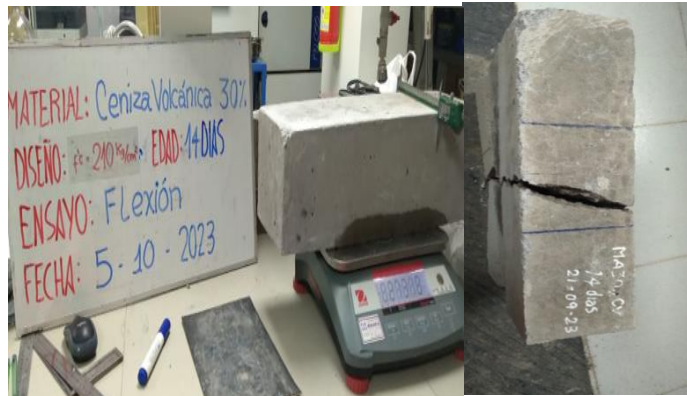
Figura N°37 Rotura de la viga con adición del 25% de CV
