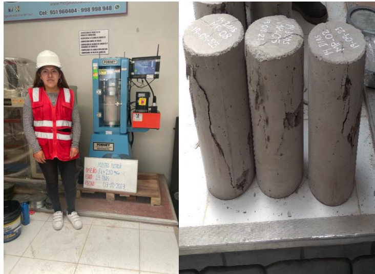
Figura N°32 Rotura de espécimen con adición del 25% de ceniza volcánica
