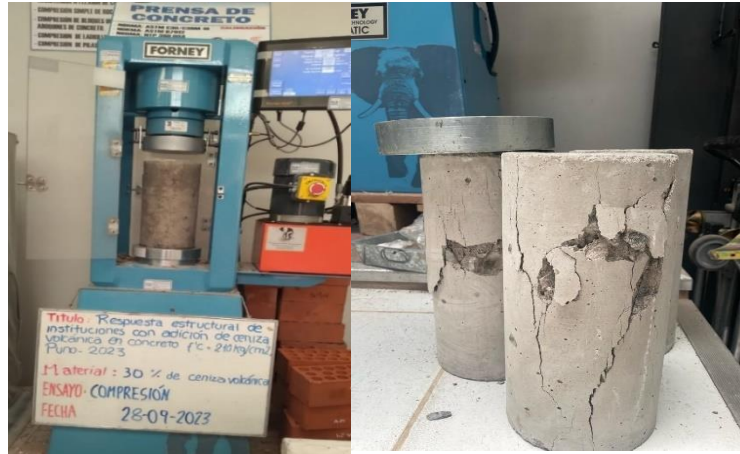
Figura N°30 Rotura de espécimen (adición del 30% CV)
