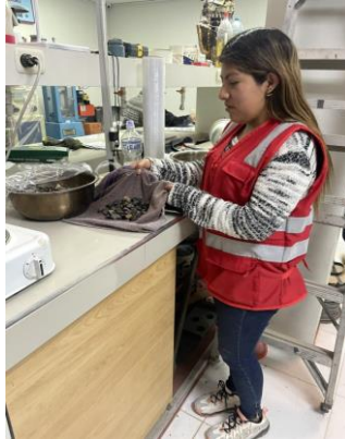
Figura N°15 Proceso de secado y pesado - piedra chancada
