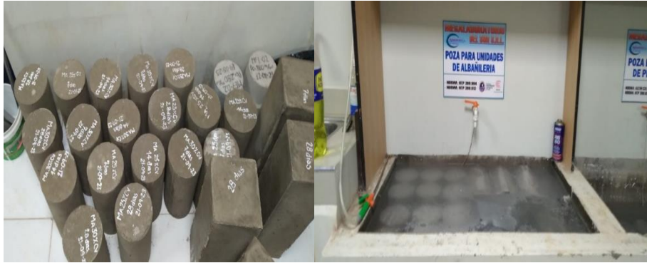
Figura N°25 Etiquetado y curado de las muestras elaboradas
