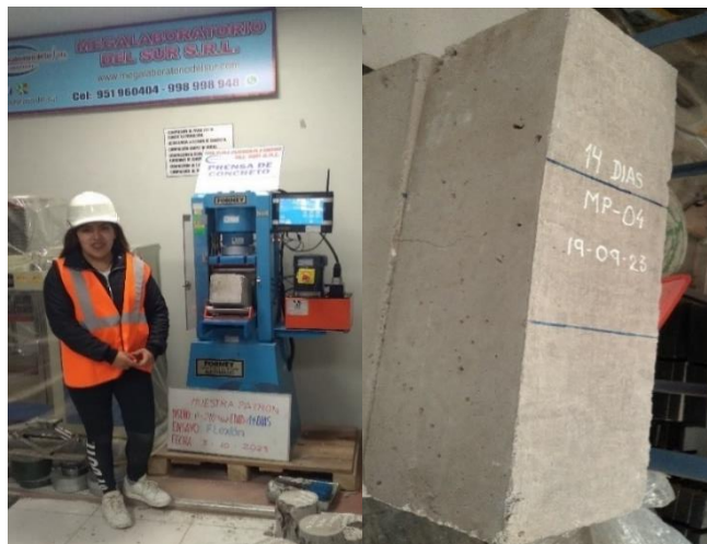
Figura N°33 Rotura de la viga con adición del 25% de ceniza volcánica
