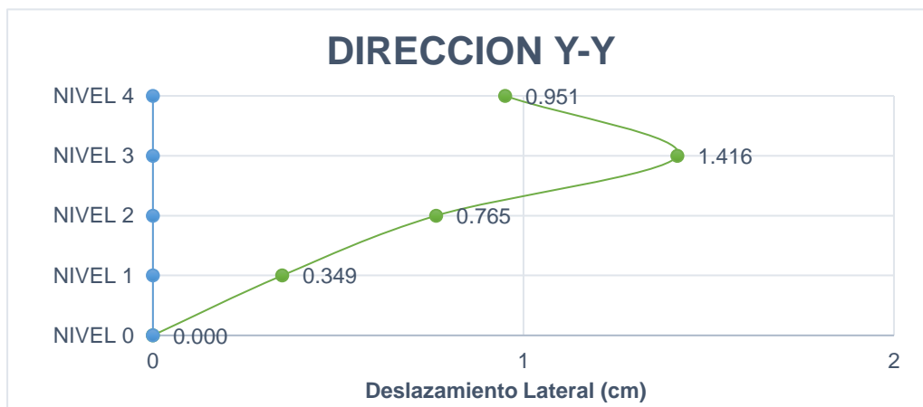
Figura N°70 Desplazamiento inelástico (cm) en la dirección Y-Y respecto de D0
