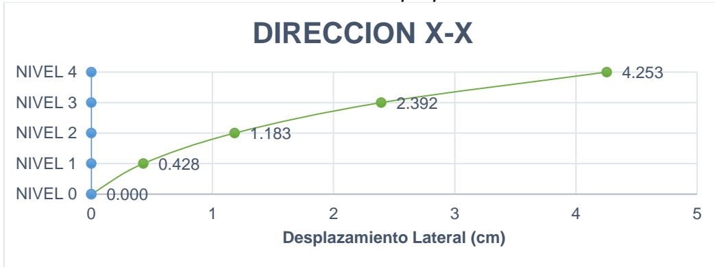
Figura N°69 Desplazamiento inelástico (cm) en la dirección X-X respecto de D0
