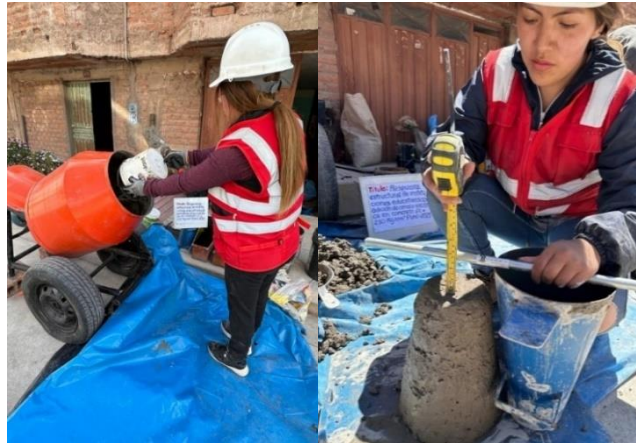
Figura N°22 Elaboración de mezcla y cono de Abrahms
