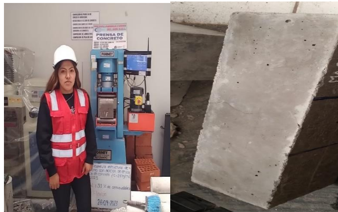
Figura N°31 Rotura de vigas (adición del 30% de ceniza volcánica)
