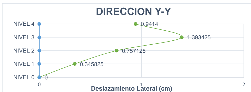
Figura N°74 Desplazamiento lateral (cm) en dirección Y-Y respecto a D2
