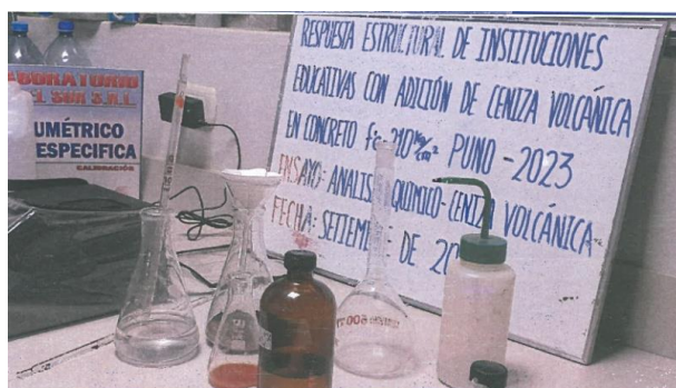
Figura N°10 Ensayo físico químico de la puzolana natural
