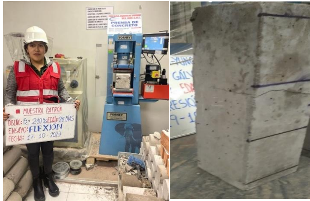
Figura N°39 Rotura de la viga (diseño patrón)
