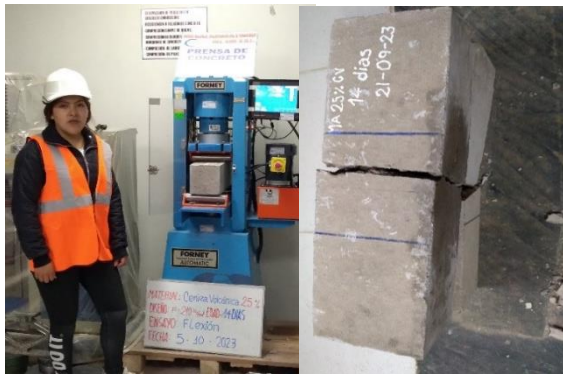
Figura N°35 Rotura de la viga con adición del 25% de CV
