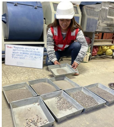
Figura N°17 Proceso de tamizado y pesado -arena fina
