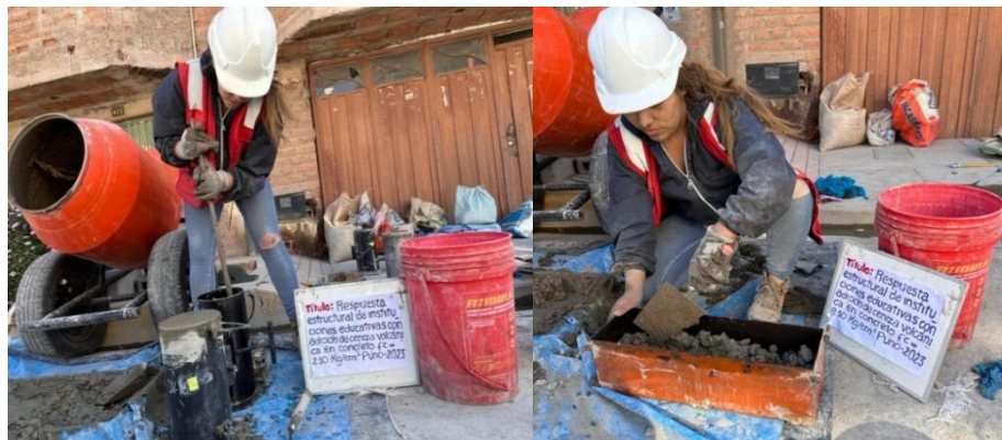
Figura N°23 Elaboración de especímenes cilíndricos y vigas
