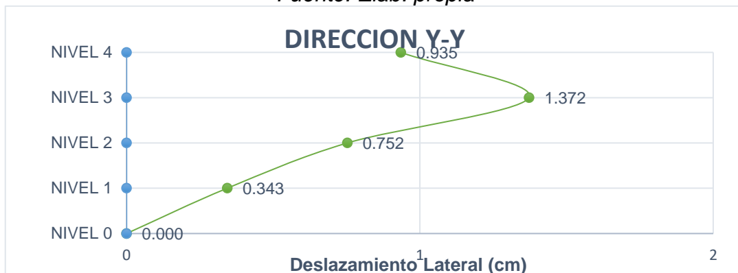
Figura N°72 Desplazamiento lateral (cm) en dirección Y-Y respecto a D1
