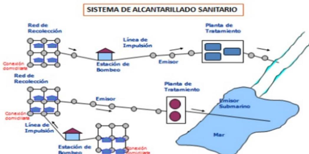
esquema típico de un sistema de alcantarillado sanitario
