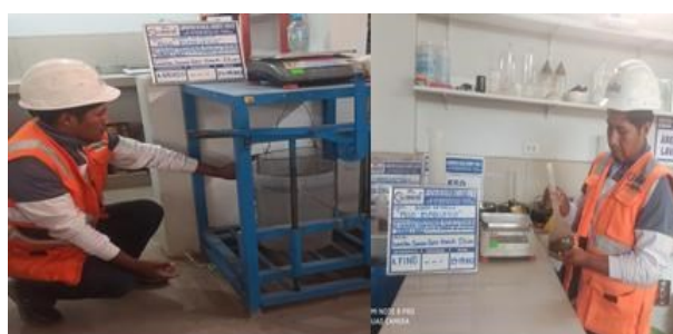
Figura 11. Saturación con agua de agregados gruesos y finos
