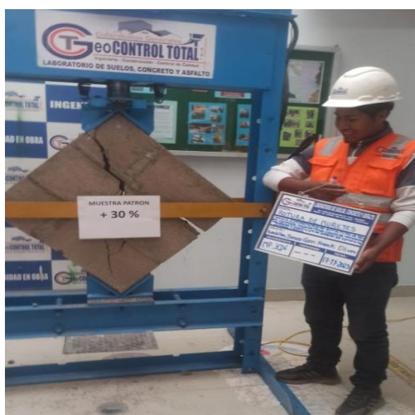
Figura 27. Ensayo de resistencia en muretes
