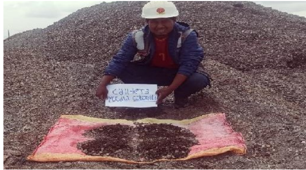
Figura 6. Cuarteo muestra agregados
