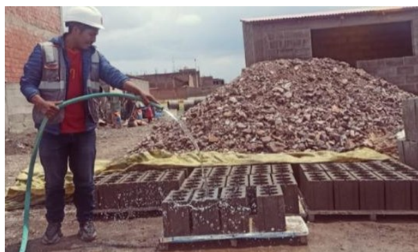
Figura 21. Curado de especímenes de bloques
