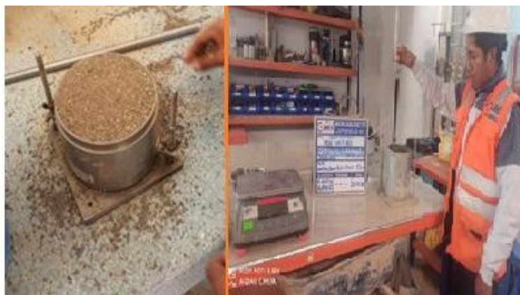
Figura 12. Varillado y enrasado de agregados
