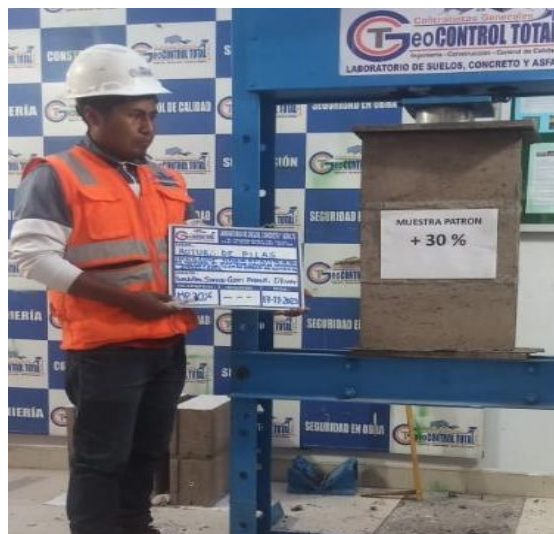
Figura 26. Ensayo de resistencia en pilas
