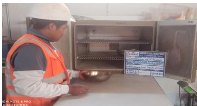
Figura 10. Secado de agregados en estufa
