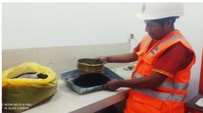
Figura 17. Separación del caucho de neumáticos por tamiz N° 4
