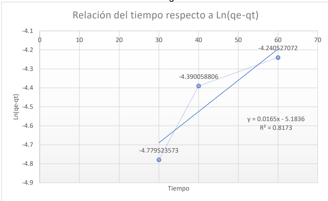
Figura 3: Determinación de la constante cinética con la concentración de Cd de 4mg/l
