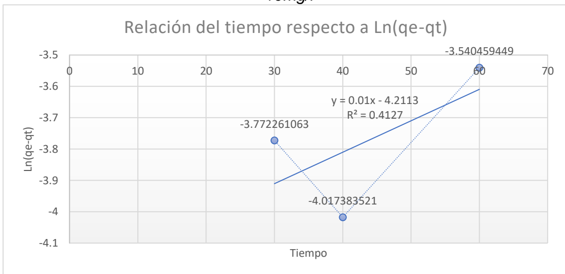
Figura 6: Determinación de la constante cinética con la concentración de Cd de 10mg/l
