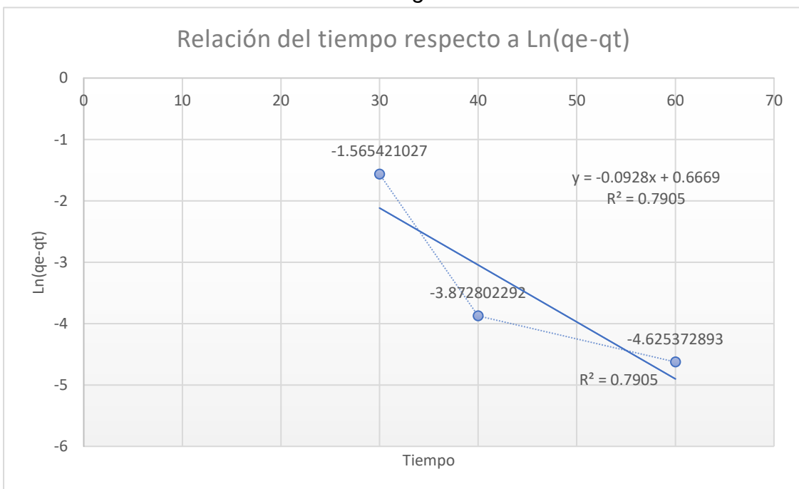
Figura 4: Determinación de la constante cinética con la concentración de Cd de 6mg/l
