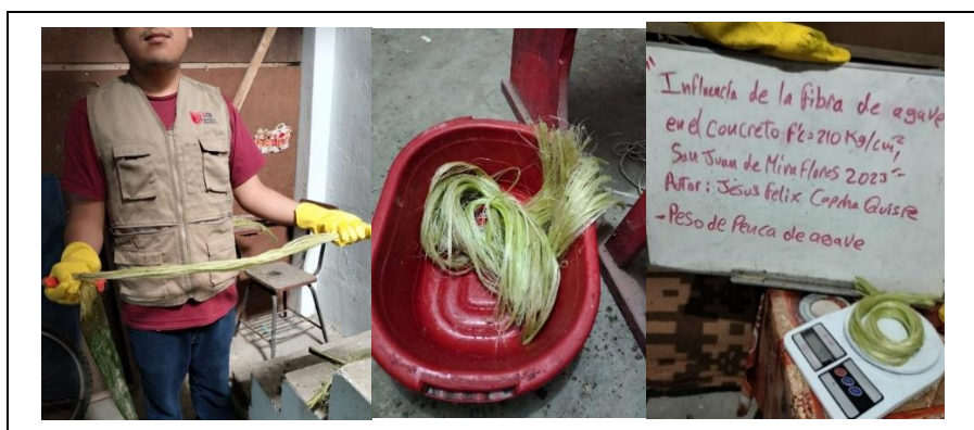
Figura 8: Obtención de fibra de agave de las áreas verdes de El Pacifico – San Juan de Miraflores.
