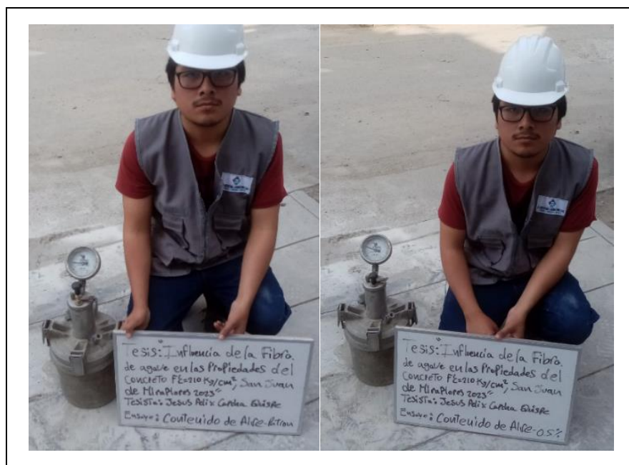
Figura 22: Elaboración del ensayo de contenido de aire por el ASTM C231
