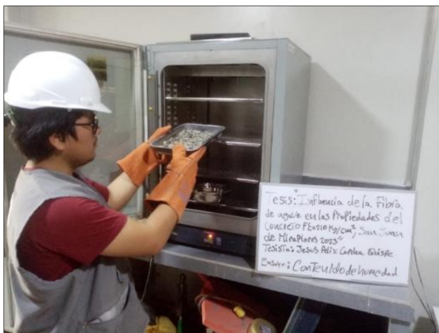
Figura 14: Desarrollo del ensayo de contenido de humedad
