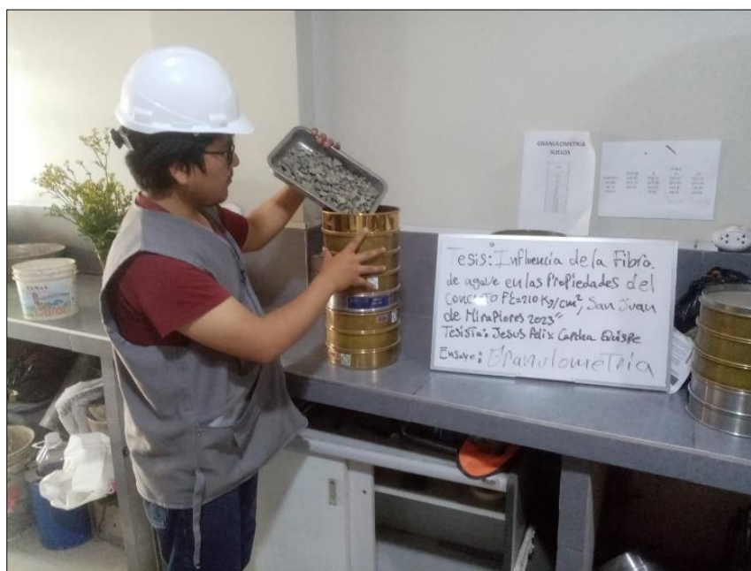
Figura 13: Elaboración de granulometría (agregado grueso)
