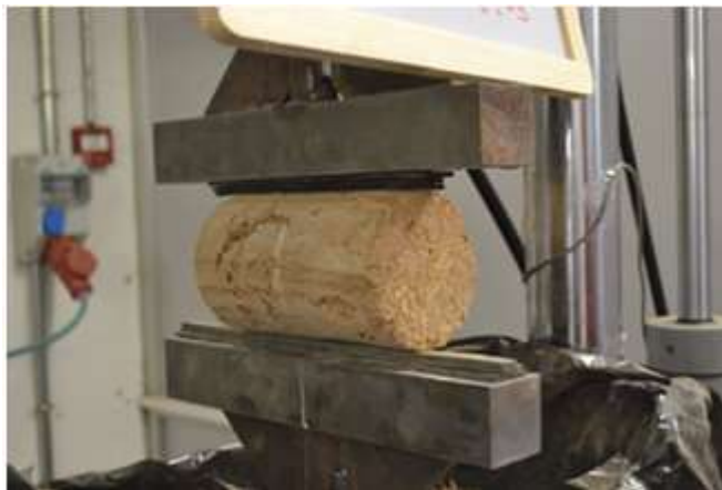
Figura 8. Prueba de resistencia a tracción en probetas de tierra
