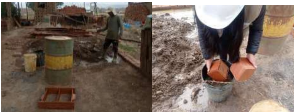
Figura 15. Moldes para los adobes y cubos.
