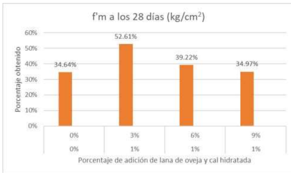
Figura 28. Gráfica de porcentaje de resistencia a compresión en pilas obtenida.
