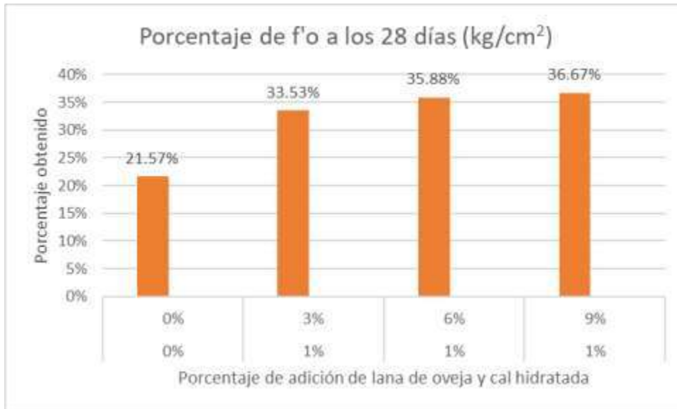
Figura 24. Gráfica de porcentaje de resistencia a compresión obtenida.
