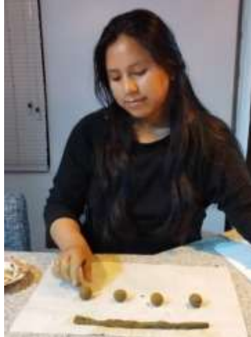
Ensayo de enrollado
