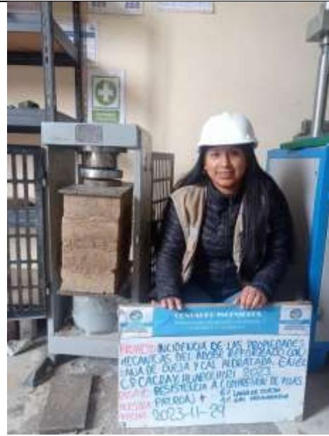
Resistencia compresión en pilas
