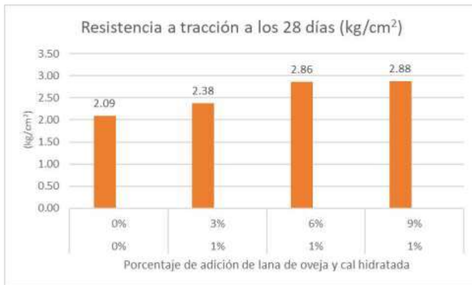
Figura 25. Gráfica de porcentaje de adiciones vs resistencia a tracción.
