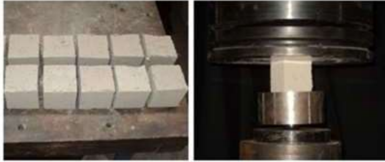
Figura 6. Prueba de la resistencia a compresión en unidad.
