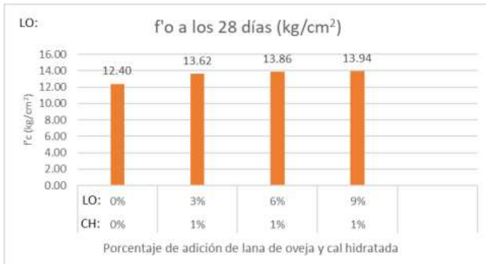
Figura 23. Gráfica de porcentaje de cal hidratada y lana de oveja vs f'o.
