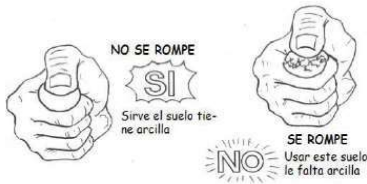
Figura 5. Prueba de la resistencia seca
