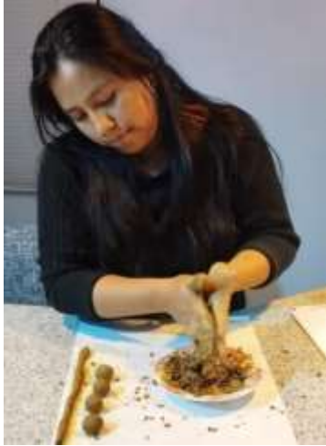
Ensayo de resistencia seca
