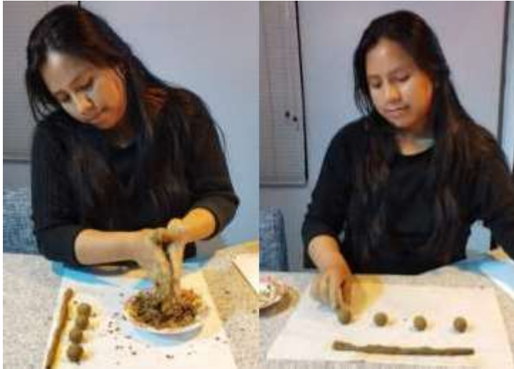
Figura 13. Ensayo de resistencia seca y enrollado.
