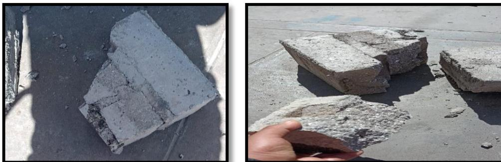
Figura 25 : Muestras de murete corte diagonal, imagen propia.
