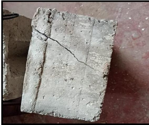
Figura 21 : Colocado y rotura de ladrillos de concreto patrón y con EPS, imagen propia
