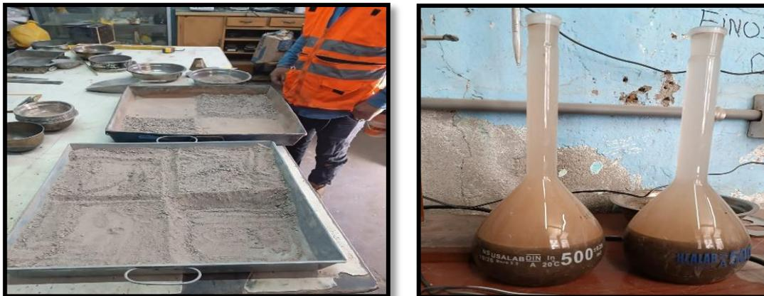
Figura 11 : Cuarteo y peso específico, imagen propia.
