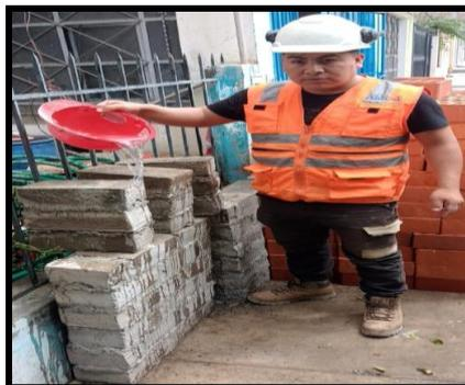
Figura 20 : *Curado de pilas y muretes, imagen propia*
