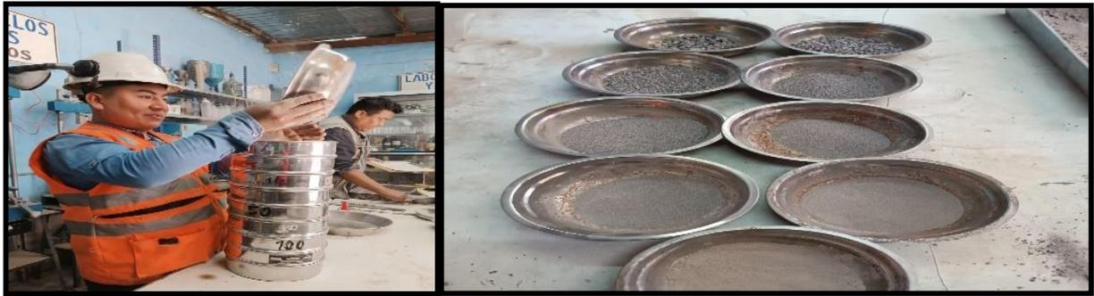
Figura 9 : Tamizado del agregado fino, imagen propia.
