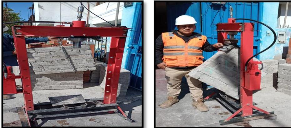
Figura 24 : Colocado de muretes al equipo de compresión, imagen propia
