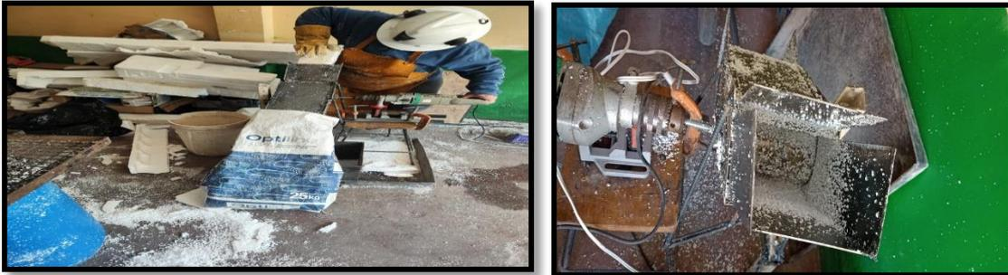
Figura 13 : *Molido de tecnopor (EPS), imagen propia*
