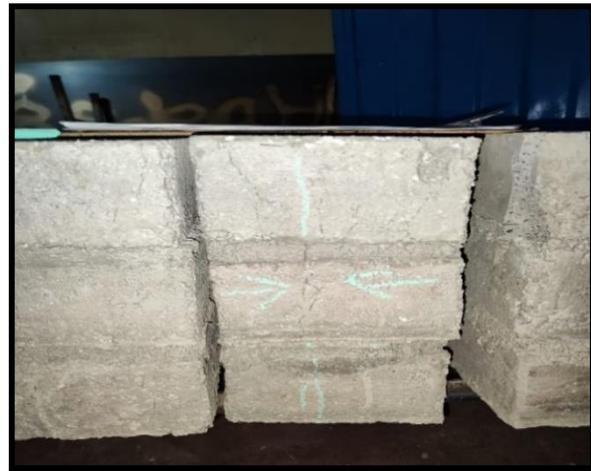
Figura 23 : Falla de las pilas después del ensayo a la compresión de pilas, imagen propia.
