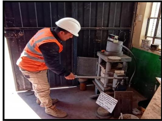
Figura 22 : Colocado de pilas en el equipo de compresión, imagen propia
