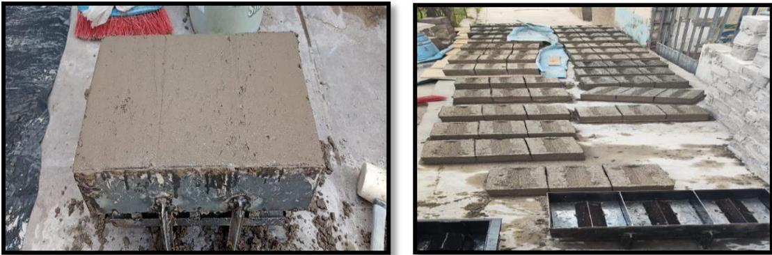
Figura 16 : *Desmoldado y secado de ladrillos de concreto, imagen propia*
