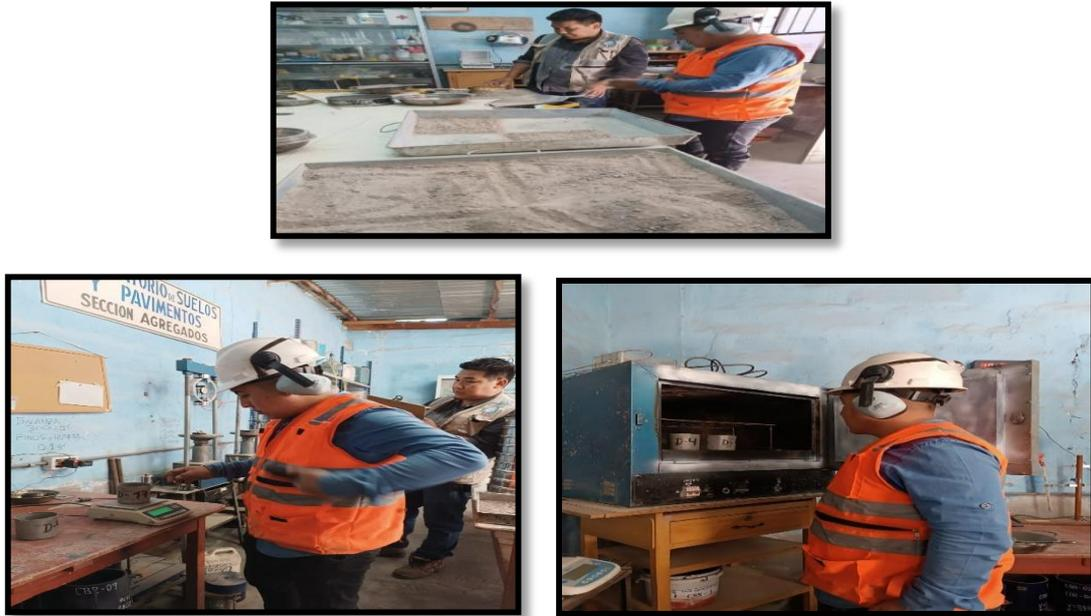
Figura 8 : *Cálculo del contenido de húmeda de la arena gruesa, imagen propia.*
