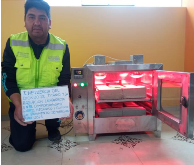
En la fotografía se observa a las muestras de adoquines de concreto sometidas a radiación infrarroja para su curado controlado y no padecer las altas heladas
