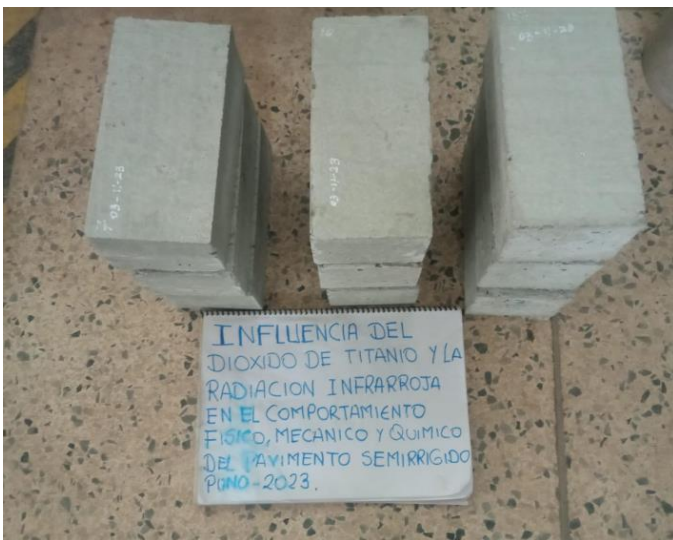
En la fotografía se puede apreciar las muestras de adoquines las cuales serán sometidas a pruebas de resistencia a la compresión
