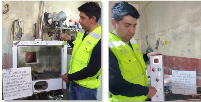
Imagen 11. Proceso de construcción del horno de rayo infrarrojo
