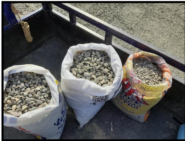
Figura 6. Agregado reciclado producto de la trituración en la chancadora de quijada, Ferreñafe, Evidencia fotográfica, 2022
