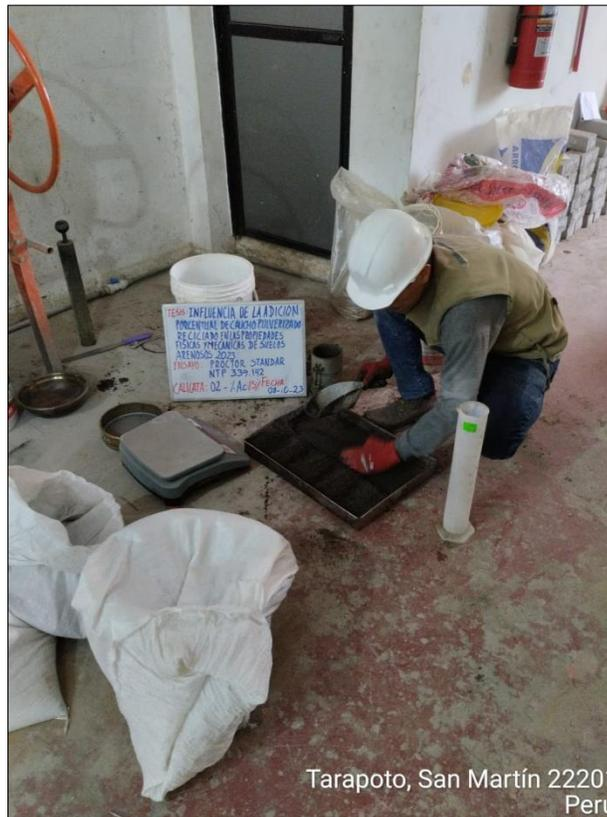
Fotografía 5: Ensayo de CBR
