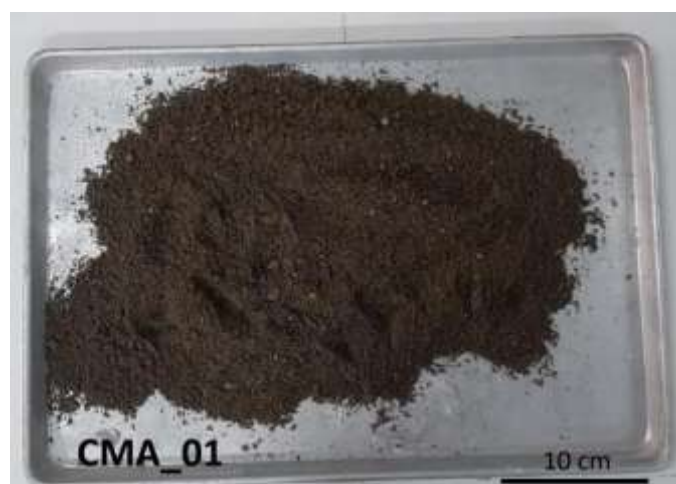
Figura 2: Muestra analizada corresponde a agregado de granulometría de medio a fino,
