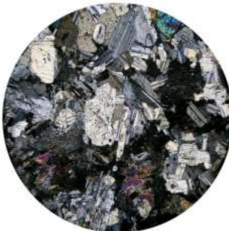
Figura 5: Muestra en escala microscópica de la presencia de granodiorita.
