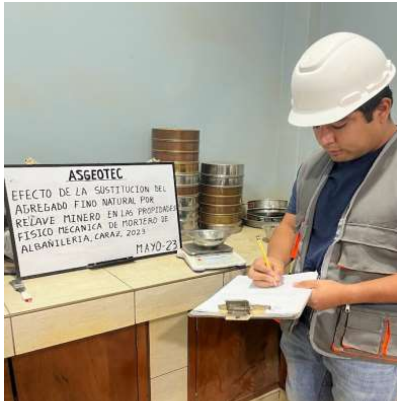
03. Se visualiza el pesado de los materiales previo al diseño de mezcla.
