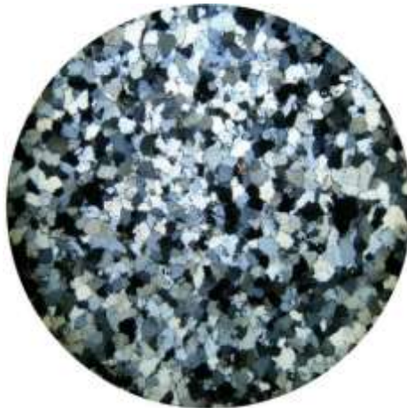
Figura 4: Muestra en escala microscópica de la presencia de cuarcita.
