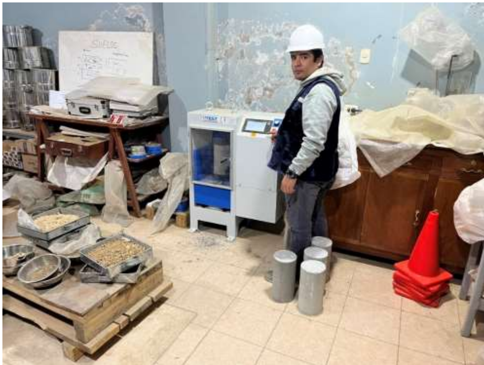
08. Se visualiza la rotura de los testigos.
