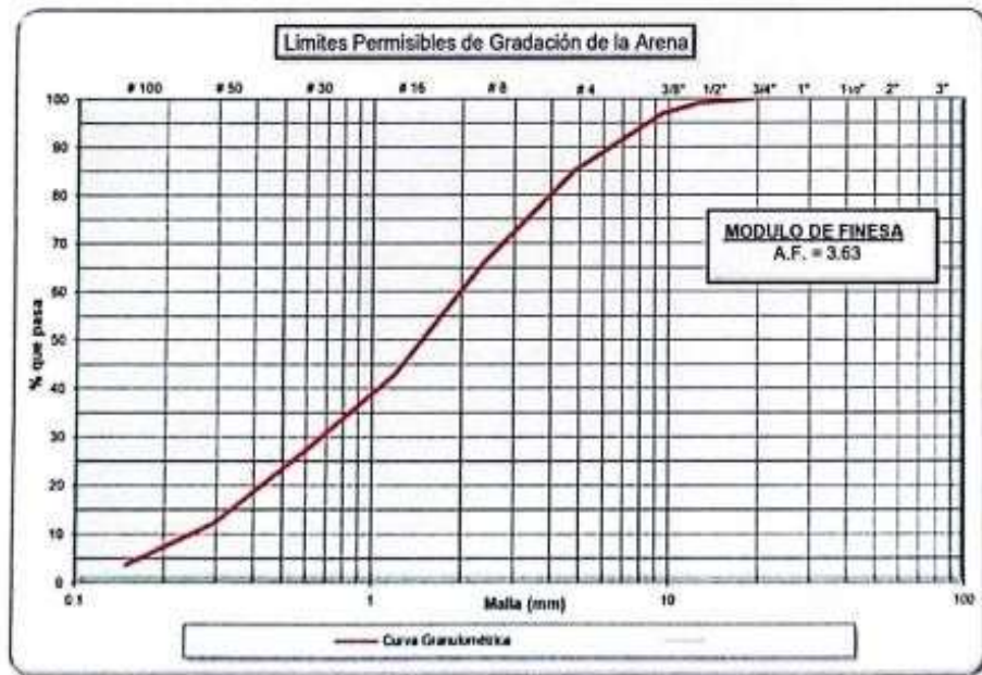
Figura 1: Análisis granulométrico del Agregado Fino
