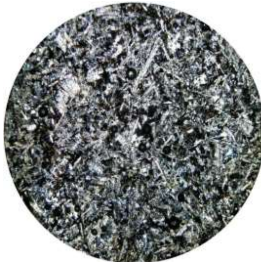
Figura 7: Muestra en escala microscópica de la presencia de andesita.
