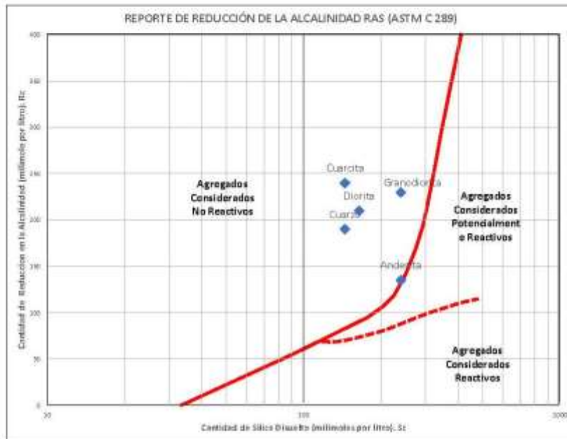
Figura No.07. Valores ploteados en el gráfico de Mielenz. (Incluye la división entre agregados Reactivos y No reactivos).
