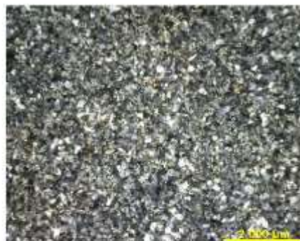
Figura Nro.03. Distribución de fragmentos de componentes minerales de tendencia equigranular ( \phi=150\mu\text{m} ).
