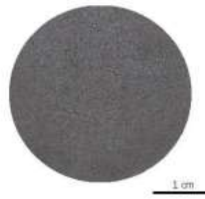
Figura Nro.02. La muestra pulverizada a malla Nro. 200
