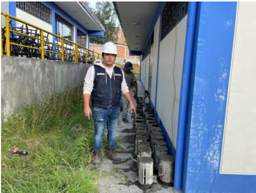
06. Se visualiza del muestreo del mortero en las probetas.
