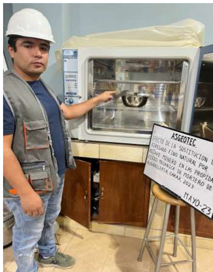
04. Se visualiza el secado pesado de los materiales previo al diseño de mezcla.
