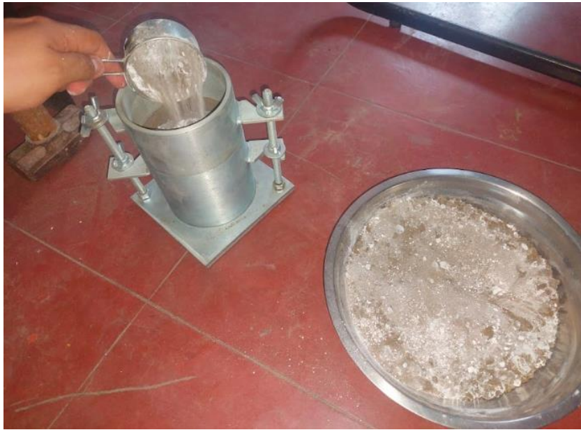
Ensayo de compactación de Próctor Modificado Suelo Natural +8%Cal C1
