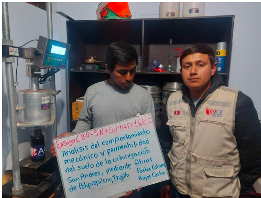
Ensayo de CBR Suelo Natural +4%Cal + 1.6 % FDP Calicata 2
