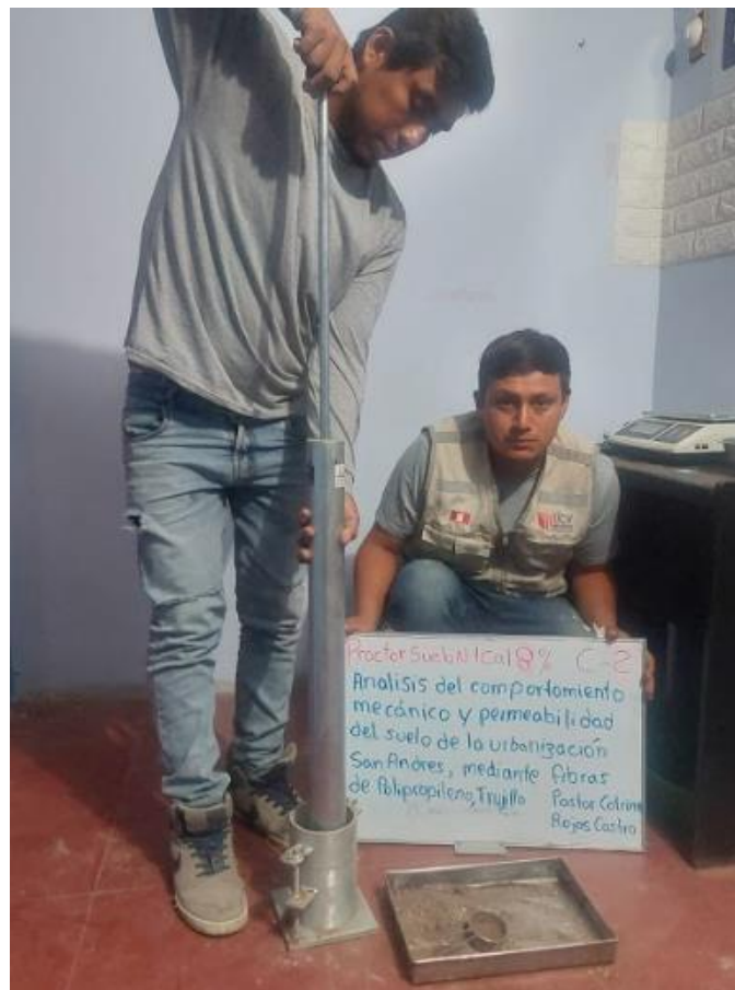
Ensayo de compactación de Próctor Modificado Suelo Natural +8%Cal C2
