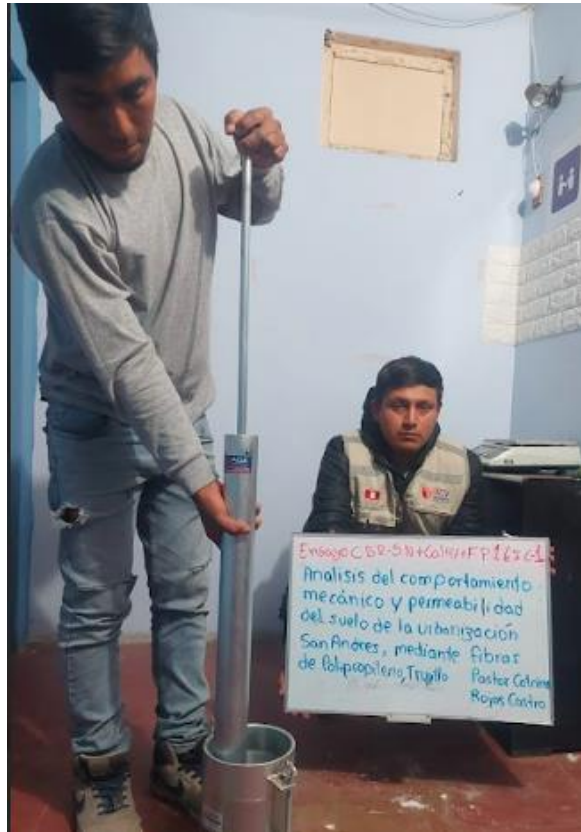
Ensayo de CBR Suelo Natural +4%Cal + 1.6 % FDP Calicata 1
