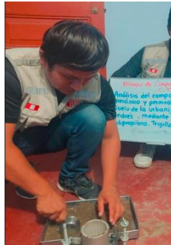
Ensayo de UCS Suelo Natural +4%Cal + 0.8 FDP Calicata 1
