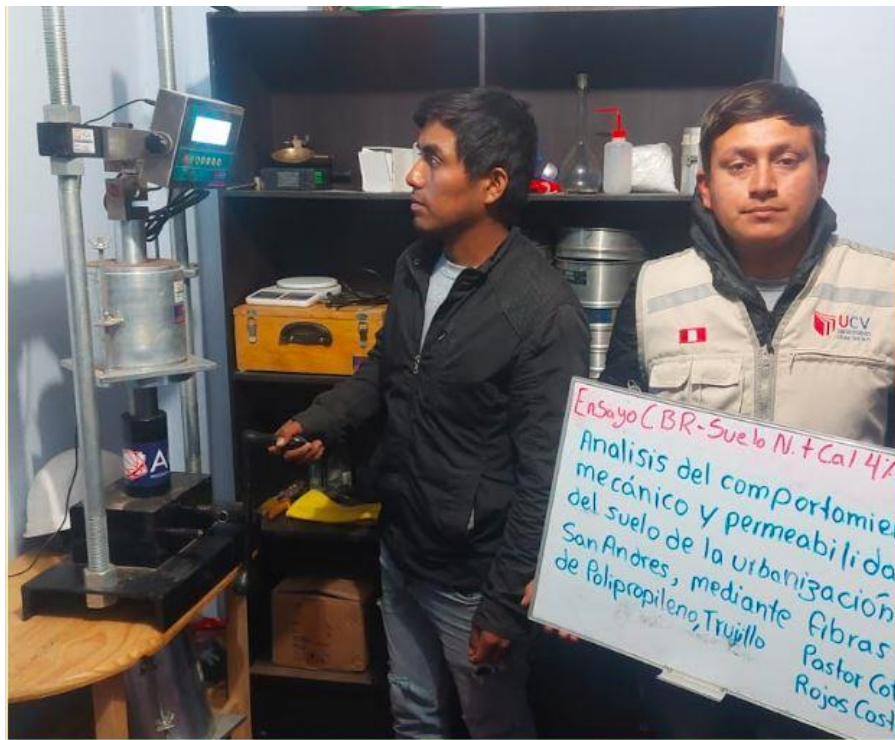
Ensayo de CBR Suelo Natural + 4% Cal C3
