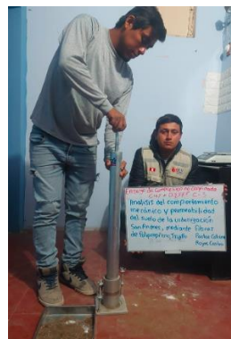
Ensayo de UCS Suelo Natural +4%Cal + 0.8 FDP Calicata 3
