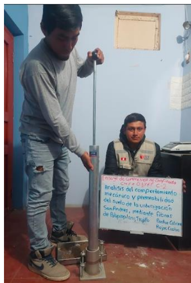
Ensayo de UCS Suelo Natural +4%Cal + 0.8 FDP Calicata 3
