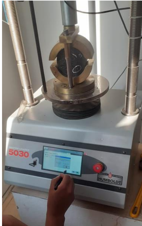
Figura 2. Ensayo Marshall, estabilidad y flujo Fuente: Flores y Orosco, 2020
