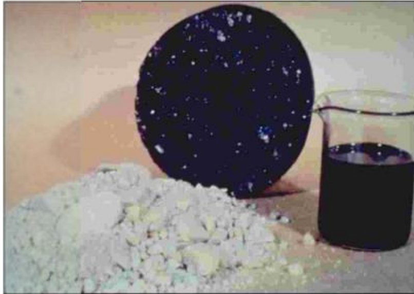
Figura 1. Cemento asfáltico y briqueta de mezcla asfáltica
