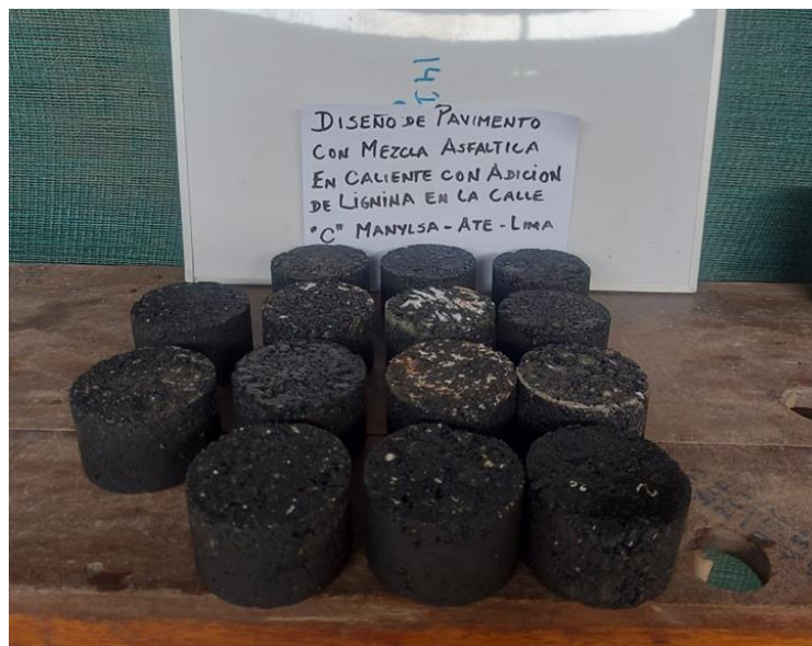
Figura 7. Briquetas de la mezcla asfáltica convencional
