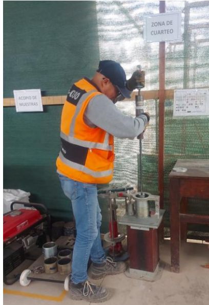
Figura 8. Proceso de compactación de la mezcla asfáltica
