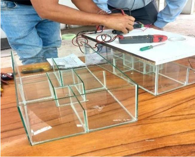
Elaboración del recipiente con medidas de 60 cm de largo y 40 cm de ancho y 17 cm de altura con cuatro divisiones para la muestra base y 3 repeticiones.
