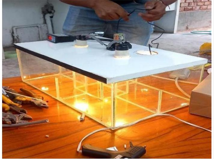
Instalación del termostato y focos para mantener las temperaturas de 20°C, 25°C y 30°C.
