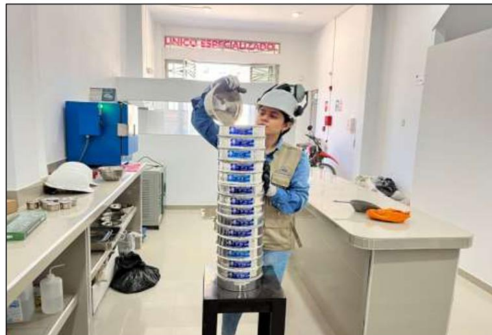
Imagen 6: Ensayo de análisis granulométrico de agregado fino.
