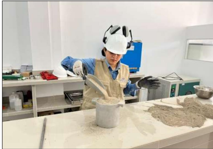
Imagen 5: Ensayo de peso unitario suelto y compactado de agregado fino.
