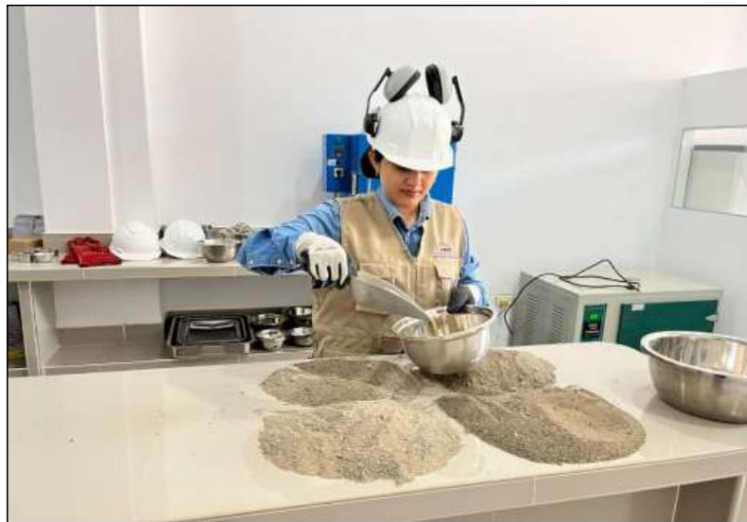
Imagen 4: Selección para el ensayo de contenido de humedad.
