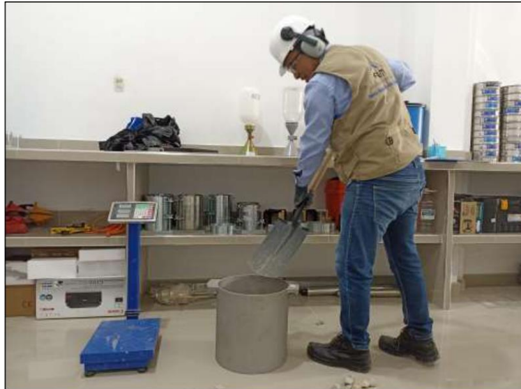
Imagen 3: Ensayo de peso unitario de agregado grueso.
