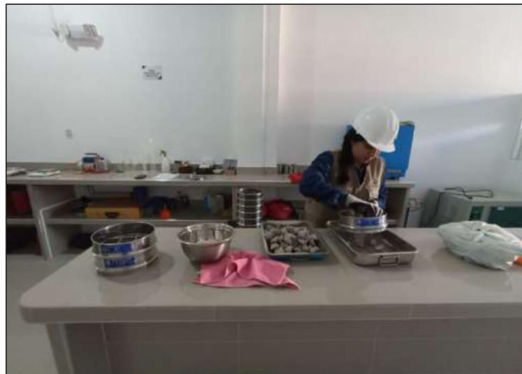
Imagen 2: Análisis granulométrico del agregado grueso
